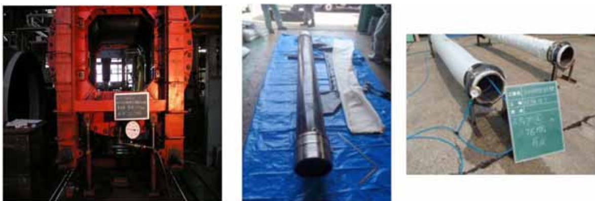
第 10 図 止水ゴム等の耐圧試験例
