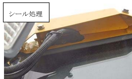
第1図 可搬型設備 小動物対策例 (2/2)
