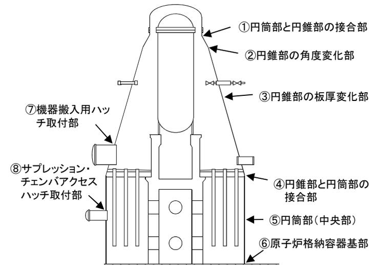
原子炉格納容器の応力評価対象部位
