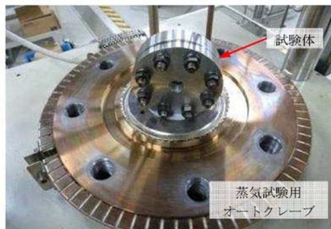
第4図 蒸気曝露試験体設置状況
