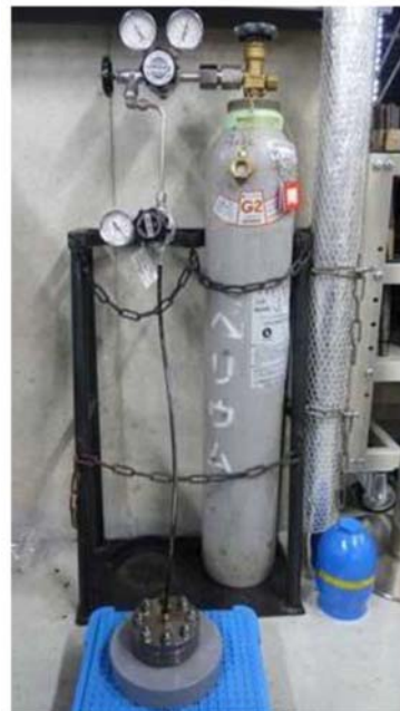
第13図 He気密確認試験状況
