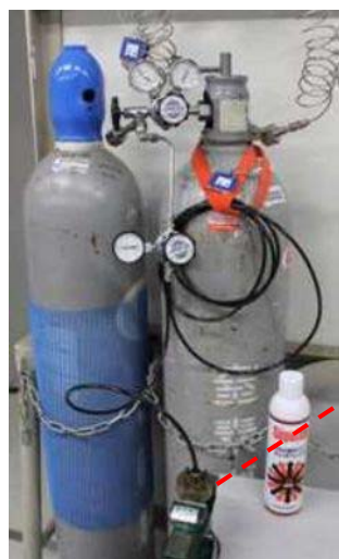
第5図 気密確認試験状況
