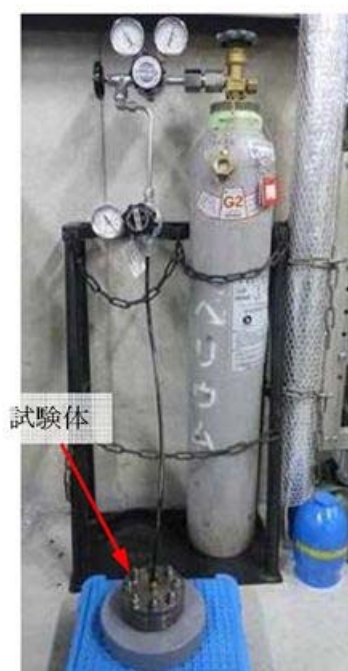
第5図 He 気密確認試験状況
