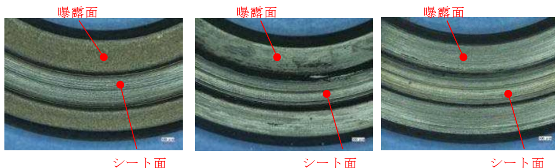
第7図 試験後外観観察結果 (a: 乾熱 200℃, 168 時間, b, c: 蒸気 250℃, 168 時間)
