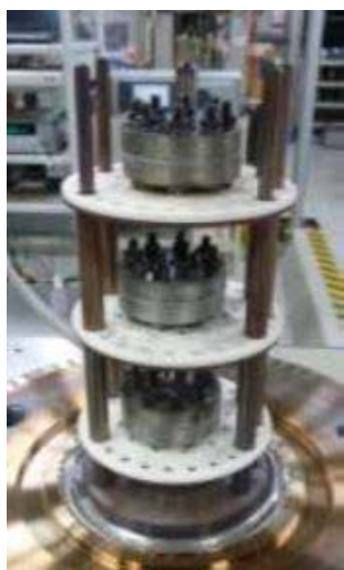
第4図 蒸気曝露 試験片設置状況
