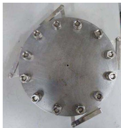
第8図 変位付与状況 隙間ゲージを用いて所定の変位を加えた後， 隙間ゲージを抜いて再締め付け
