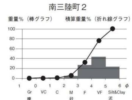
千葉県一宮町(左)と宮城県南三陸町(右)における東北地方太平洋沖地震津波の津波堆積物の粒度分布曲線(青野(2012))
