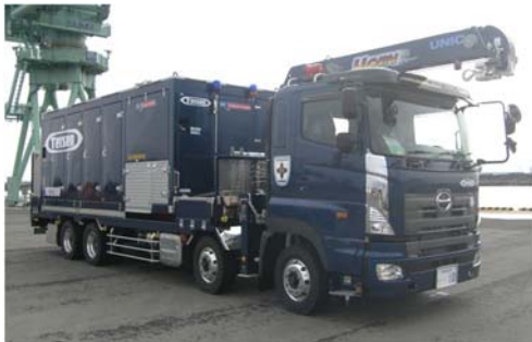
可搬型代替注水大型ポンプ
