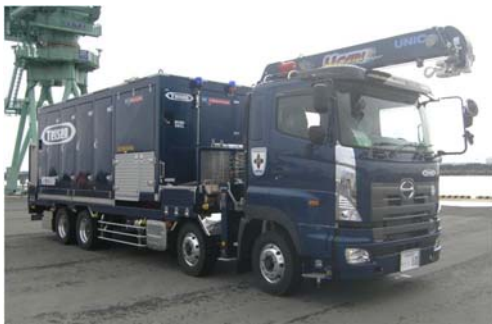
可搬型代替注水大型ポンプ
