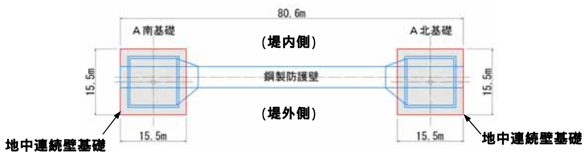
第 1-22 図 鋼製防護壁 平面図
