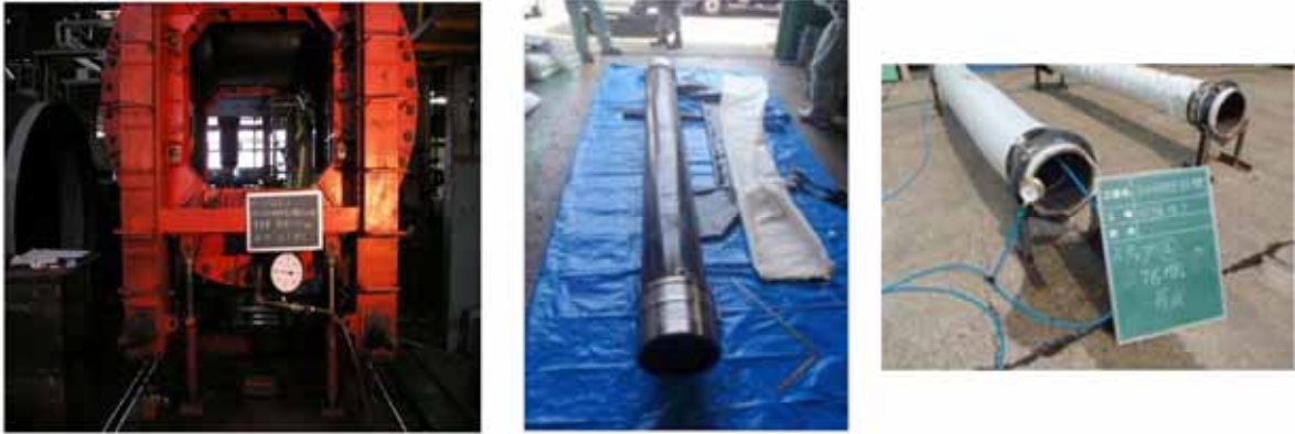
第 24 図 止水ゴム等の耐圧試験例
