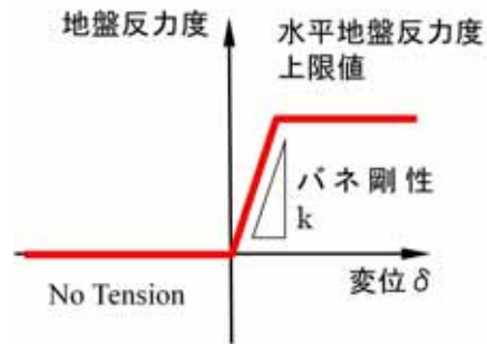
第 14 図 F E M 解析に与える地盤バネの特性
