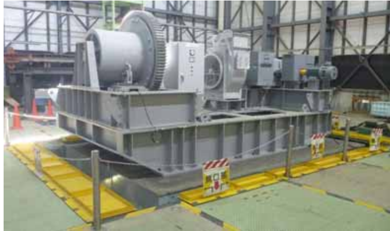
第8図 開閉装置の試験装置（全景）
