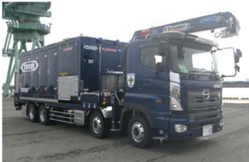
可搬型代替注水大型ポンプ
