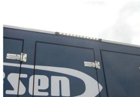
車両の作業用照明
