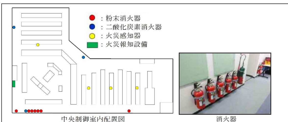
第 2.3-2 図 中央制御室の火災防護措置
