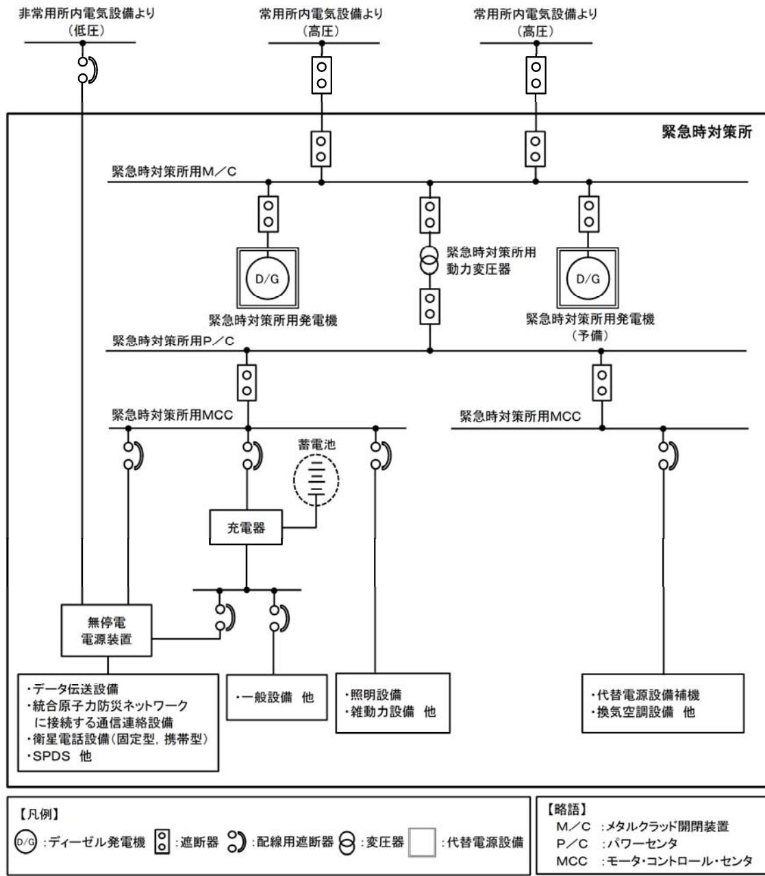
第 2.2.2-2 図 照明電源系統図（緊急時対策所）(2/2)
