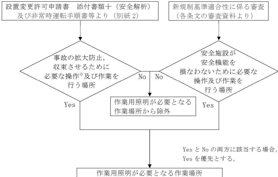
第 2.2.1-1 図 作業用照明が必要となる作業場所の抽出フロー
