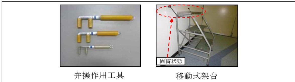
第 2.4.2-6 図 弁操作用工具及び移動式架台（例）
