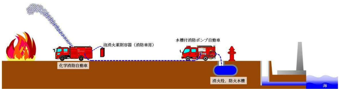
第1.12-8図 初期対応における延焼防止処置概要図
