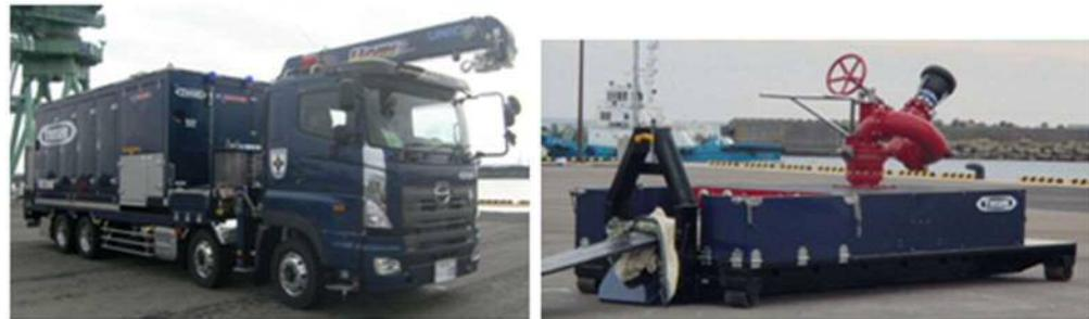
図4 可搬型代替注水大型ポンプ（放水用）、放水砲
