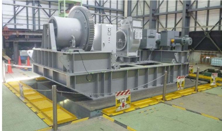
第8図 開閉装置の試験装置（全景）
