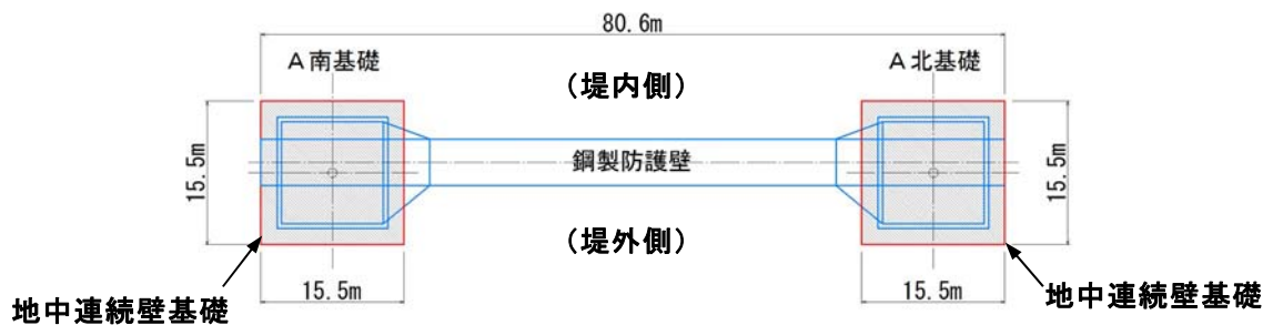
第 1-22 図 鋼製防護壁 平面図
