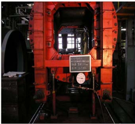
第 24 図 止水ゴム等の耐圧試験例
