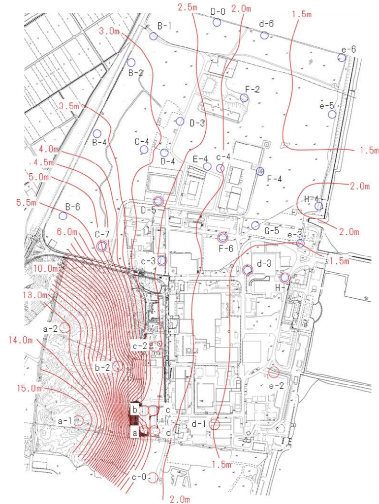
観測最高地下水水位コンター図 (T.P.+m)
