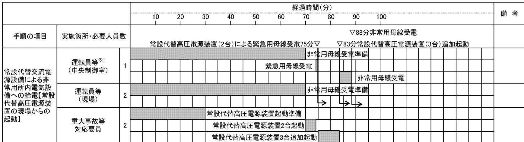
※1:原子炉運転停止中の当直要員の体制における常設代替交流電源設備による非常用所内電気設備への給電は88分以内と想定する。
