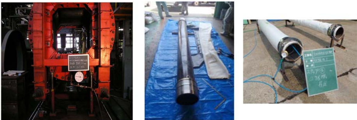
第 13 図 止水ゴム等の耐圧試験例
