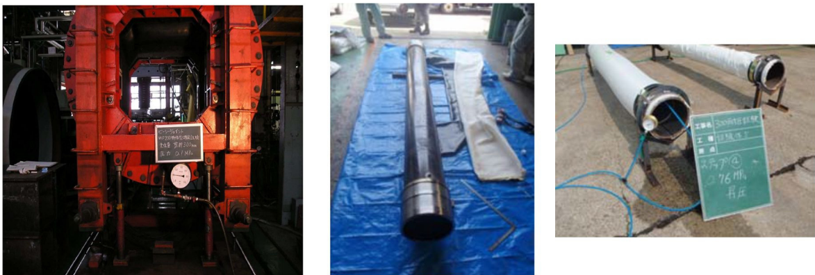
第 13 図 止水ゴム等の耐圧試験例
