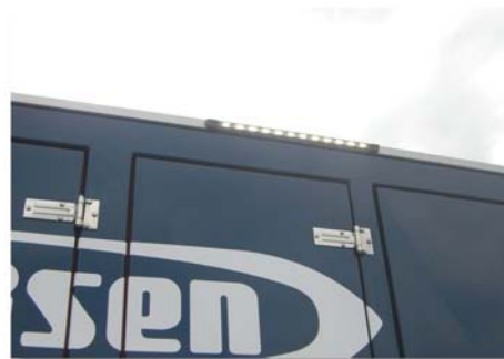
車両の作業用照明
