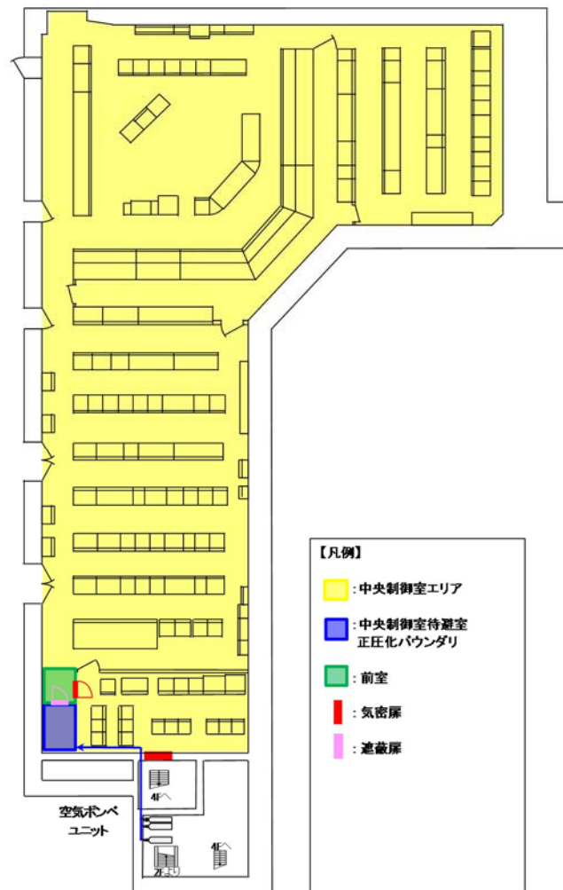
第 5.1.3-3 図 待避室の概要図及び設置場所
