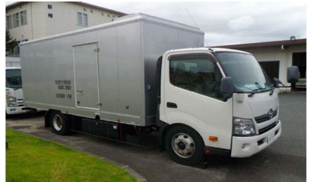
可搬型代替低圧電源車
