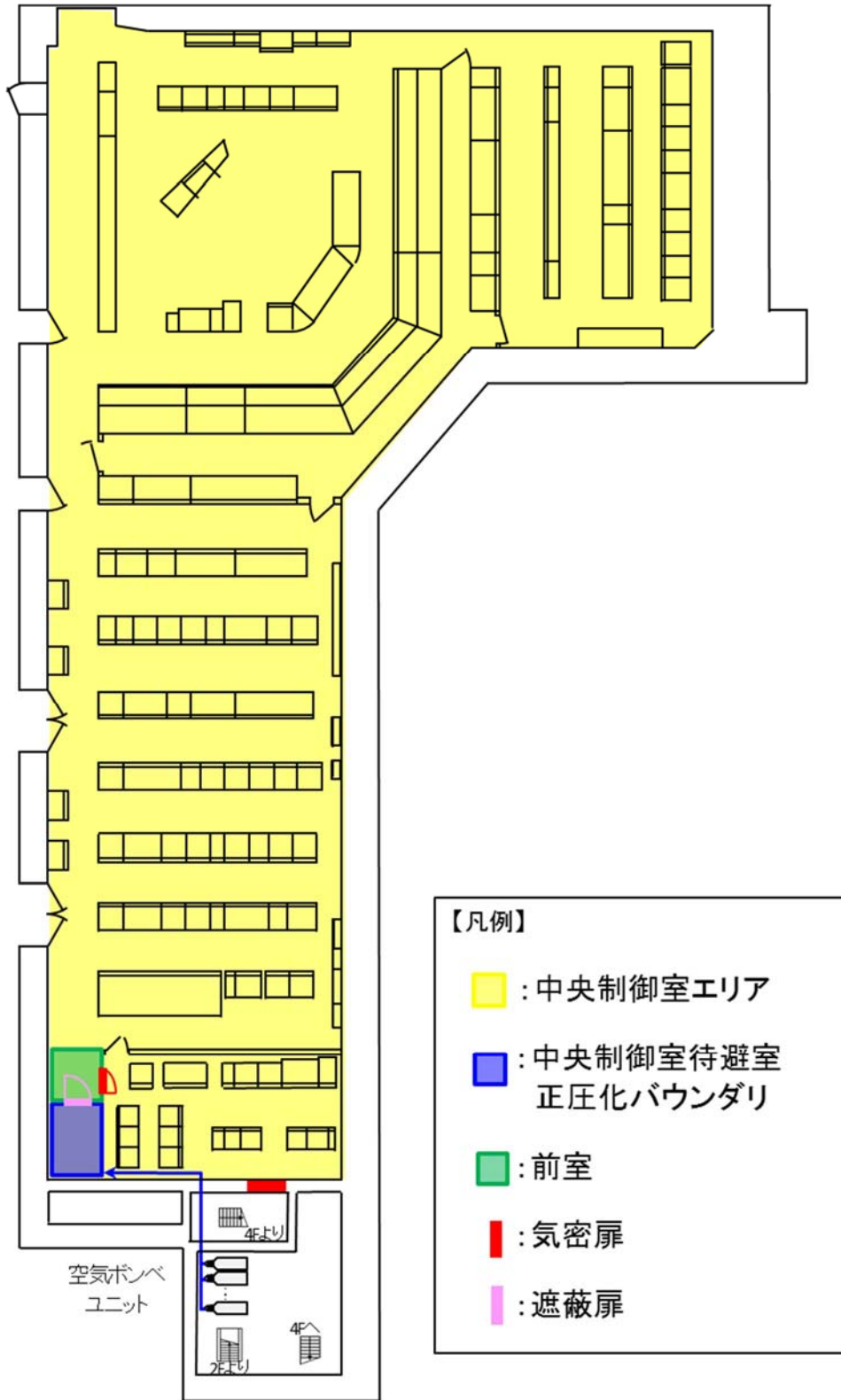
第59-3-5図 中央制御室待避室ポンベユニット（空気ポンベ）配置図 （原子炉建屋付属棟3階）
