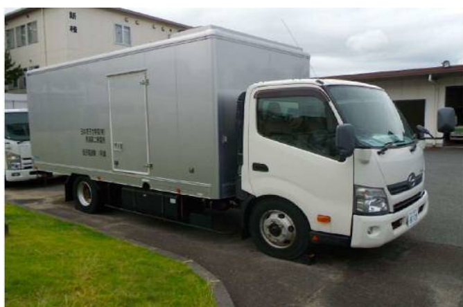
可搬型代替交流電源設備
