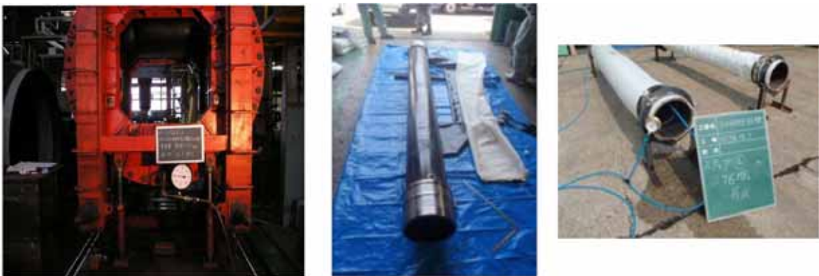
第 13 図 止水ゴム等の耐圧試験例
