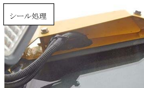
第1図 可搬型設備 小動物対策例 (2/2)
