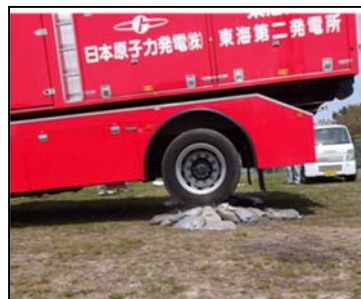
第 1 図 乗越え検証試験状況 (2/2)
