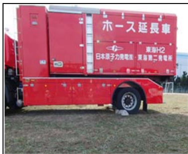
第 1 図 乗越え検証試験状況 (2/2)
