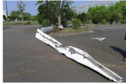
飛散した飛来物（鋼板製屋根材）
