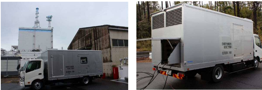
可搬型代替低圧電源車
