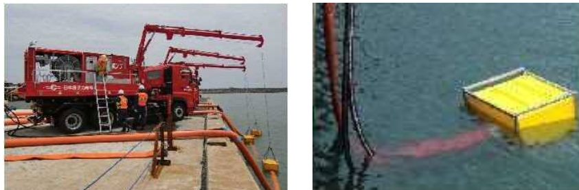
可搬型代替大型ポンプ
