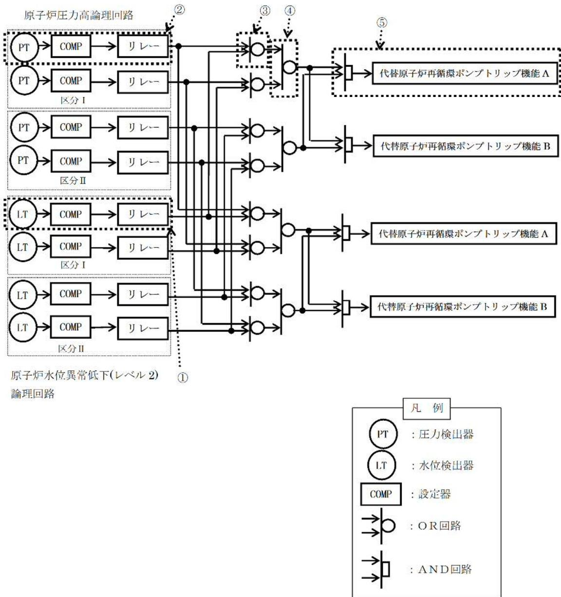
第1図 誤動作率評価モデル (その1)
