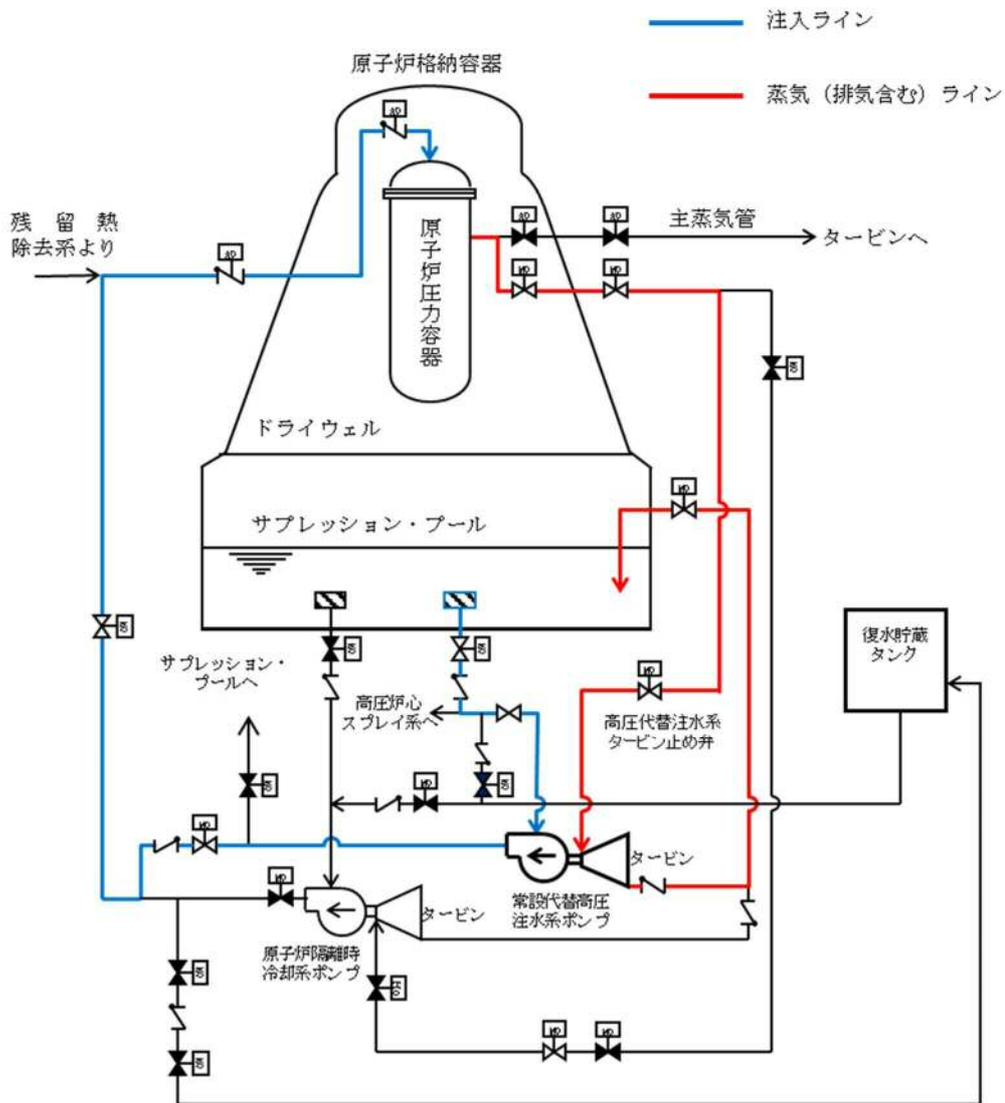
第 45-4-1 図 高圧代替注水系 系統概要図
