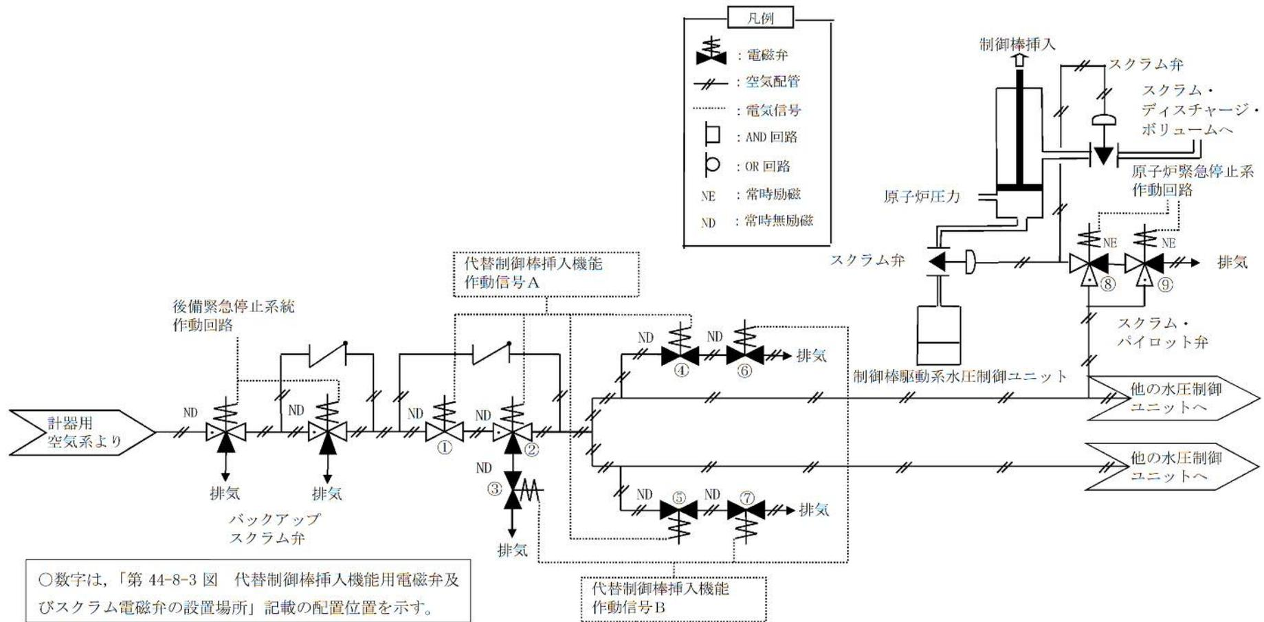
第 44-8-2 図 代替制御棒挿入機能用電磁弁及びスクラム電磁弁の分離について
