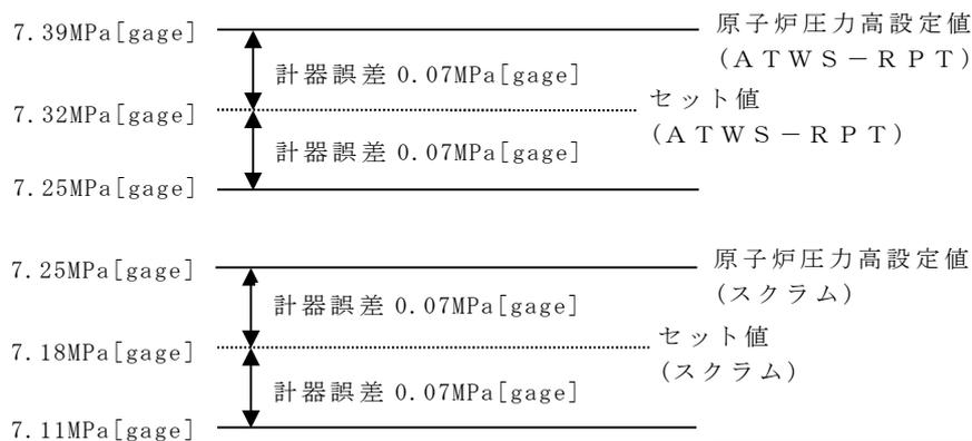
A T W S - R P T : 代替再循環ポンプトリップ機能
