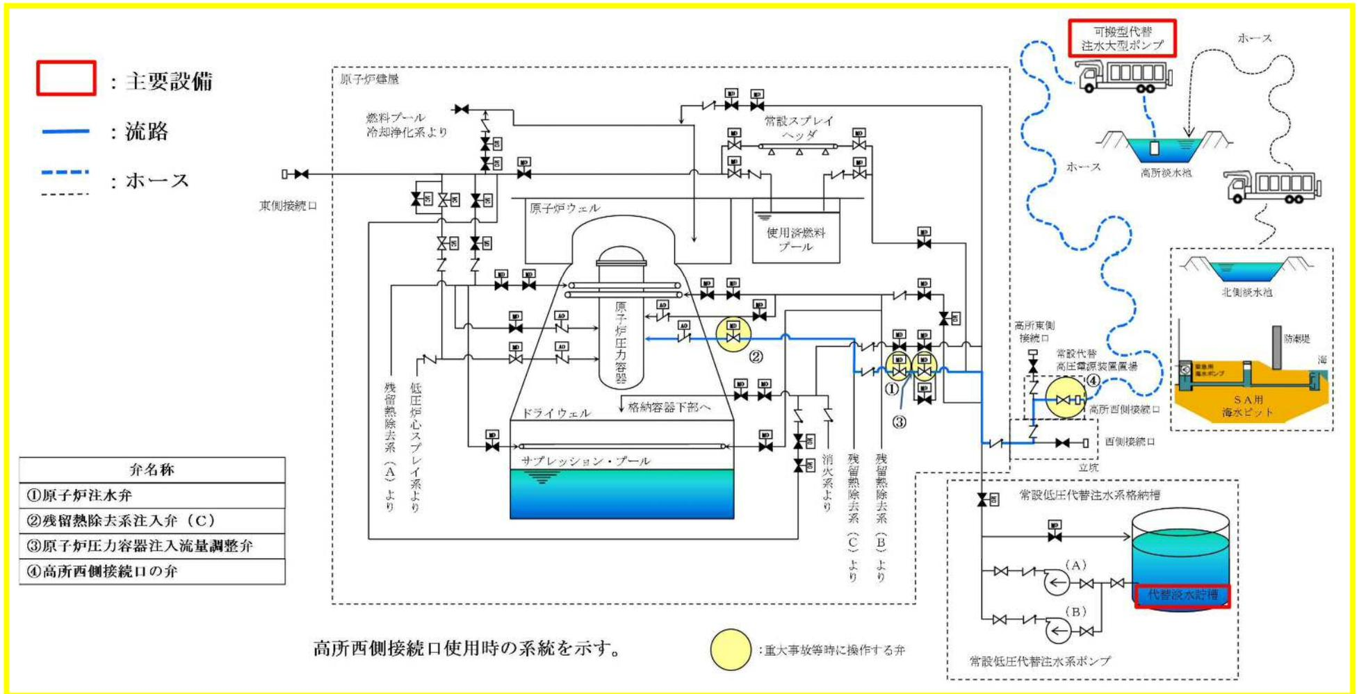
第 47-4-5 図 低圧代替注水系（可搬型）系統概要図（高所西側接続口使用時
