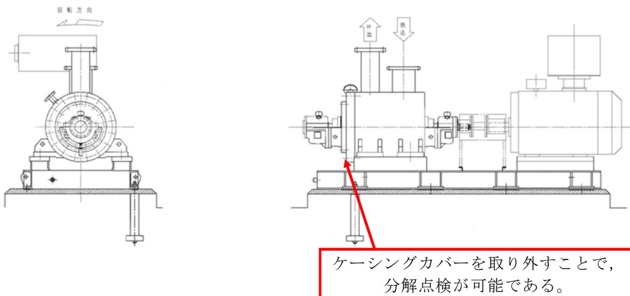
第 47-5-1 図 常設低圧代替注水系ポンプ構造図
