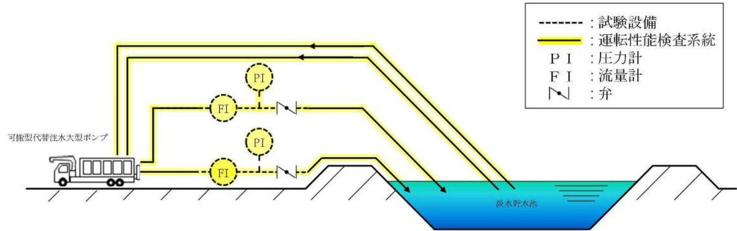
図は可搬型代替注水大型ポンプ運転性能検査系統を示す。運転性能検査時は、可搬型代替注水大型ポンプを淡水貯水池近傍に設置し、ホース及び試験設備を仮設し、淡水貯水池の水を再循環させる系統で運転性能検査を行う。
