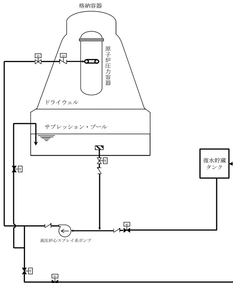
第 45-7-5 図 高圧炉心スプレイ系設備概要
