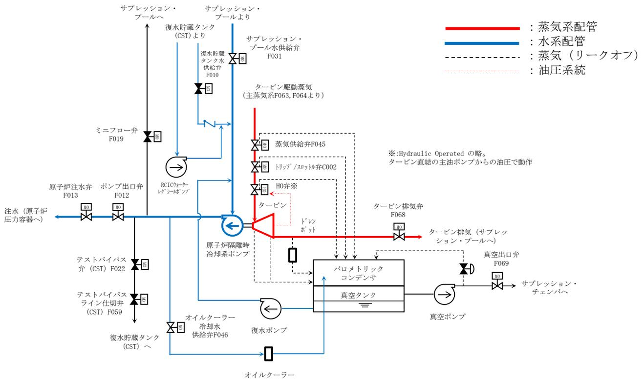
第 45-4-2 図 原子炉隔離時冷却系 補機系統概要図
