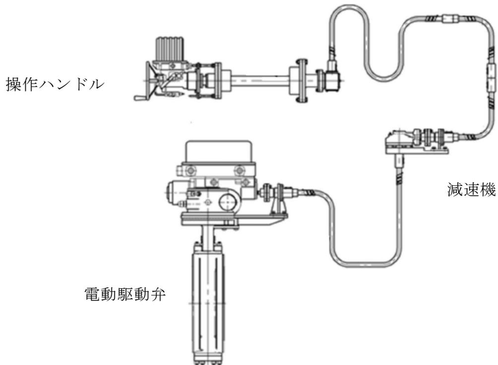
第 48-6-3 図 遠隔人力操作機構外形図
