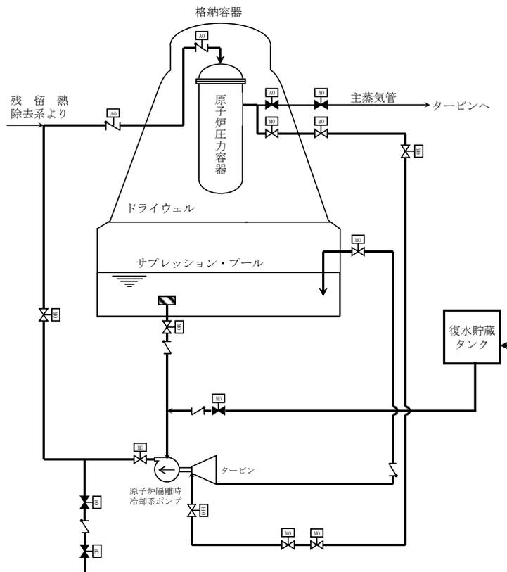
第 45-7-4 図 原子炉隔離時冷却系設備概要
