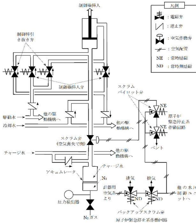
第44-7-4図 原子炉緊急停止系及び制御棒駆動系水圧制御ユニット
