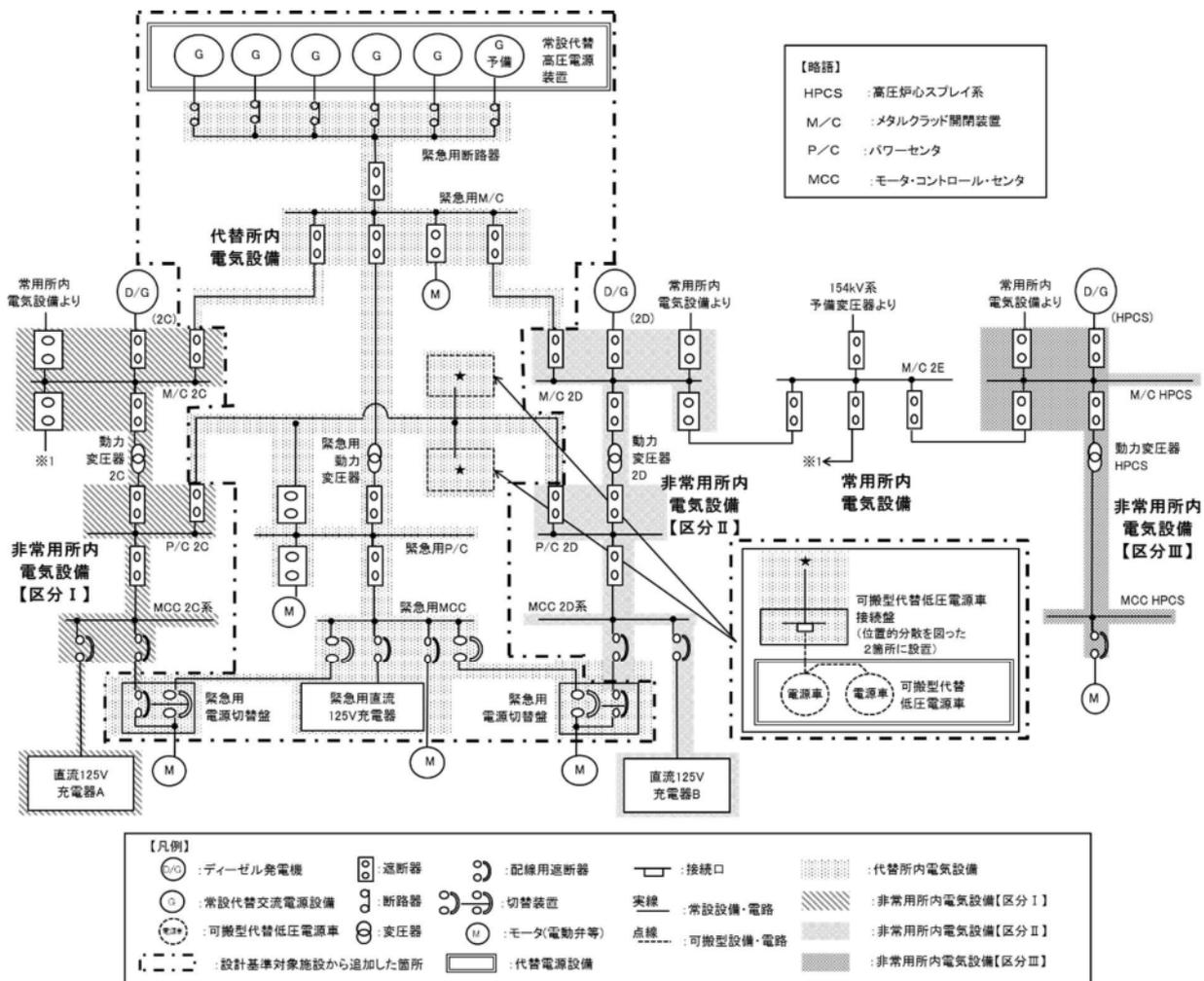
第 48-2-1 図 電源構成図 (交流電源) (1/2)
