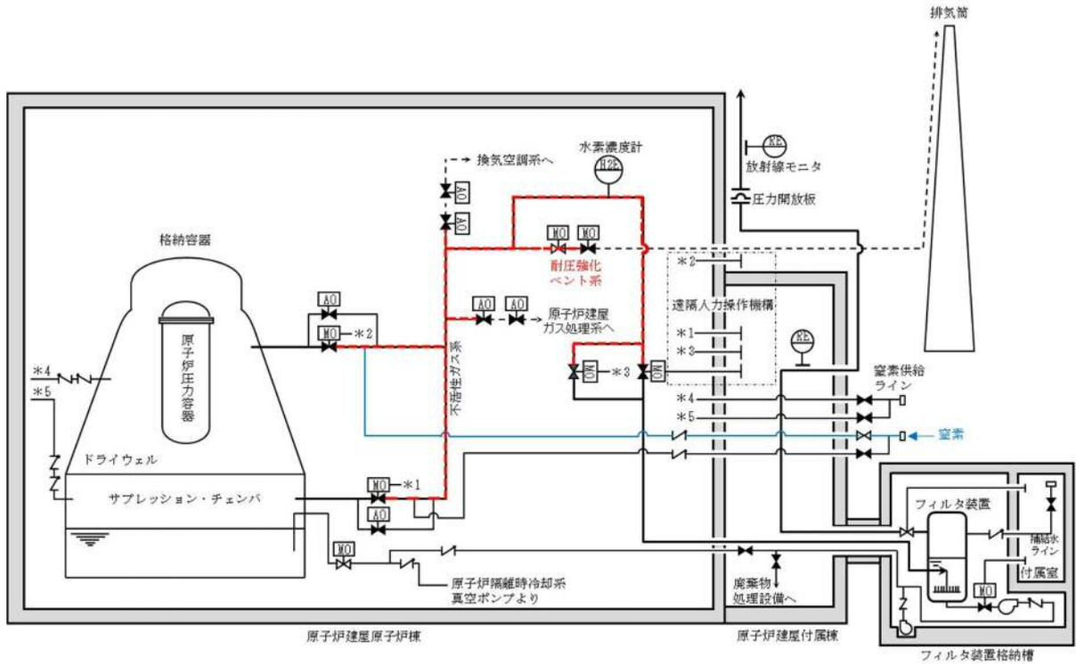
第 48-6-1 図 耐圧強化ベント系機能・性能検査系統図
