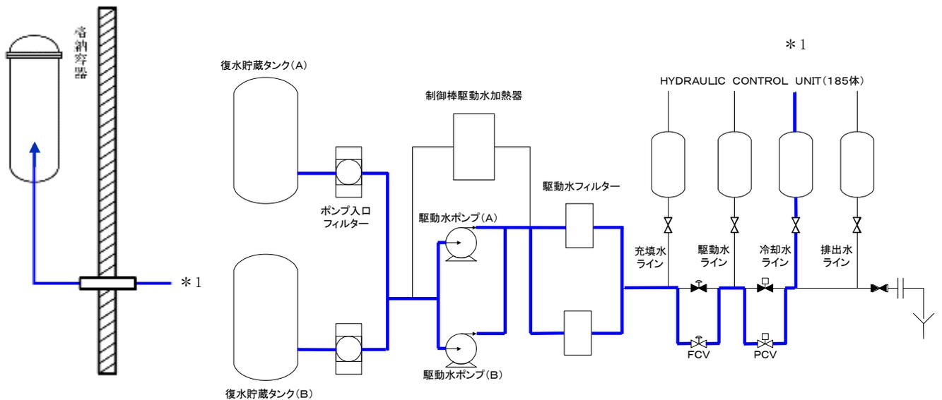
第 45-7-7 図 制御棒駆動系ポンプ設備概要 (原子炉注水時)
