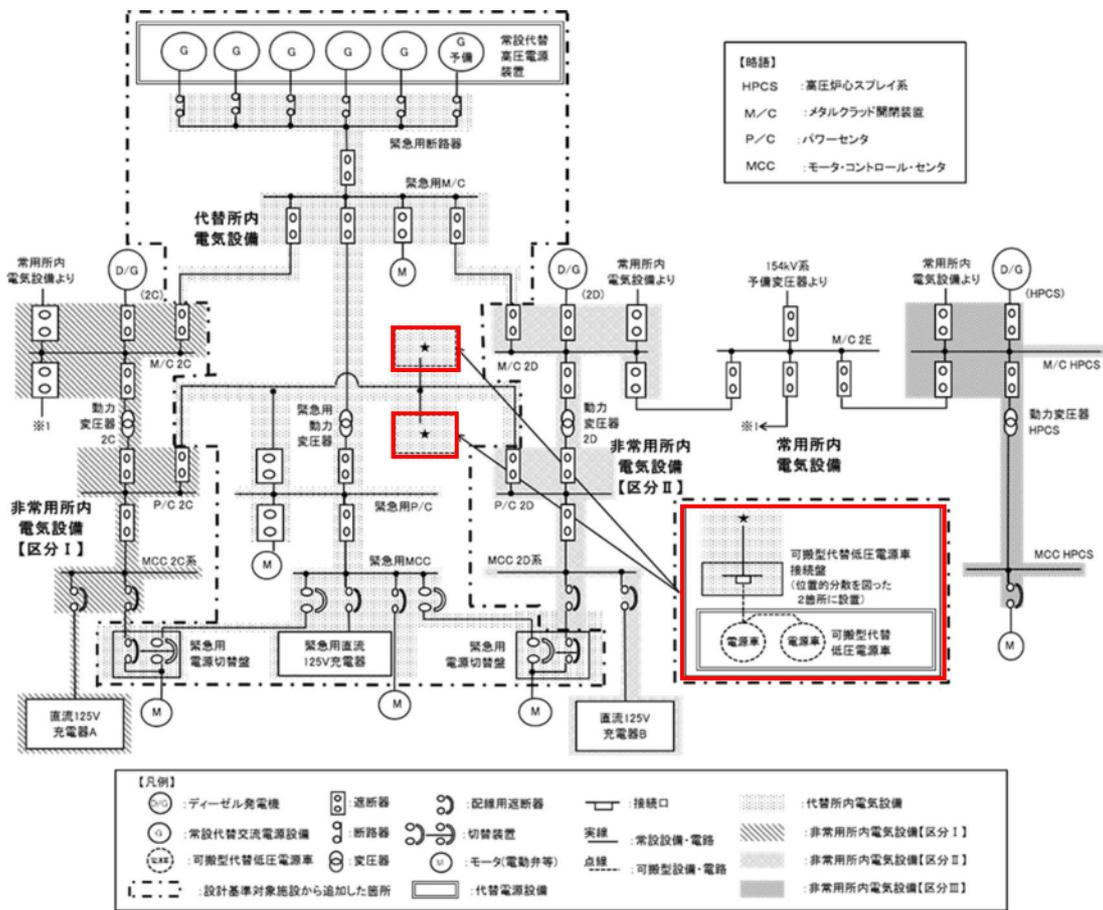
第 45-7-7 図 可搬型代替交流電源設備による充電器の充電
