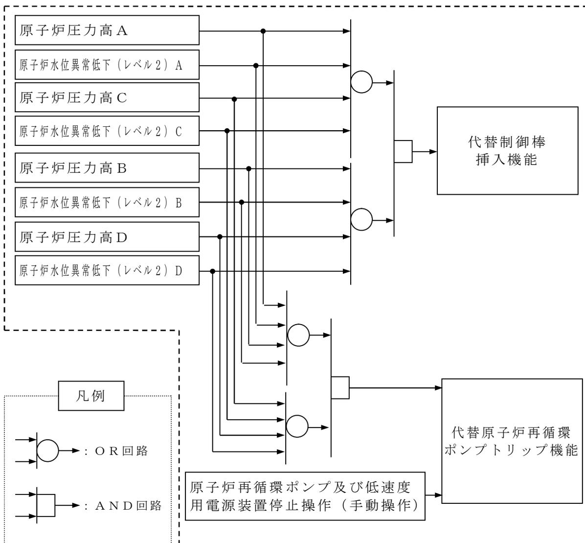
第44-8-1図 原子炉緊急停止系及びA T W S 緩和設備論理回路図
