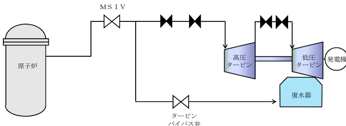
第 46-10-1 図 タービン制御系 概要図
