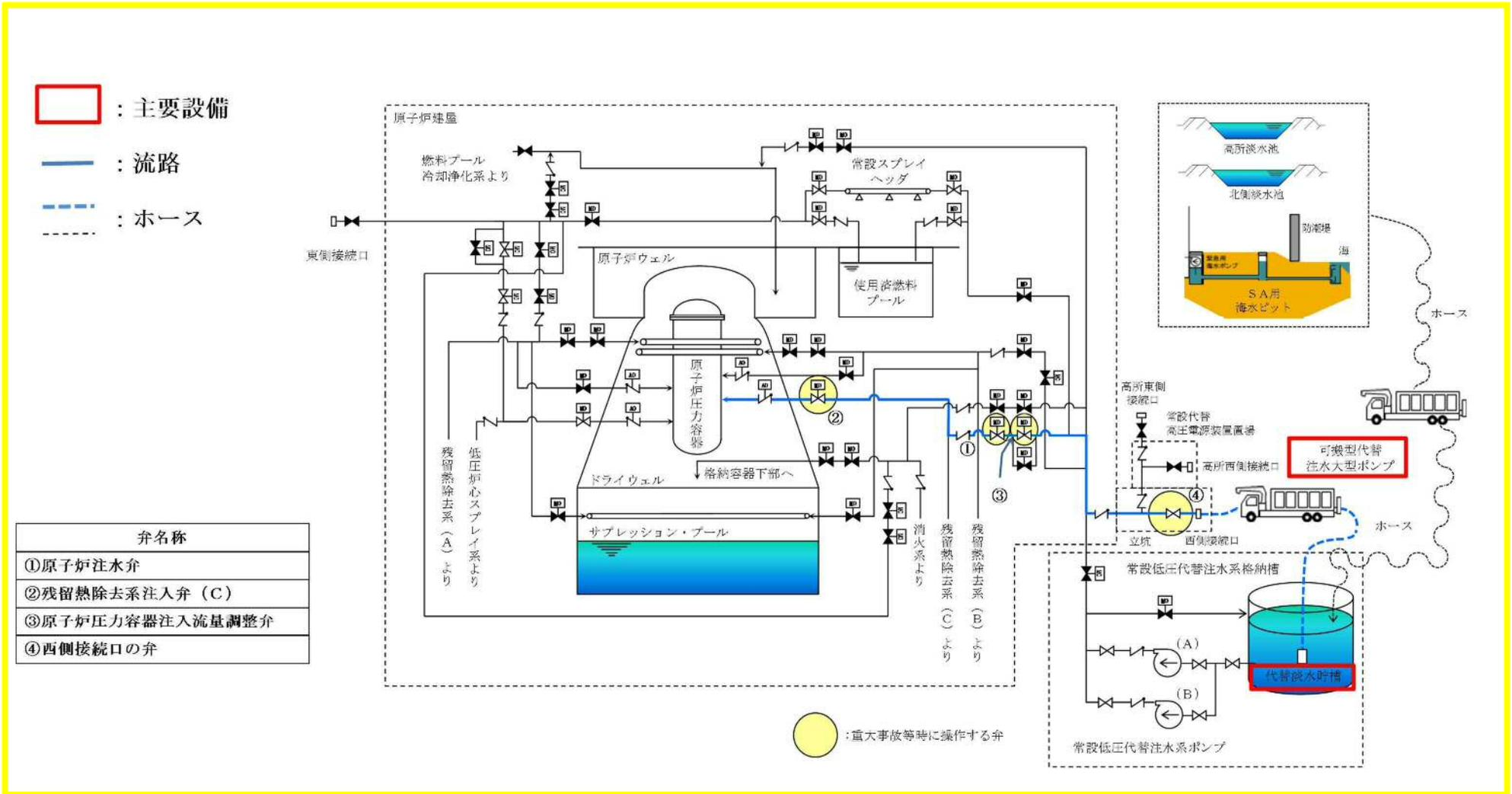
第 47-4-3 図 低圧代替注水系（可搬型）系統概要図（西側接続口使用時）
