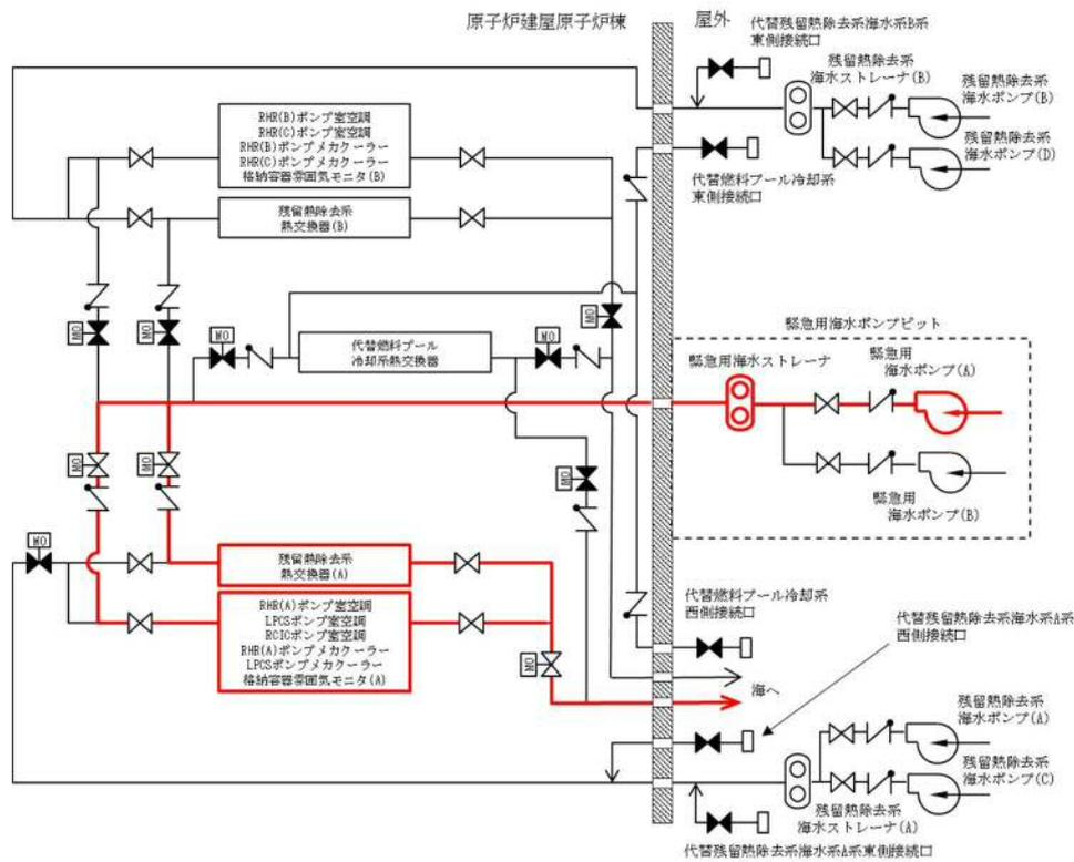
第 48-6-4 図 緊急用海水系運転性能検査系統図
