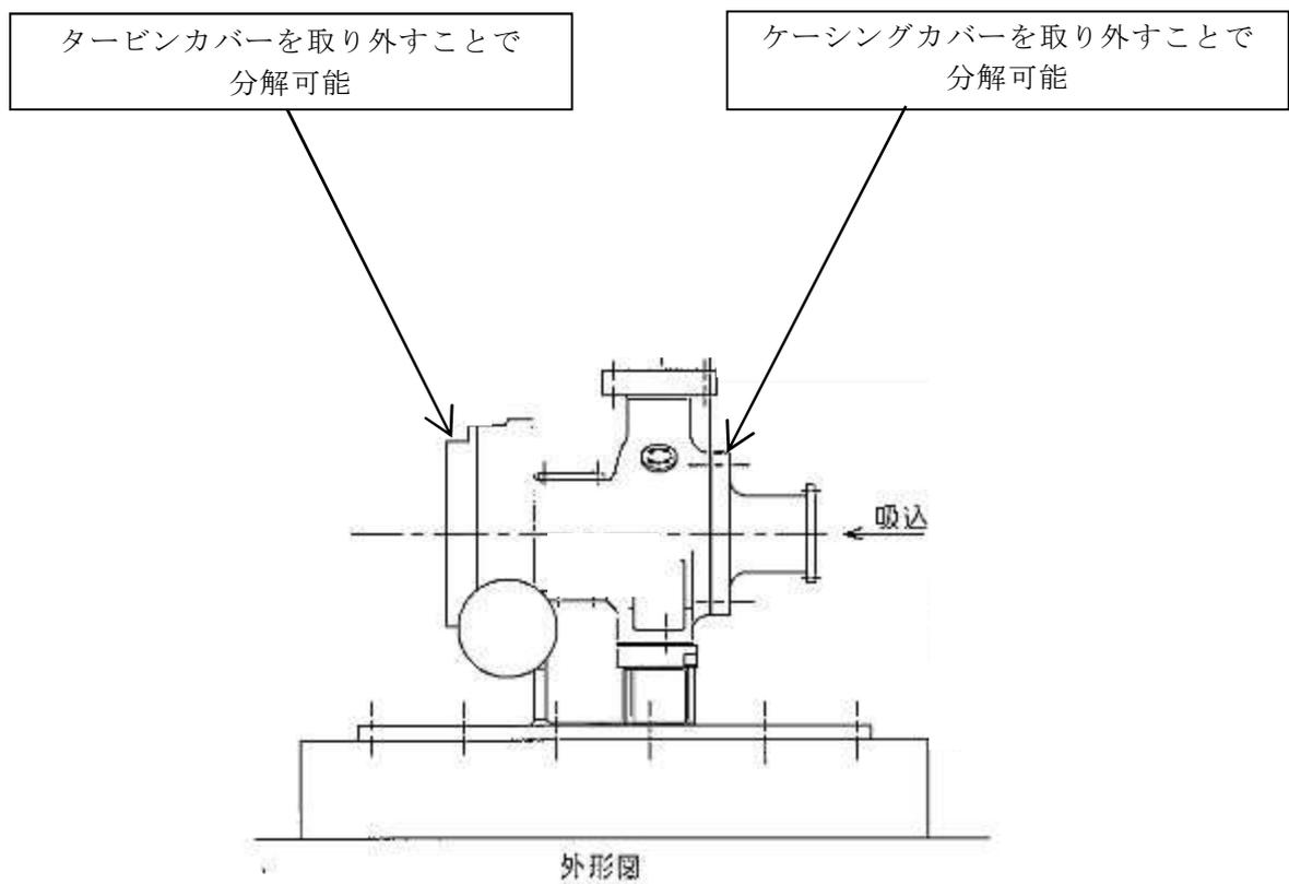
第 45-5-2 図 常設高圧代替注水系ポンプ外形図
