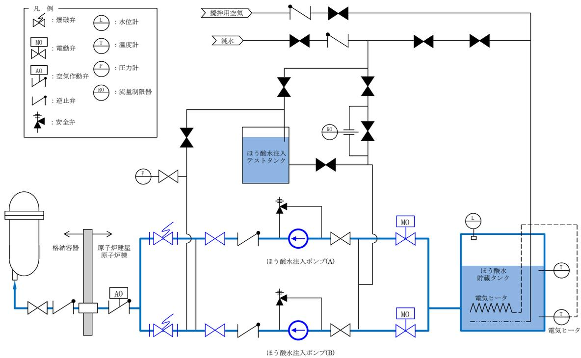
第 45-4-3 図 ほう酸水注入系 系統概要図
