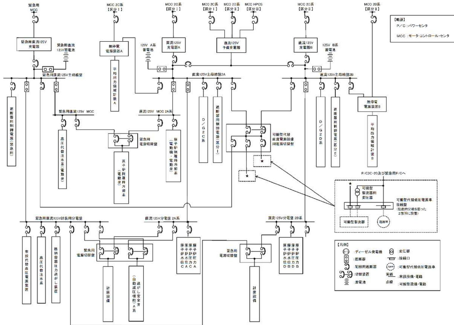
第 44-2-1 図 直流電源単線結線図
