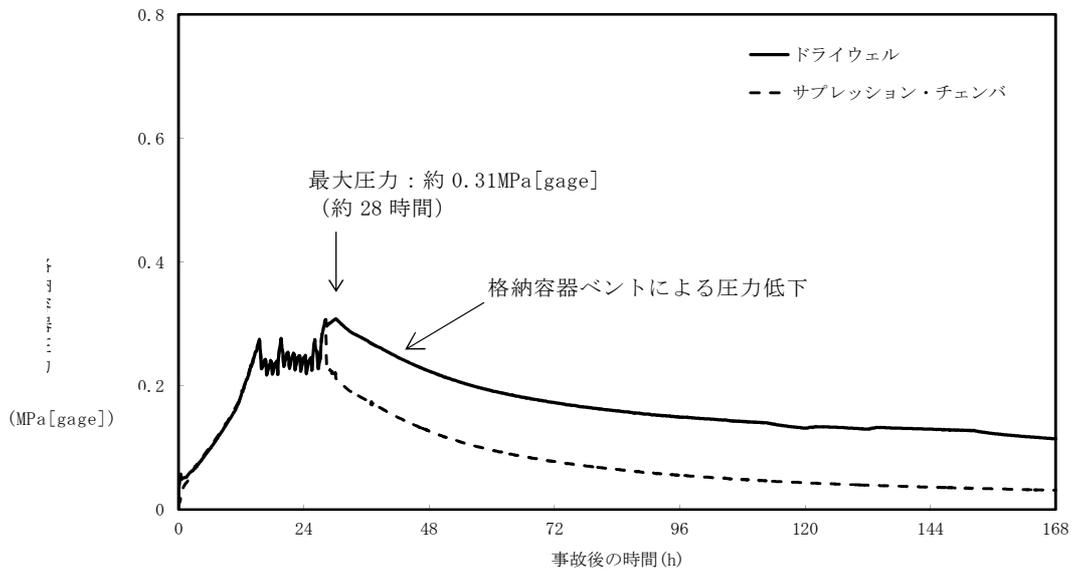
第1図 格納容器圧力の推移（L O C A時注水機能喪失\*）
