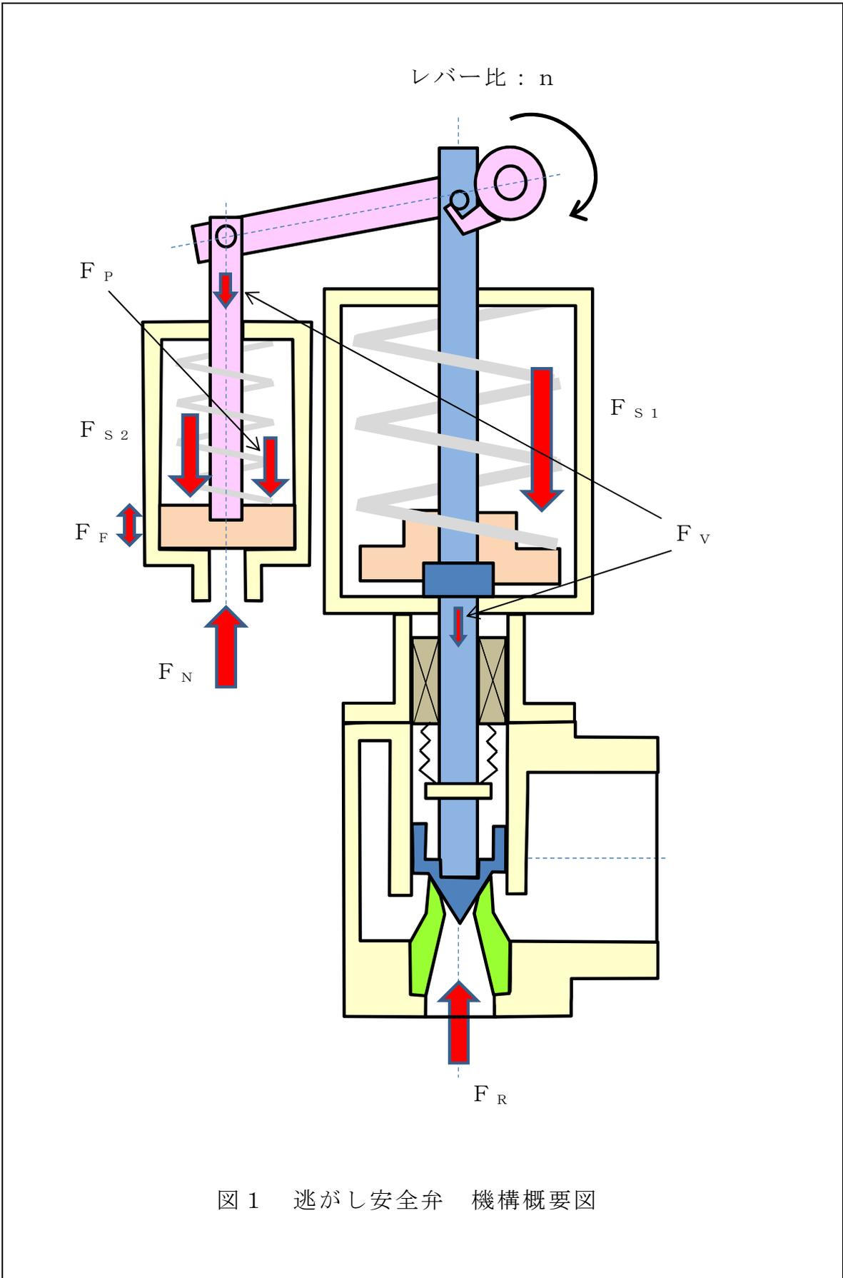
図1 逃がし安全弁 機構概要図
