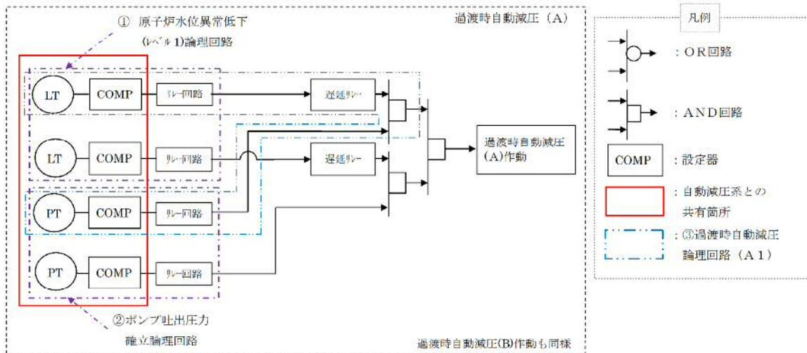
第 1 図 誤動作率評価モデル
