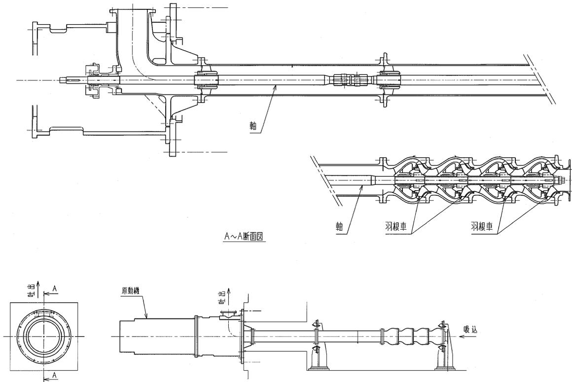
第 48-6-5 図 緊急用海水系ポンプ構造図
