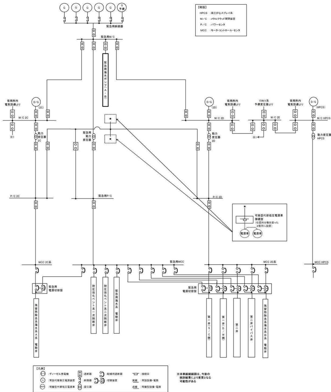
第 48-2-2 図 電源構成図 (交流電源) (2/2)
