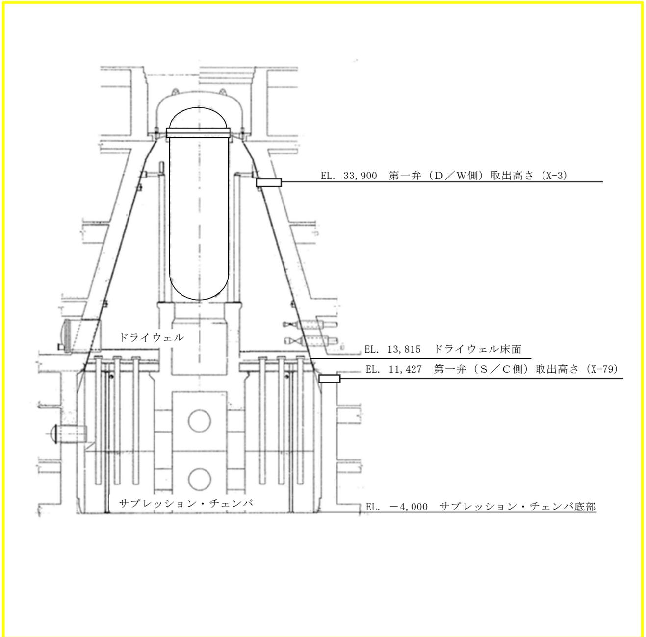
第 48-4-5 図 耐圧強化ベント系 格納容器取出し配置図
