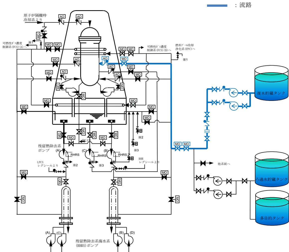
第 47-10-3 図 補給水系による原子炉注水手順の概要図
