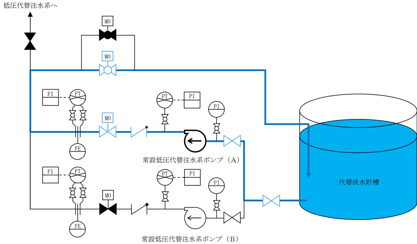
第 47-5-2 図 運転性能検査系統図
