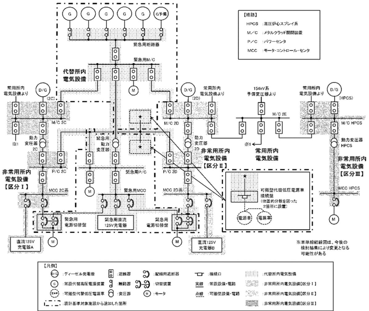
第 47-2-1 図 電源構成図（交流電源）（1/2）
