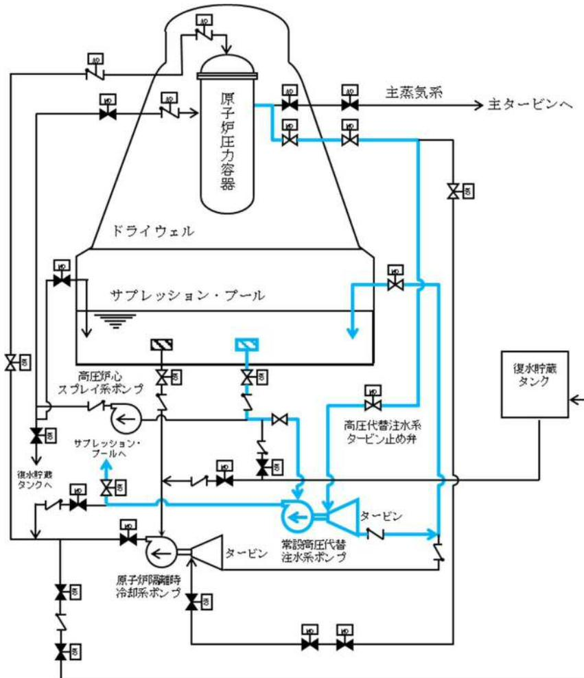
第 45-5-1 図 高圧代替注水系 運転性能検査系統図
