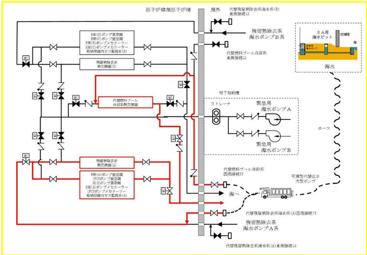
第 48-8-1 図 代替残留熱除去系海水系（可搬型）系統概要図
