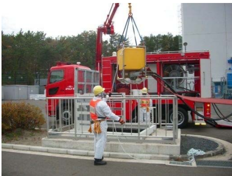
放射線防護具着用による送水訓練 （水中ポンプユニット設置）
