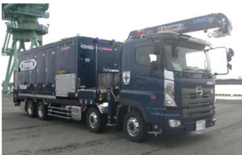
可搬型代替注水大型ポンプ
