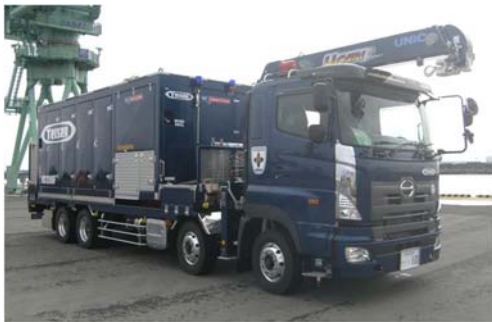
可搬型代替注水大型ポンプ
