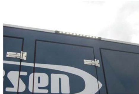
車両の作業用照明
