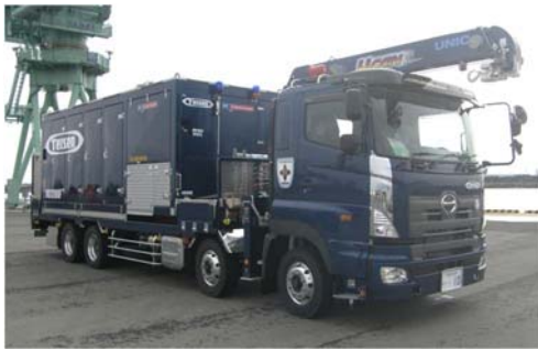
可搬型代替注水大型ポンプ
