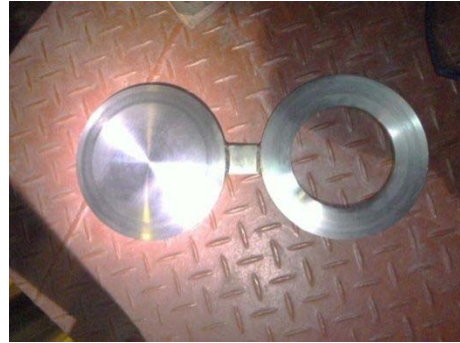
連絡配管閉止フランジ
