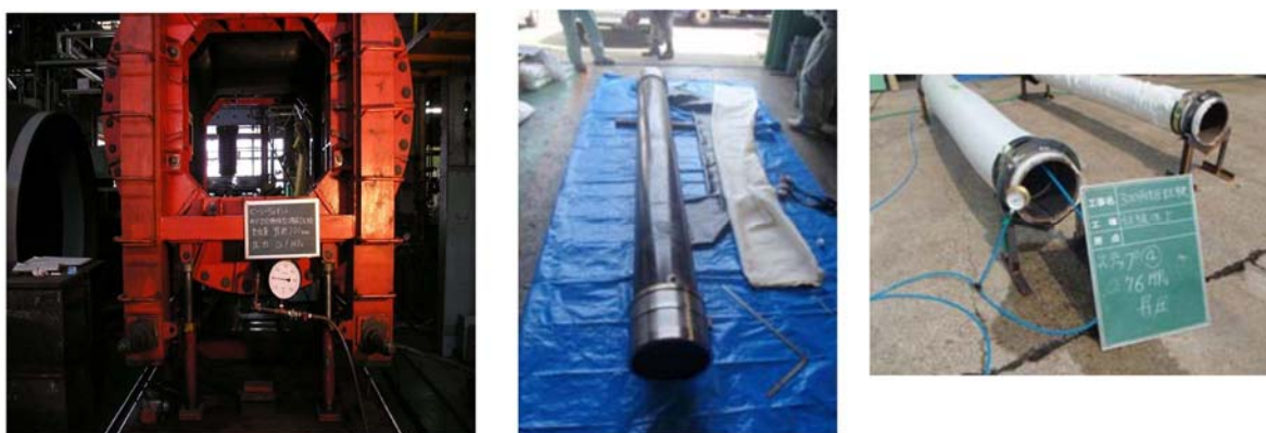
第1-26図 止水ゴム等の耐圧試験例
