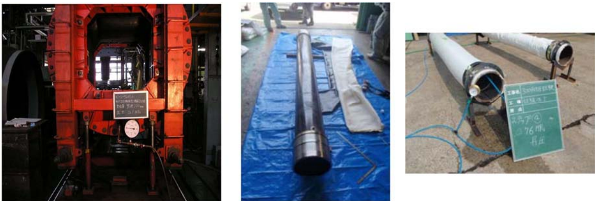
第 13 図 止水ゴム等の耐圧試験例
