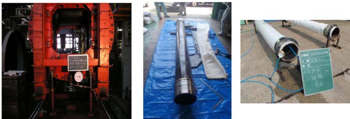
第 13 図 止水ゴム等の耐圧試験例
