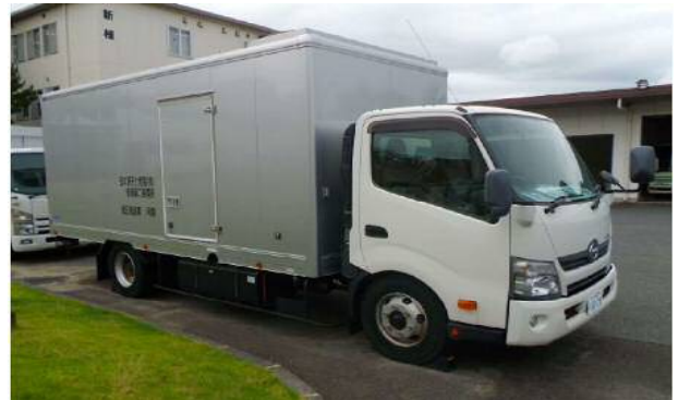
可搬型代替低圧電源車
