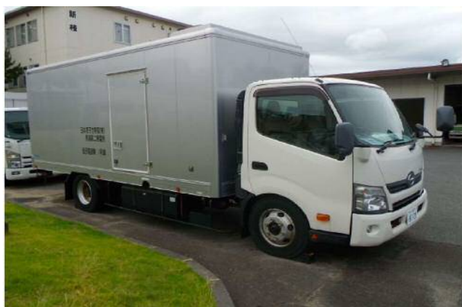
可搬型代替交流電源設備
