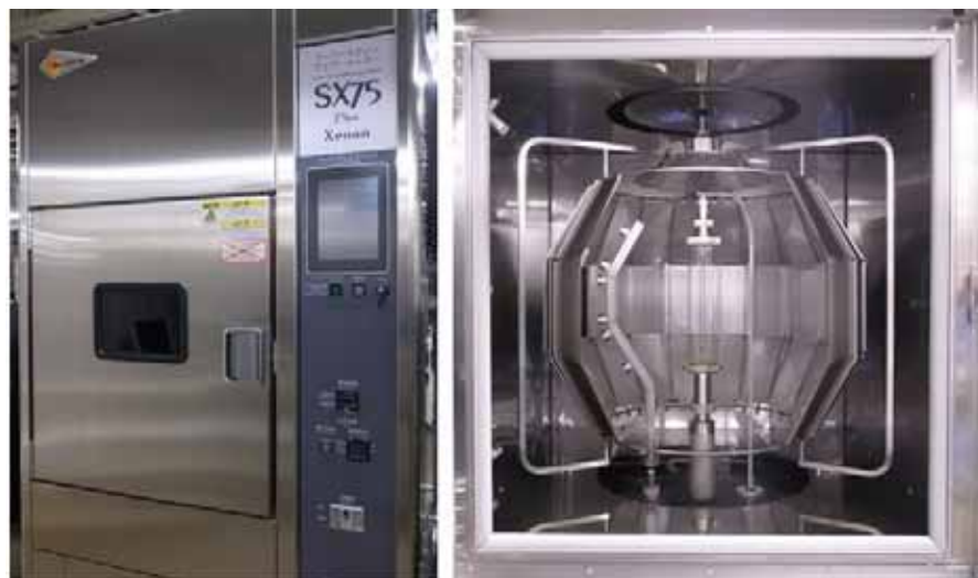
耐候性試験機例(キセノンウェザーメーター)
