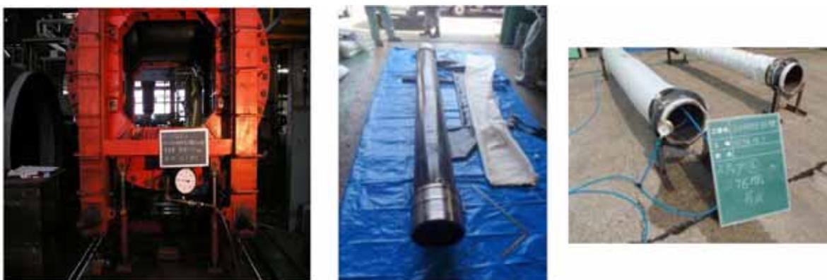
第1-26図 止水ゴム等の耐圧試験例
