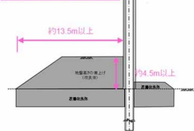
第 1-29 図 地盤高さの嵩上げ及び表層改良体の基本設定方針及び評価方針
