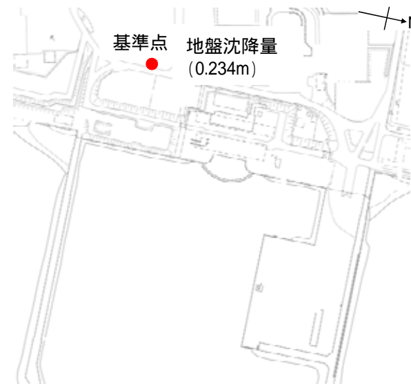
東海第二発電所内基準点測量位置
