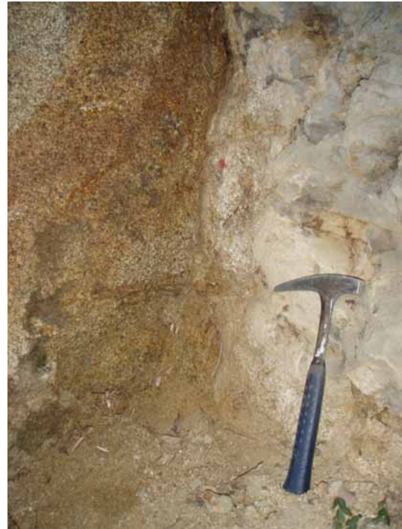
写真4 断層面の癒着した断層(拡大)
