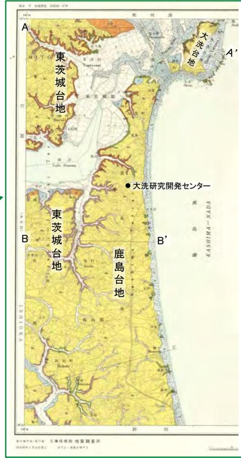
東茨城台地の上部は、海拔30m前後のきわめて平坦な地形を示す。鹿島台地も同様に平坦であるが、海拔40～45mの高さをもってあり、東茨城台地とは10m前後の高度差がある。両者のさかいには、埋谷面図(第1図)でみると、南北に走るかなり明白な高度の峻い違いとして示されている。この鹿島台地の高まりは、一般に鹿島灘沿岸地域の隆起によるものとされてきた。しかし、地質調査の結果では、少なくとも本地域内では、むしろ台地構成層の厚さの差に起因するものと考えられる。東茨城台地は、本地域より西ではわずかに低くなり、それより西でふたたび高くなって、全体として、石岡-水戸を結ぶ線を軸とした浅い凹状の地形を呈する。これらの台地の上部は、いずれも第四紀の最終間氷期における海面上昇にともなって堆積した海成層(見知層=成田層上部)の構成する一連の隆起海岸平野として形成されたものである。
