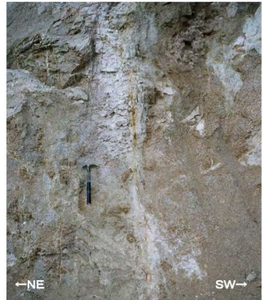
写真2 小断層(N76° W65° S)の拡大写真
