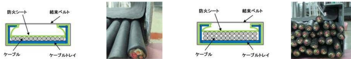
a. ケーブル少量時の施工断面
