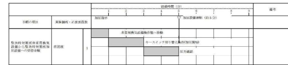
第1.18.2.1-5図 緊急時対策所非常用換気設備から緊急時対策所加圧設備への切替手順タイムチャート
