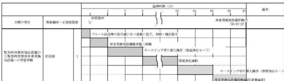
第 1.18.2.1-7 図 緊急時対策所加圧設備から緊急時対策所非常用換気設備への切替手順タイムチャート
