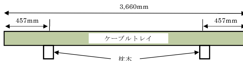
第2図 ケーブルトレイ設置方法
