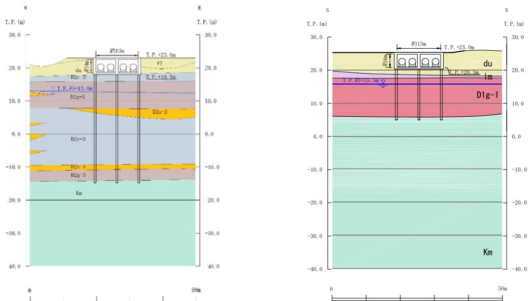
第 3-3-27 図 可搬型設備用軽油タンク基礎断面図【西側】
