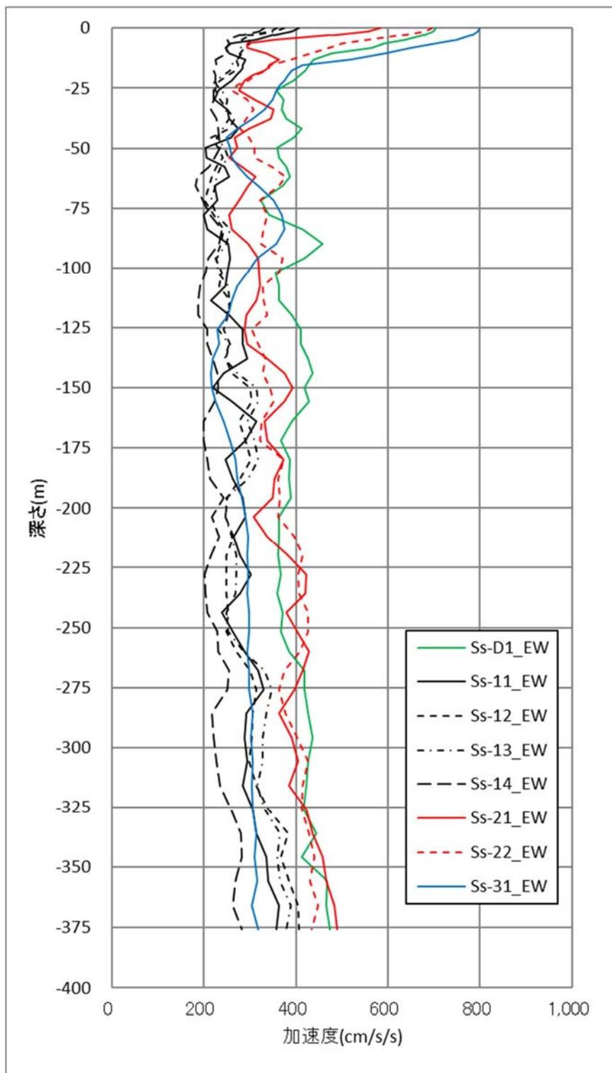
第3-9図 (2/3) 地盤応答解析結果 (EW方向)
