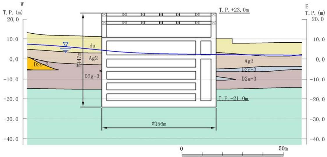
第 2.2-2 (1) 図 常設代替高圧電源装置置場 断面図 (東西断面)
