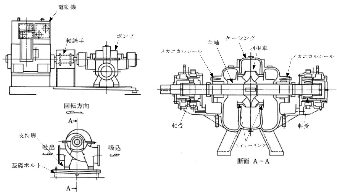
第4図 遠心式ポンプ構造概要図
