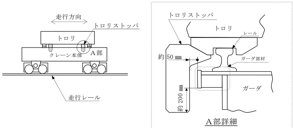
第6図 トロリの落下防止対策概要図
