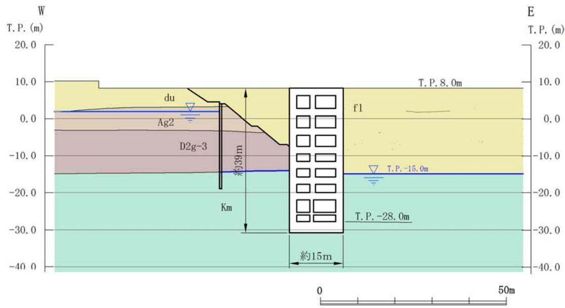
第 2.3-4 (1) 図 常設代替高圧電源装置用カルバート（立坑部）断面図
