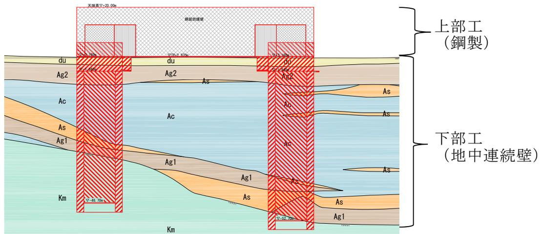
第 3-4-9 図 鋼製防護壁の下部工
