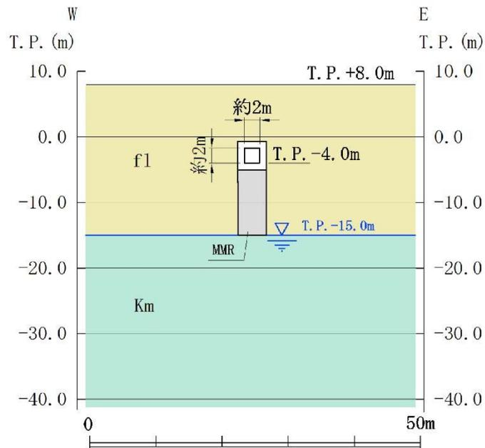
第 3-3-13 図 常設低圧代替注水系配管カルバート
