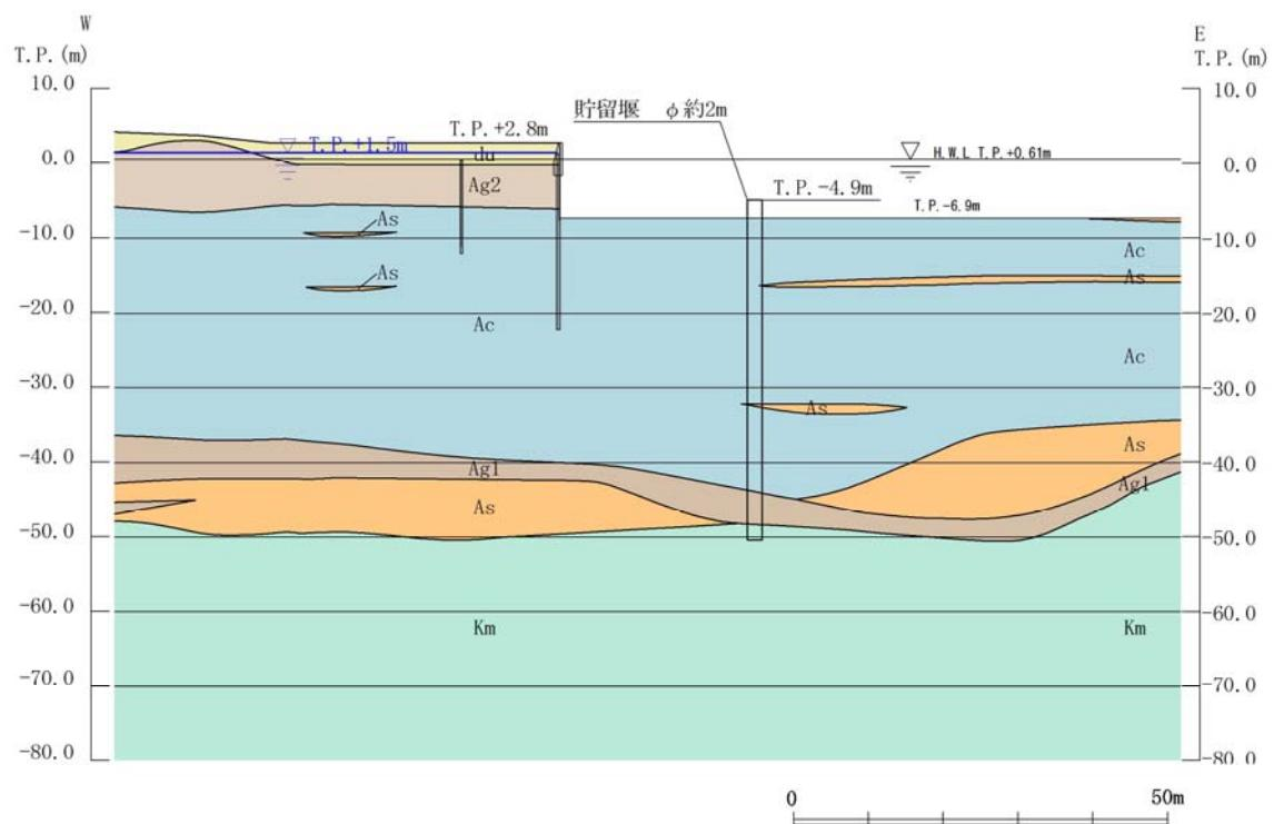
第 1.4-2 (2) 図 貯留堰 断面図 (EW-2 断面)
