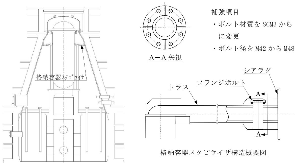
第2図 格納容器スタビライザの耐震補強概要図
