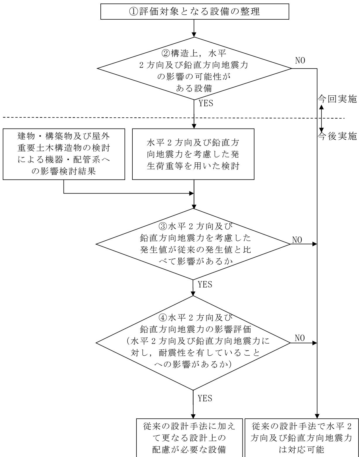
第3-2-1図 水平2方向及び鉛直方向地震力を考慮した影響評価フロー
