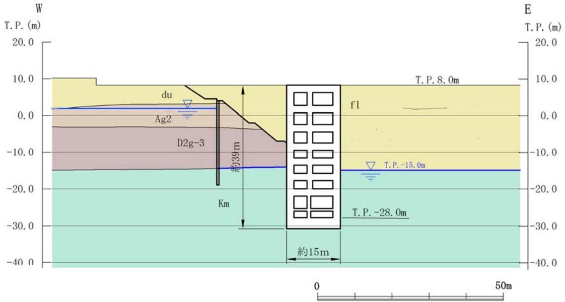
第 2.3-4 (1) 図 常設代替高圧電源装置用カルバート (立坑部) 断面図
