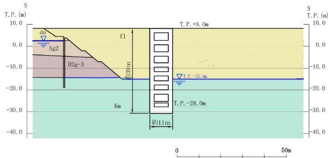
第3-3-23図 常設代替高圧電源装置用カルバート（立坑部）断面図
