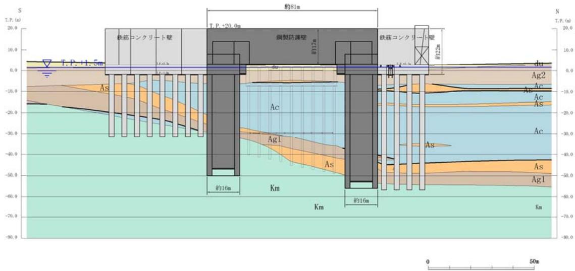
第 1.5-7 図 鋼製防護壁 正面図 (A-A 断面)
