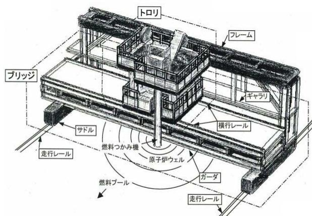
第4図 燃料取替機の耐震補強概要図
