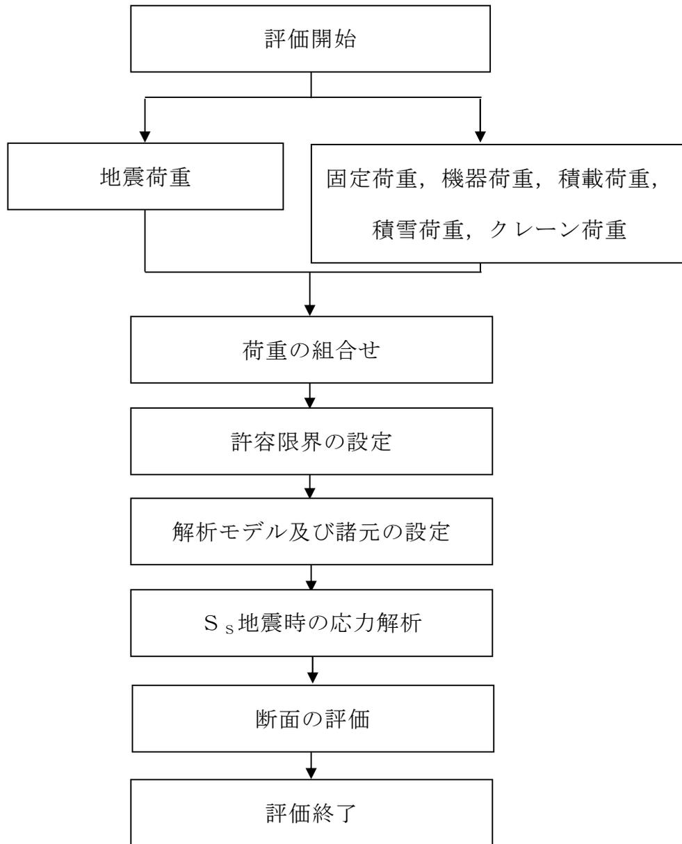
第4-1図 応力解析による評価フロー（基礎）
