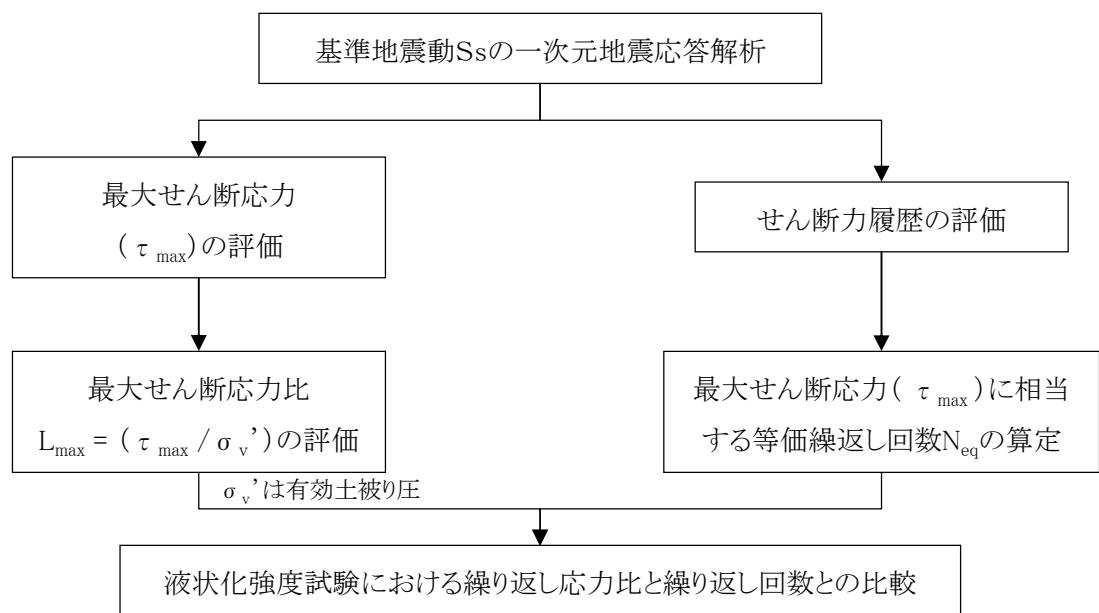
第 4.4.1 図 累積損傷度理論に基づく等価繰り返し回数の評価フロー
