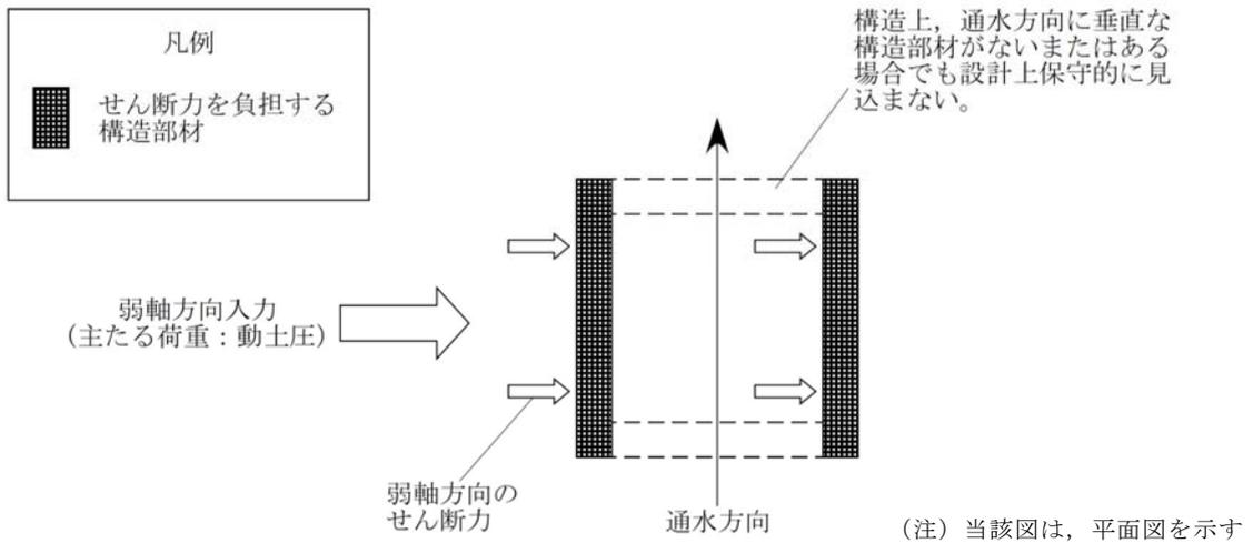
第3-3-1図 従来設計手法の考え方
