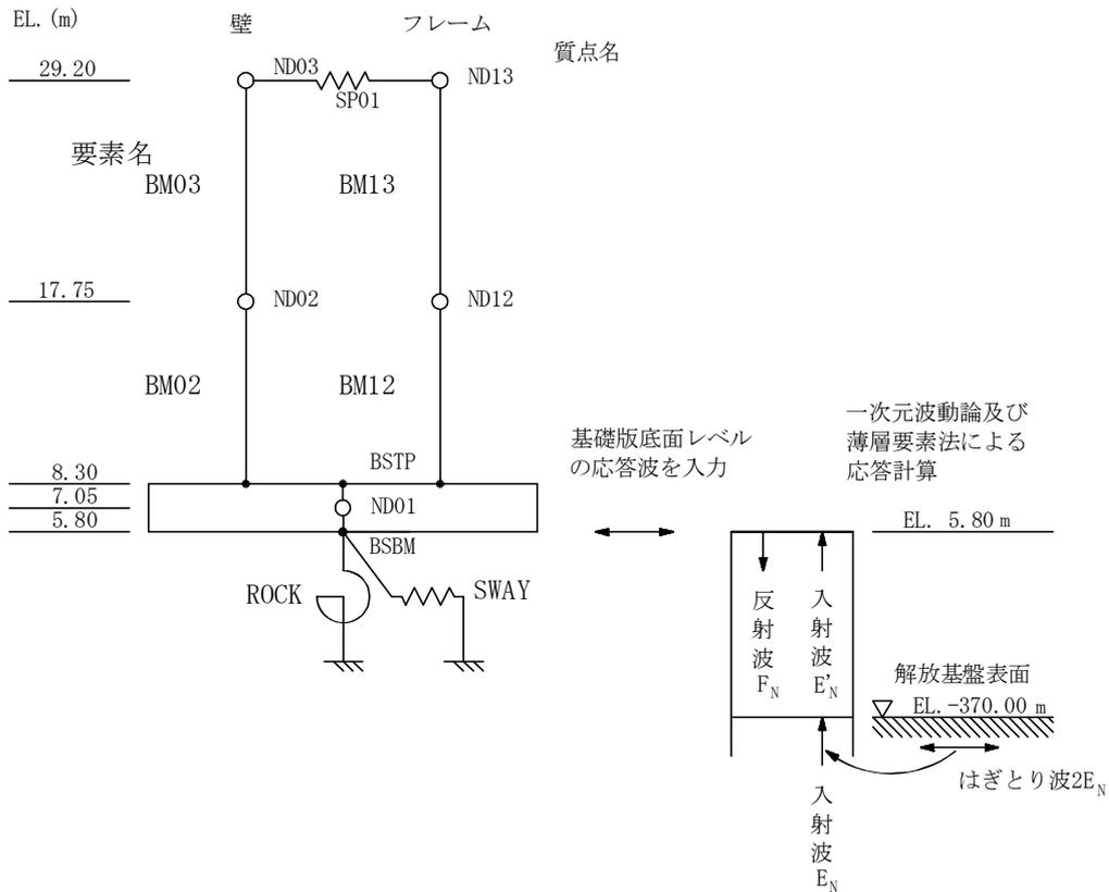
第3-2図 地震応答解析モデル (EW方向)
