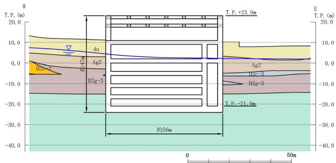
第 2.2-2 (1) 図 常設代替高圧電源装置置場 断面図（東西断面）
