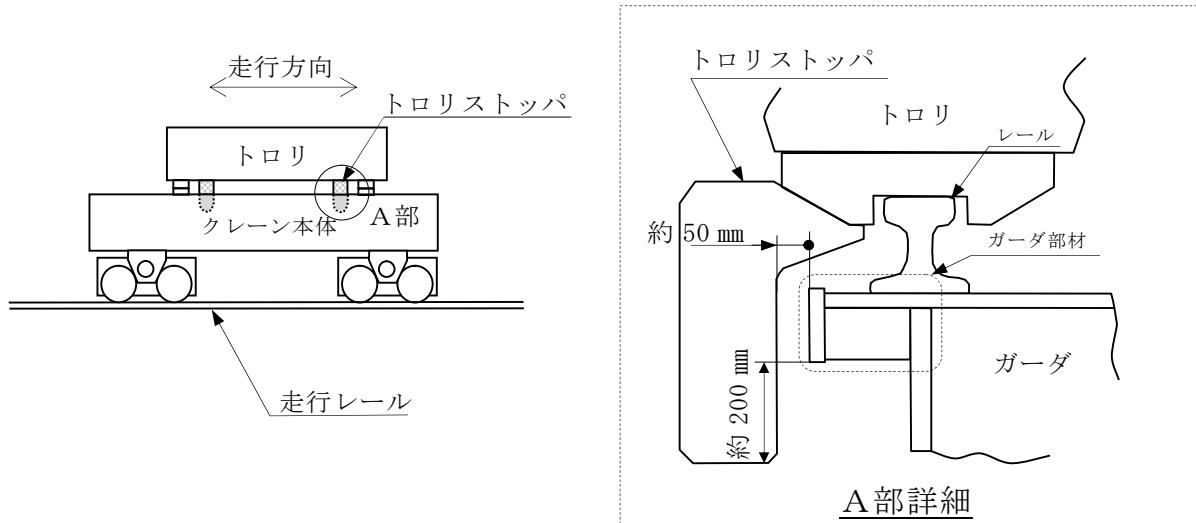
第6図 トロリの落下防止対策概要図
