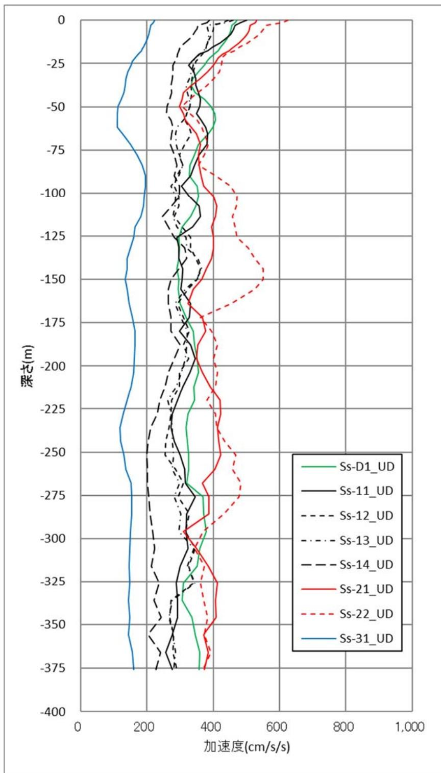
第3-9図(3/3) 地盤応答解析結果(UD方向)
