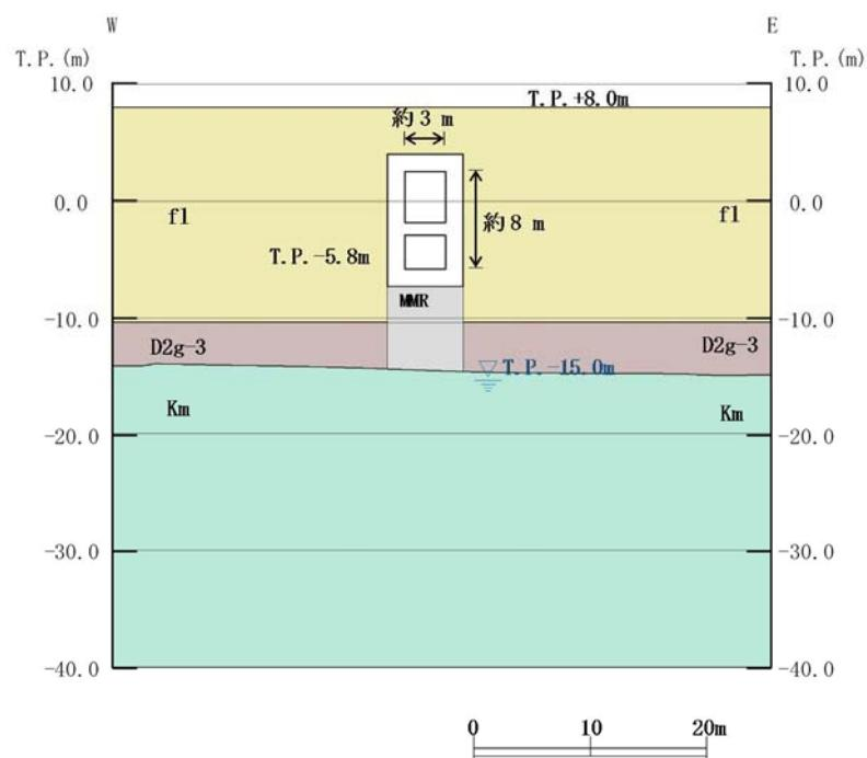
第3-3-16図 格納容器圧力逃がし装置用配管カルバート
