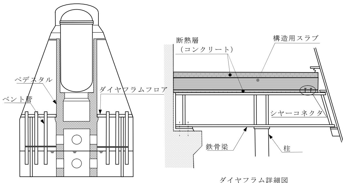
第 4-1 図 ダイヤフラムフロアの構造
