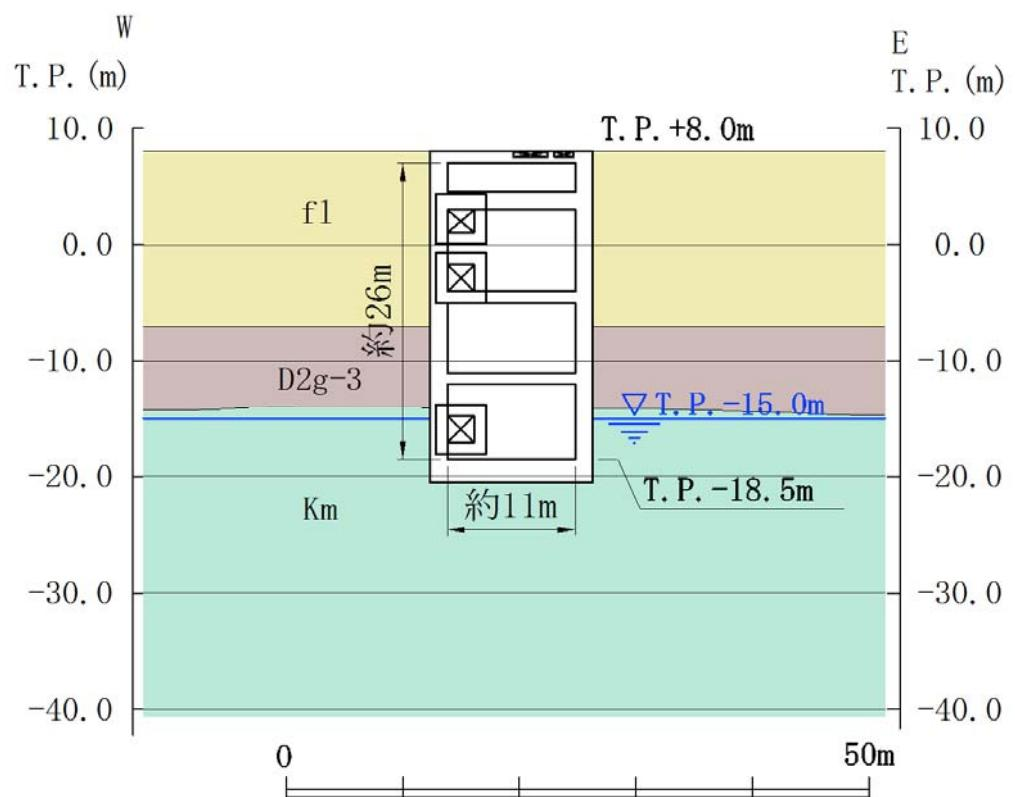
第 2.5-2 (1) 図 常設低圧代替注水系ポンプ室 断面図（東西断面）
