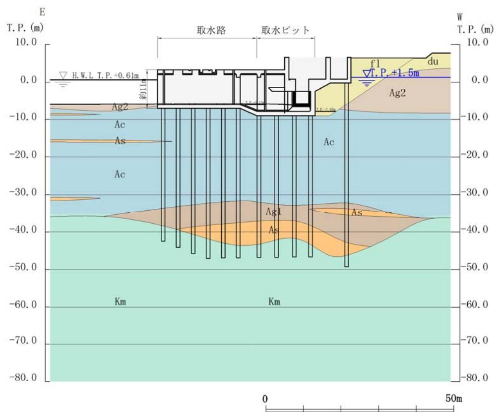
第 1.2-2 図 取水構造物 縦断面図 (A-A 断面)
