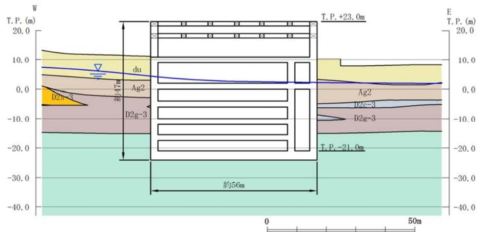
第3-3-21図 常設代替高压電源装置置場 断面図（東西断面）
