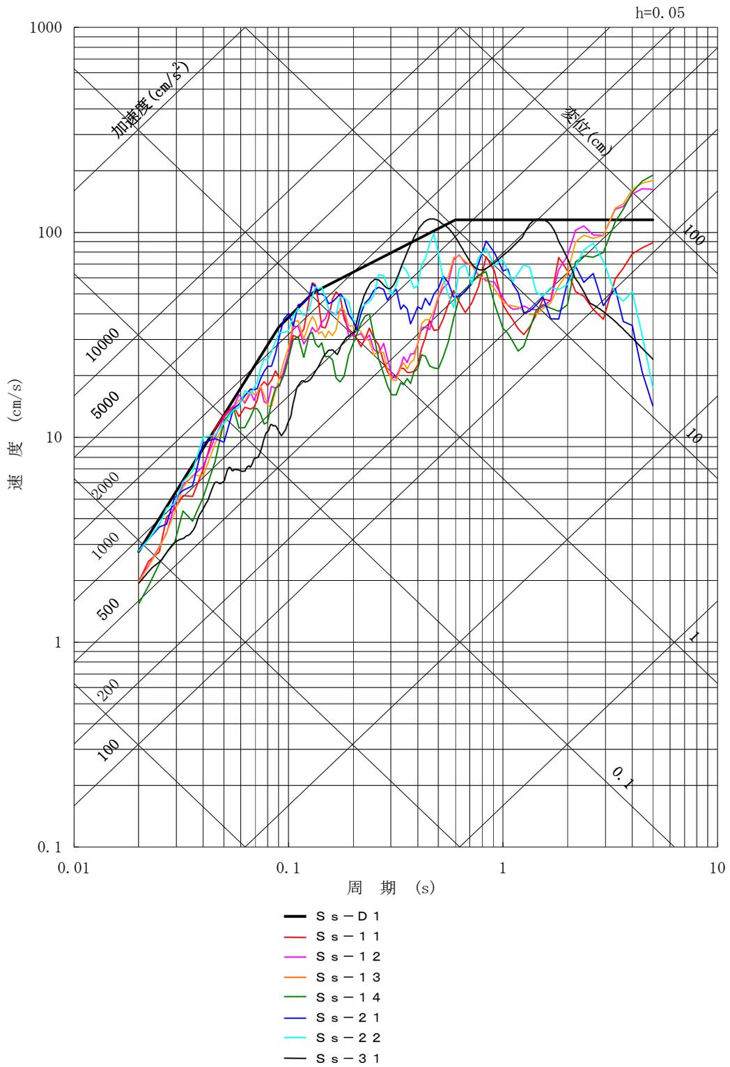
第2-1図 (2/2) 基準地震動 S<sub>s</sub> の応答スペクトル (EW方向)
