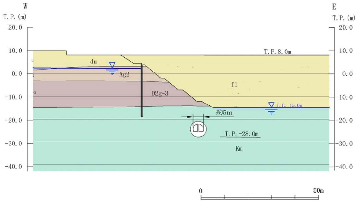
第 2.3-3 図 常設代替高圧電源装置用カルバート（トンネル部）
