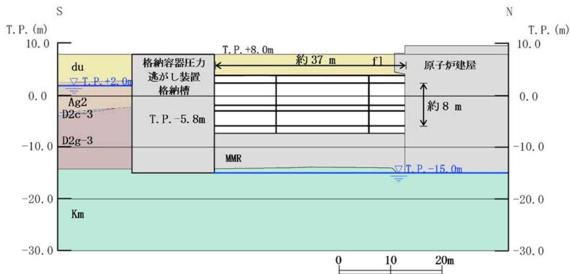
第3-3-15図 格納容器圧力逃がし装置用配管カルバート
