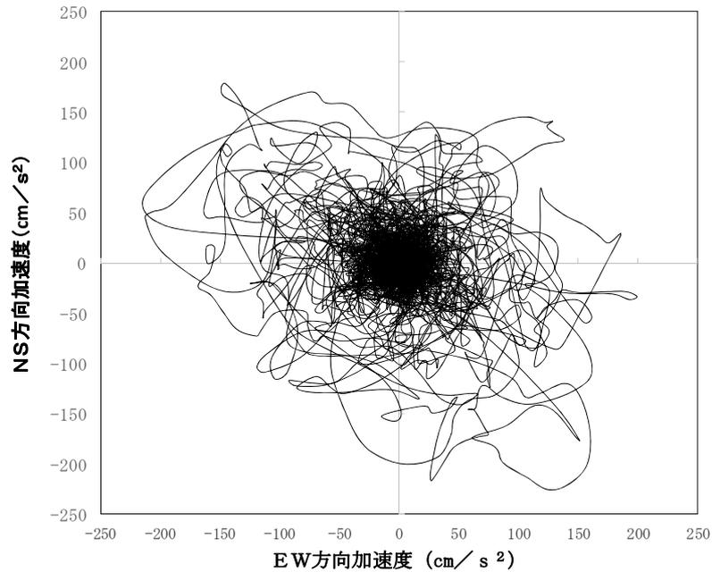
第2図 東北地方太平洋沖地震における原子炉建屋(EL. -4.0m)のオービット
