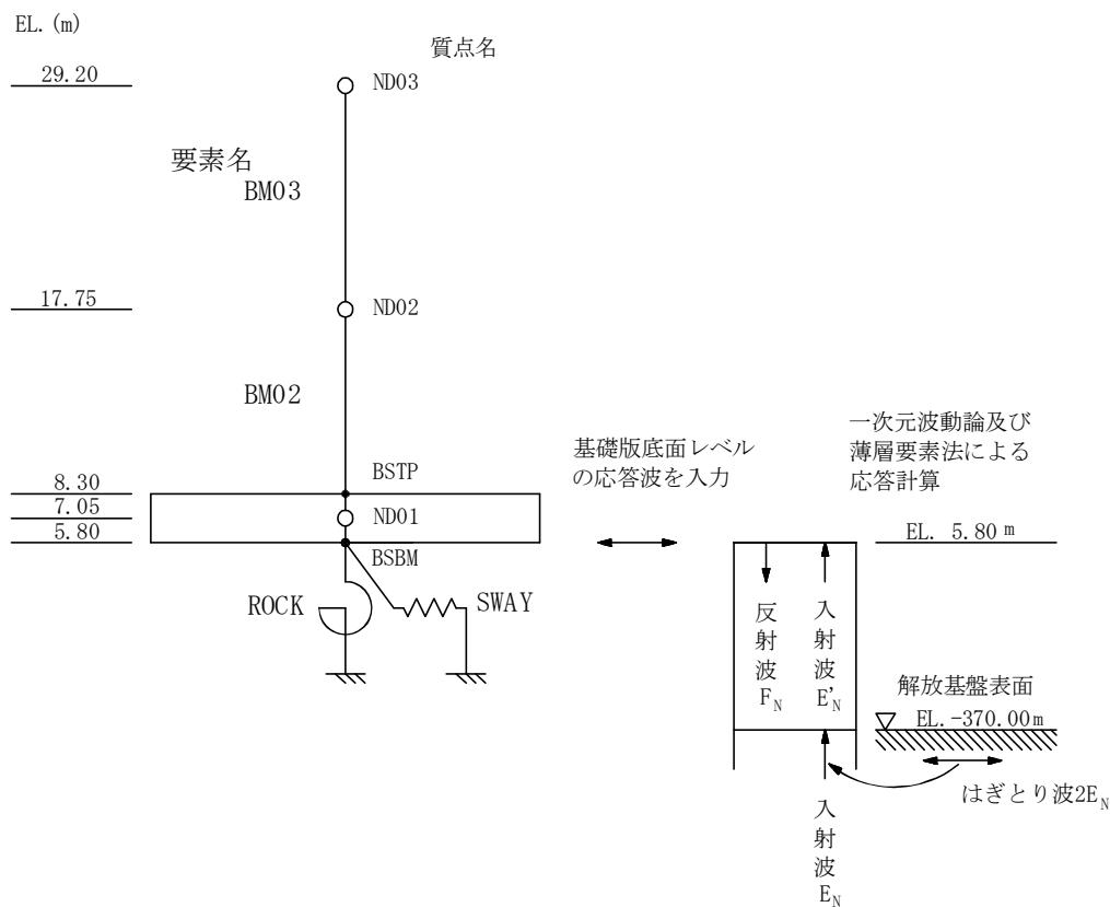
第3-1図 地震応答解析モデル（NS方向）
