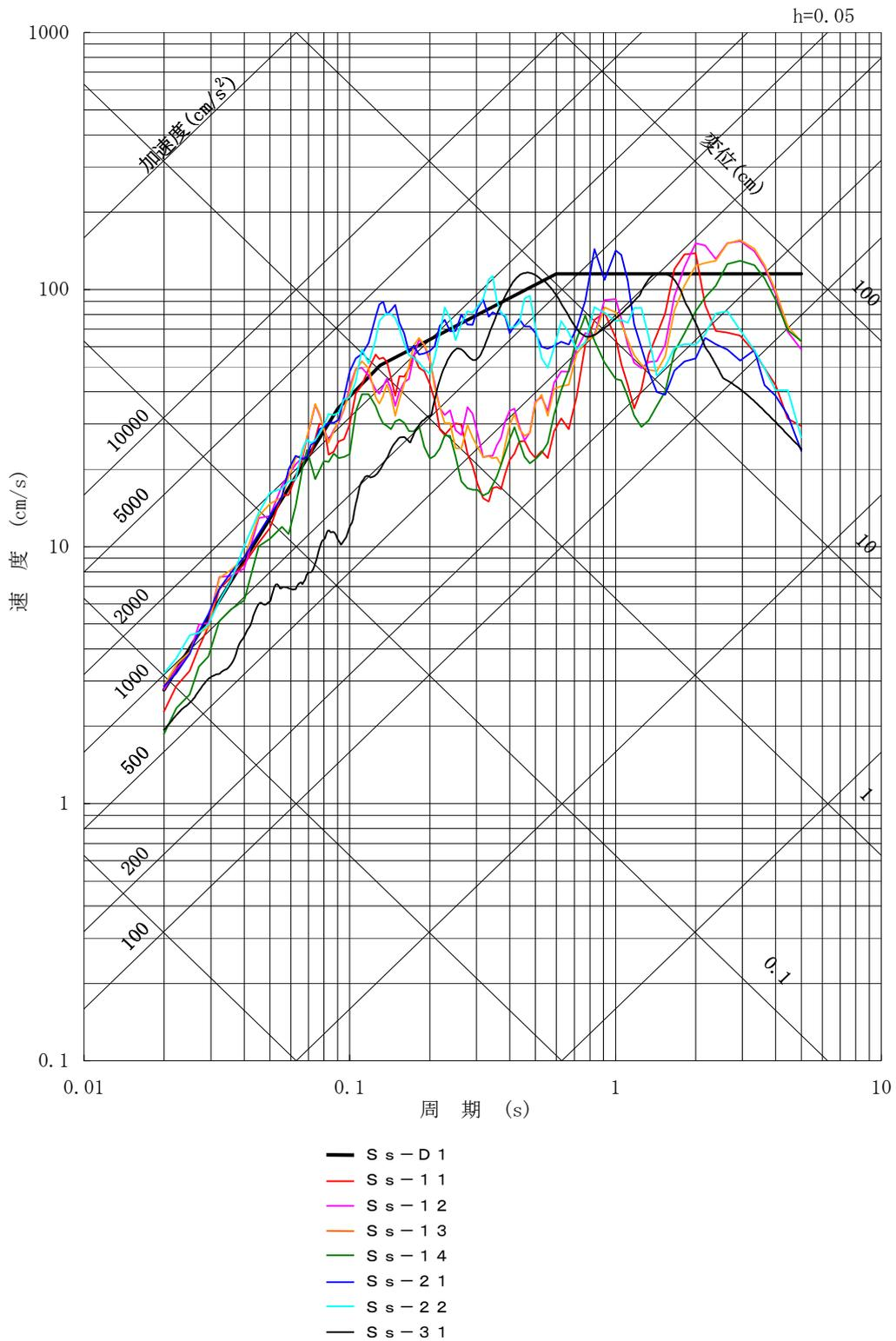
第2-1図 (1/2) 基準地震動 S<sub>s</sub> の応答スペクトル (NS方向)
