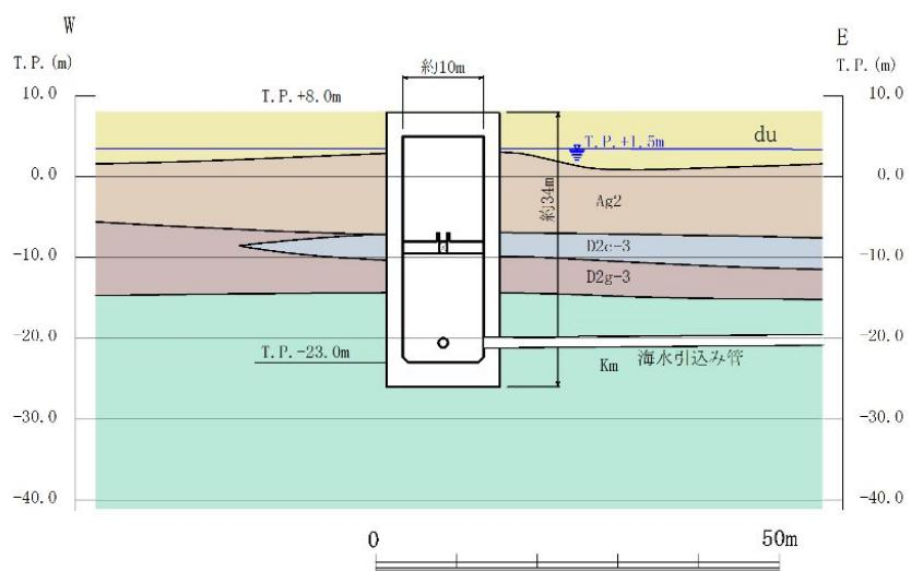
第 3-3-30 図 S A 用海水ピット 断面図
