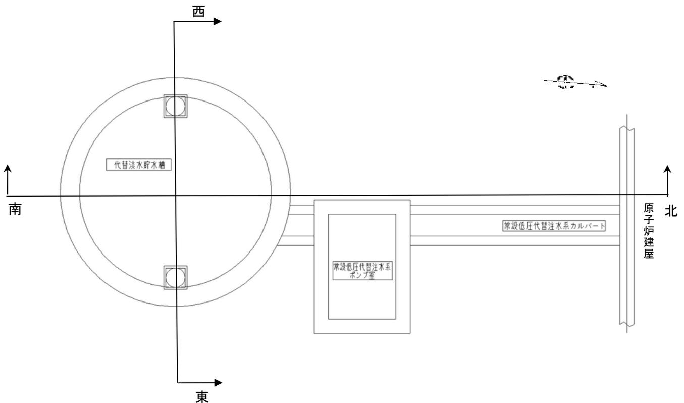
第 2.4-1 図 代替淡水貯槽 平面図
