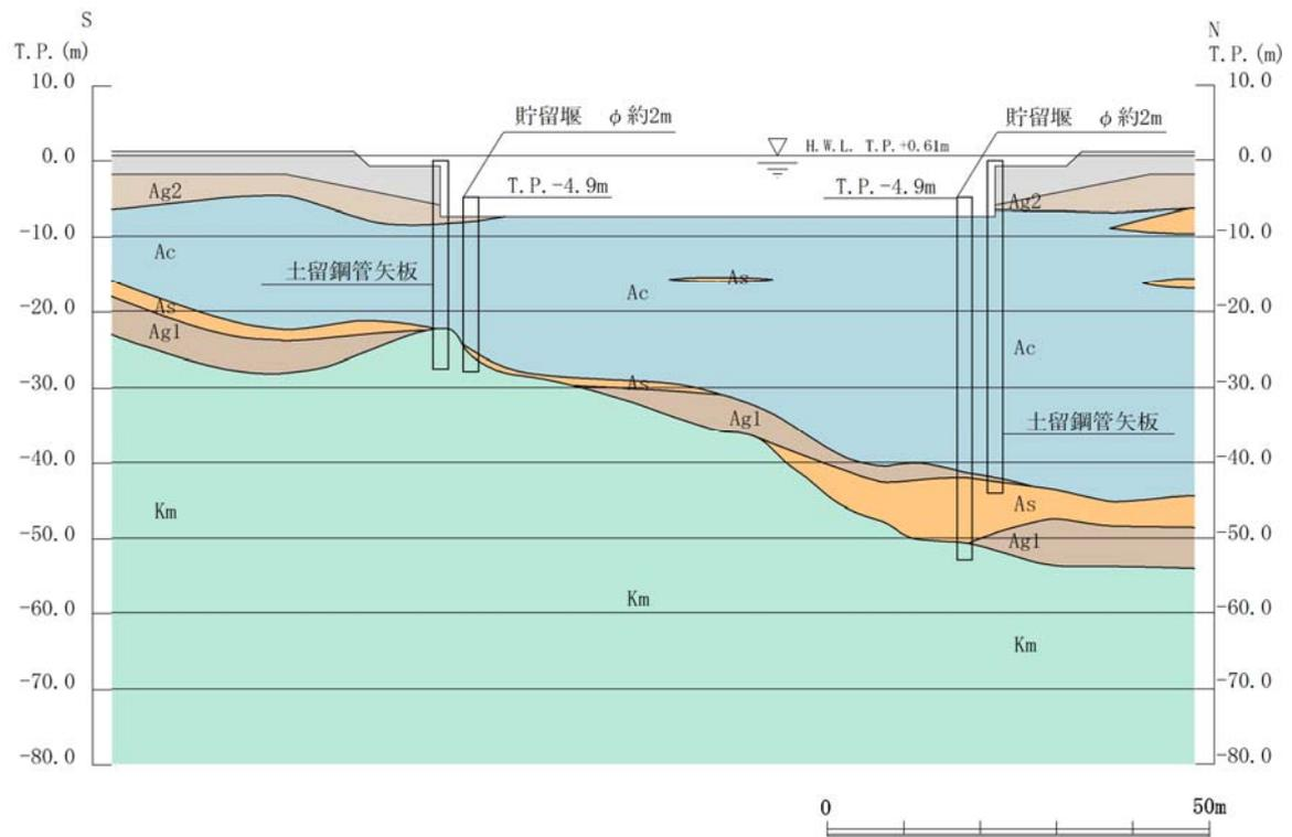
第 1.4-2 (3) 図 貯留堰 断面図 (NS-1 断面)
