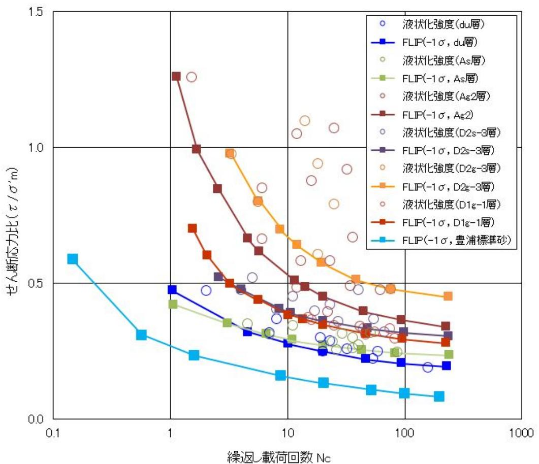
第 1.1.2 図 原地盤に基づく液状化強度特性と豊浦標準砂を仮定した
