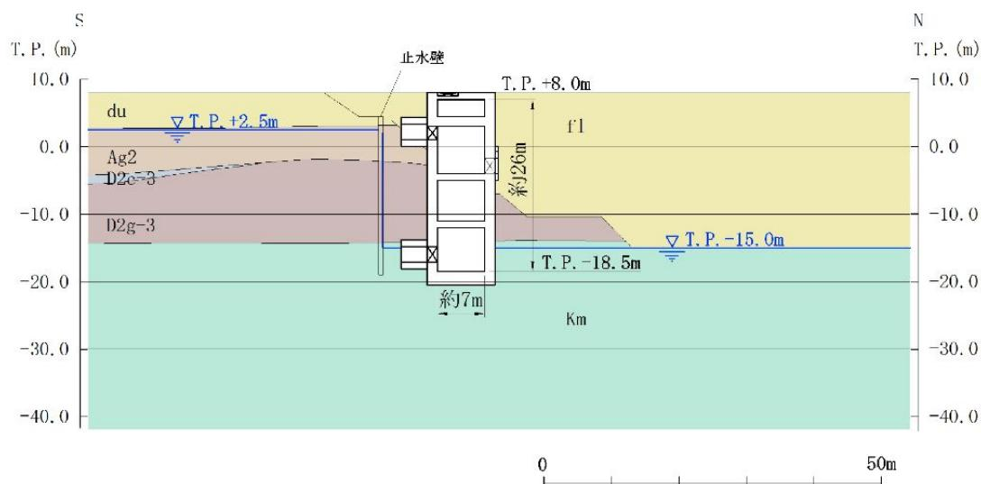
第3-3-24図 常設低圧代替注水系ポンプ室
