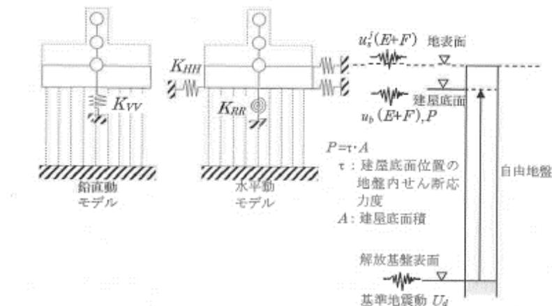
附図2.6-5 地盤ばねモデルへの入力地震動（一次元波動論による場合）
