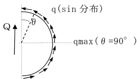
$Q$  : 地震時にダイヤフラムフロア全体が受ける水平力
