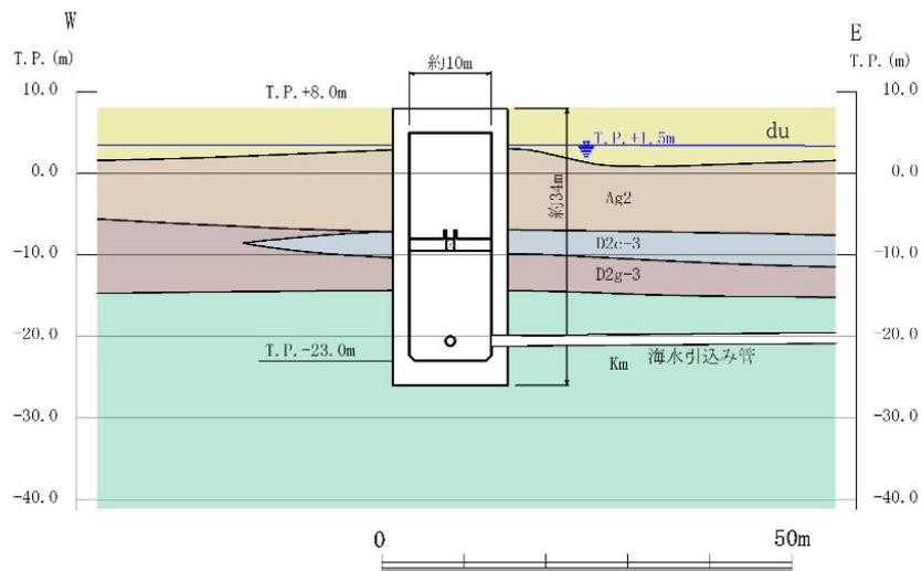
第 3-3-30 図 S A用海水ピット 断面図
