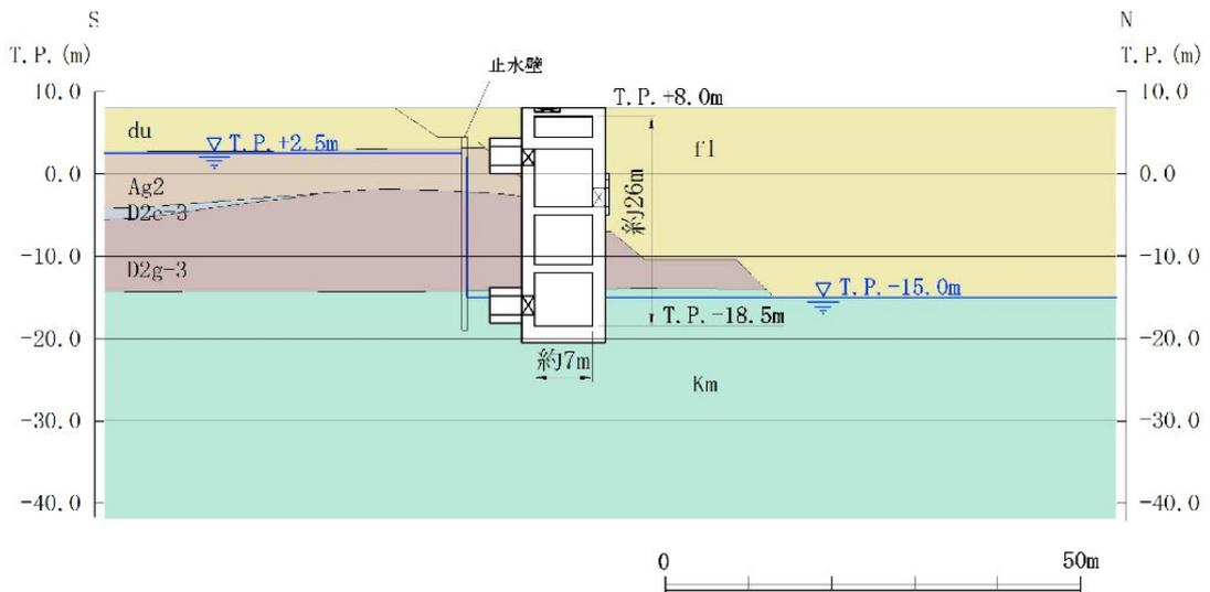
第 3-3-24 図 常設低压代替注水系ポンプ室
