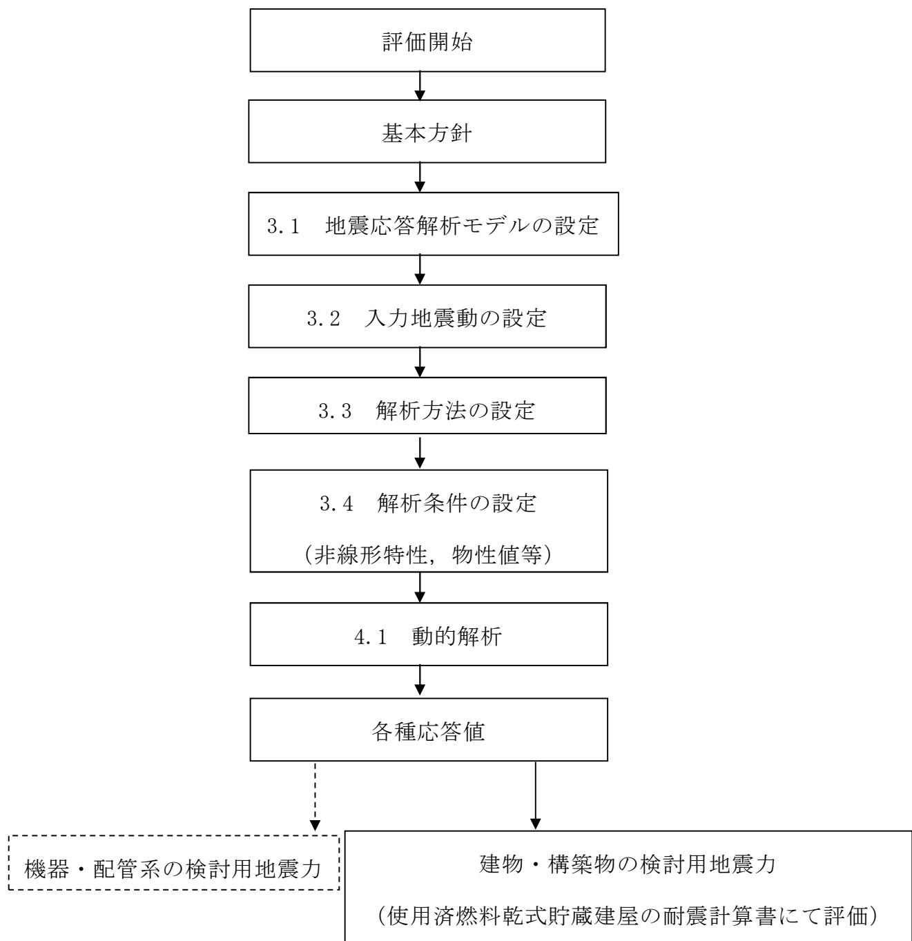
第2-4図 使用済燃料乾式貯蔵建屋の地震応答解析フロー
