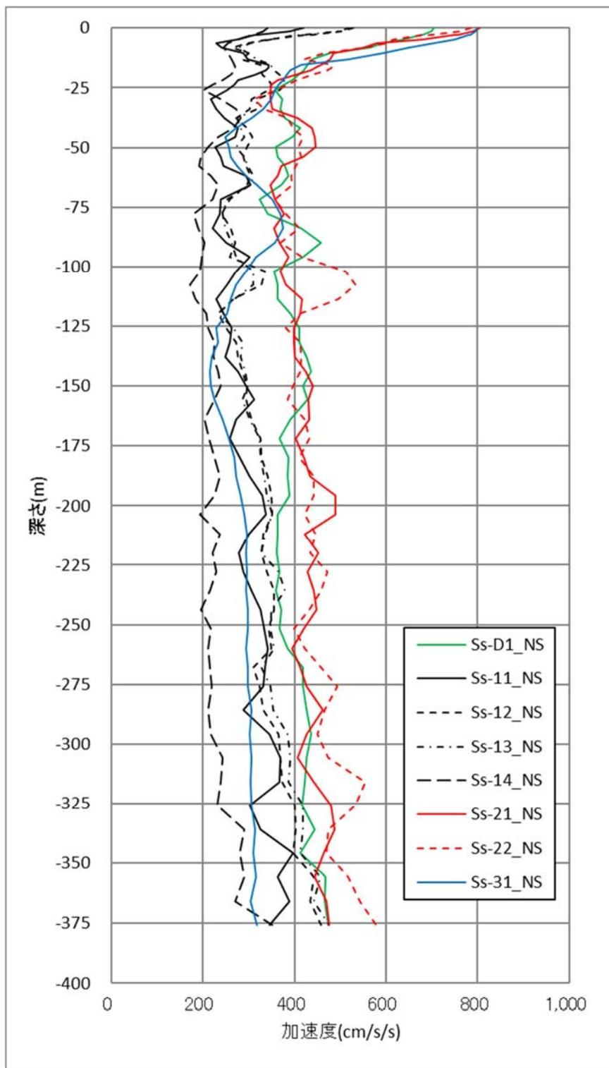
第3-9図 (1/3) 地盤応答解析結果 (NS方向)
