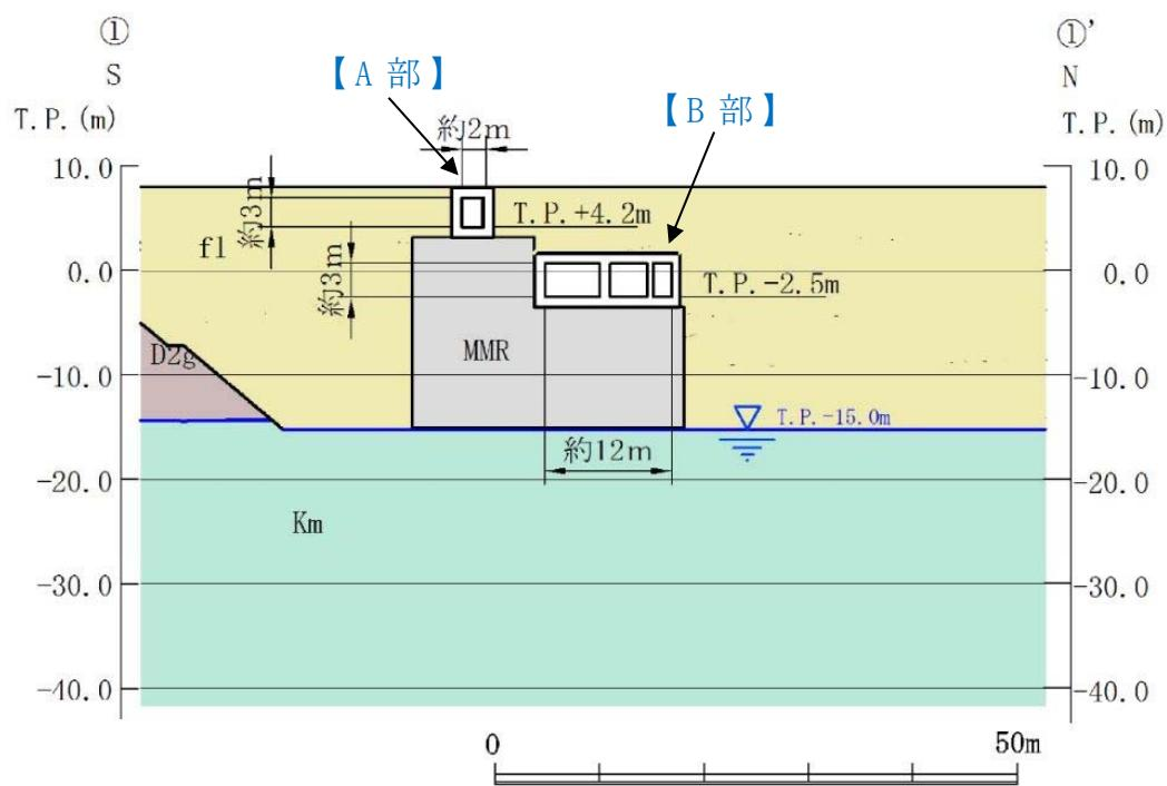
第 3-3-11 図 常設代替高圧電源装置用カルバート
