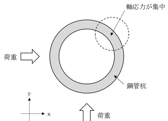
第3-4-13 図 鋼管杭基礎に係る応答特性
