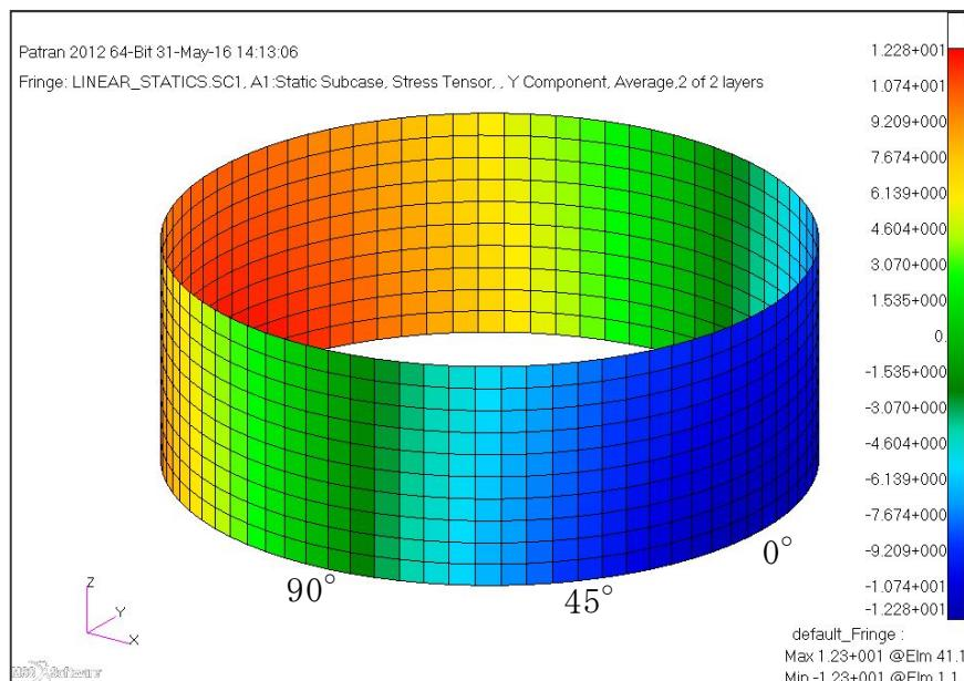
第3-2図 水平地震時軸方向応力センター図
