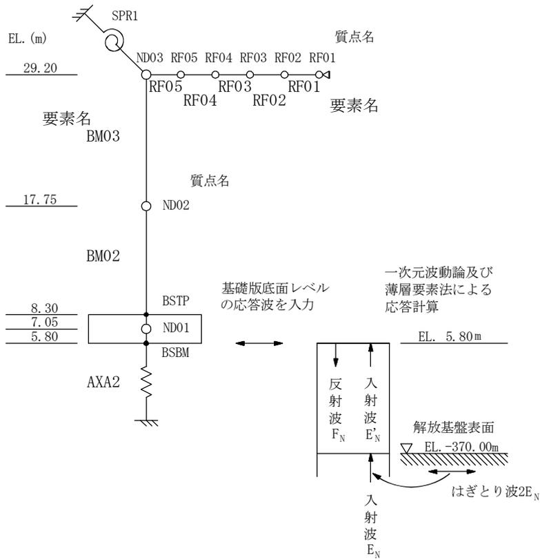
第3-3図 地震応答解析モデル（鉛直方向）
