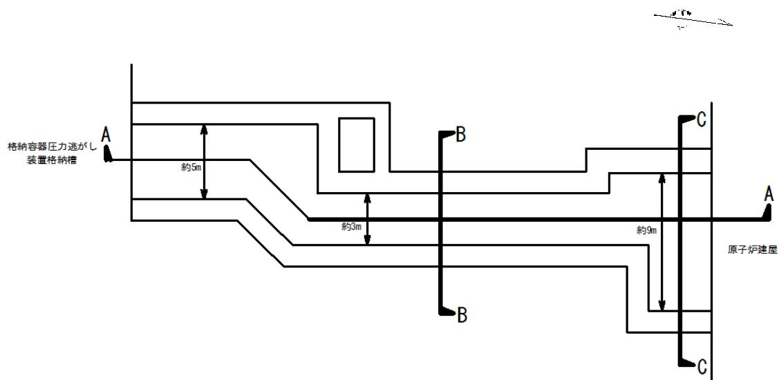
第 2.8-1 図 格納容器圧力逃がし装置用配管カルバート 平面図
