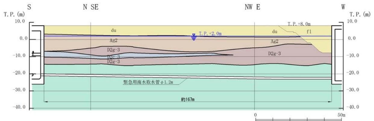
第 2.9-2 図 緊急用海水取水管 縦断面図
