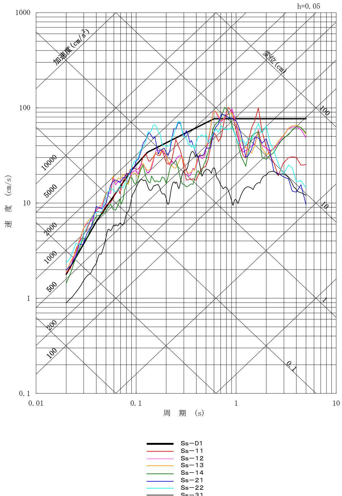
第3-5図 (2/2) 基準地震動  $S_s$  の応答スペクトル (鉛直方向)
