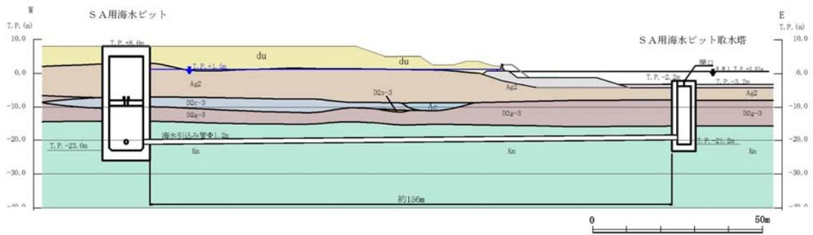
第 2.11-2 図 海水引込み管 縦断面図
