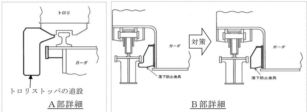
第3図 原子炉建屋クレーンの落下防止対策概要図
