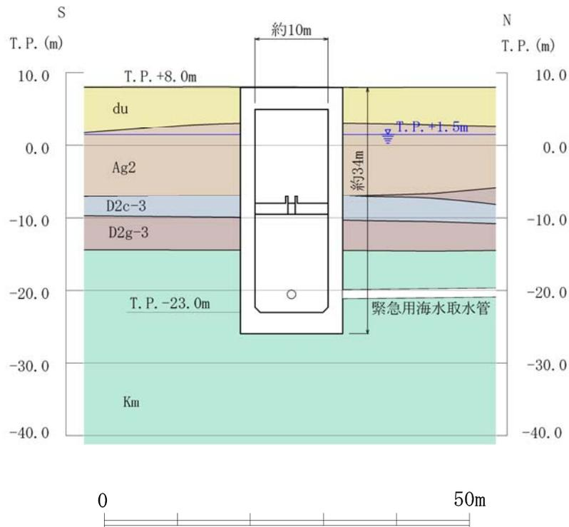
第 2.10-2 (2) 図 SA用海水ピット 断面図 (②-②断面)
