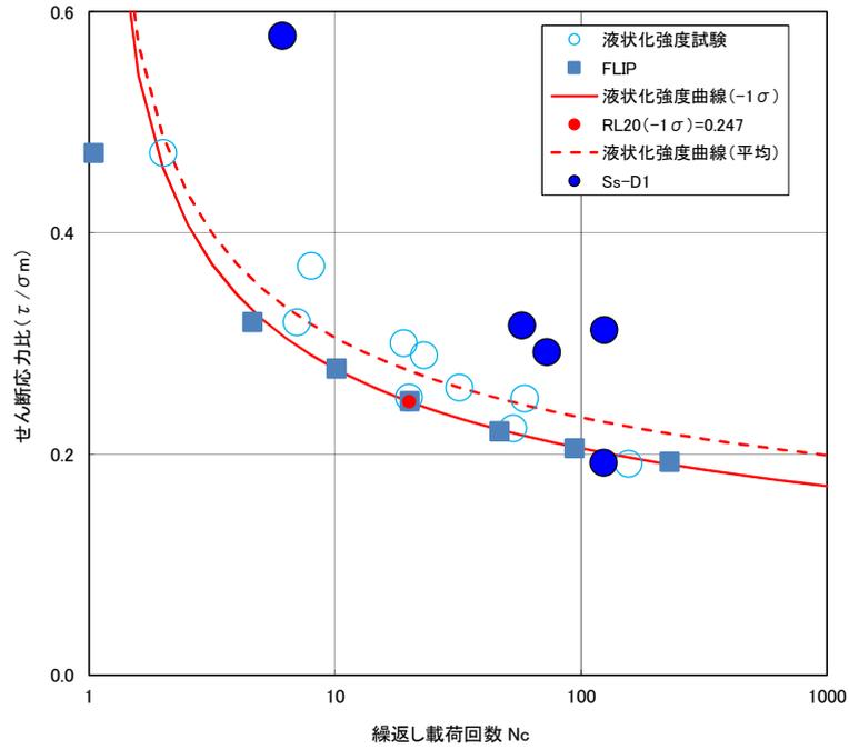
第 4.4.3 図 累積損傷度理論に基づく評価結果
