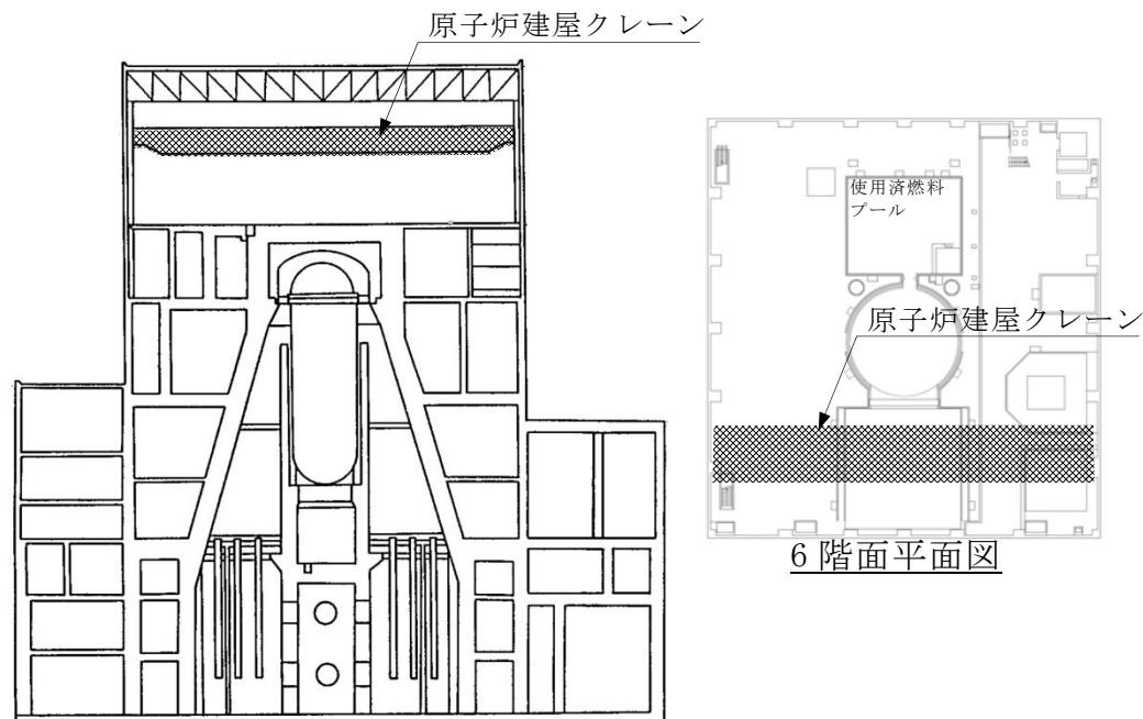
第1図 原子炉建屋クレーン配置図
