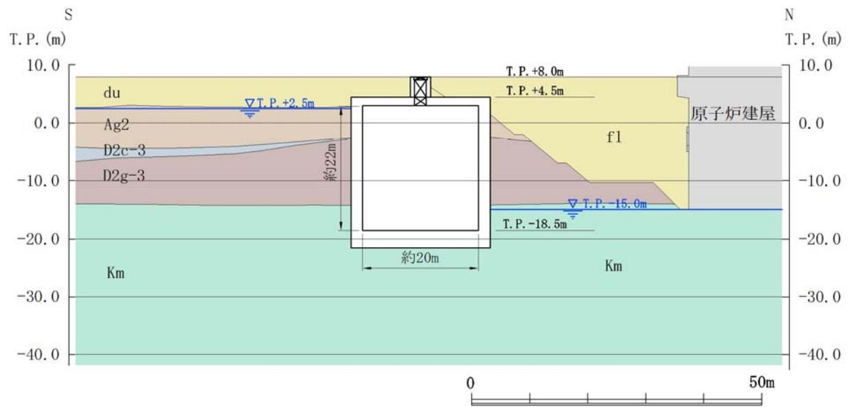
第 2.4-2 (2) 図 代替淡水貯槽 断面図（南北断面）
