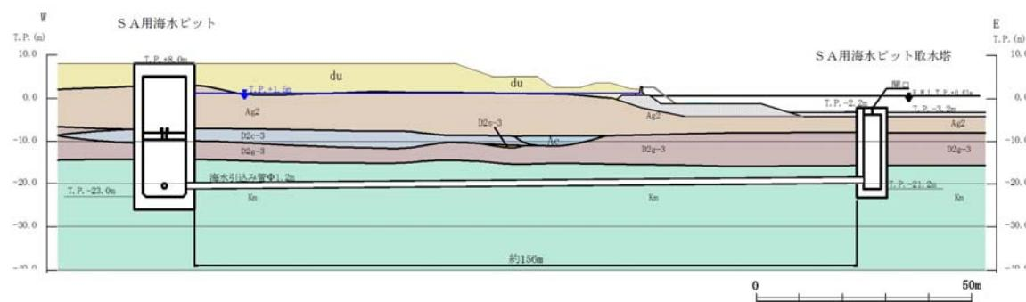
第 2.11-2 図 海水引込み管 縦断面図
