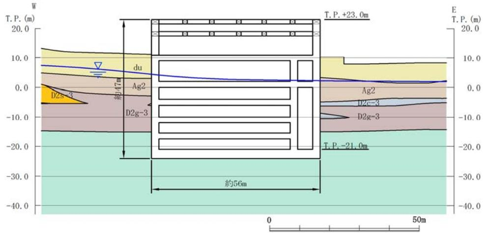
第 3-3-21 図 常設代替高圧電源装置置場 断面図（東西断面）
