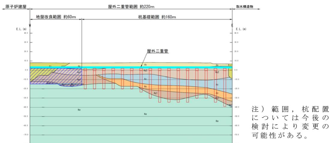
第3-3-33図 屋外二重管 縦断面図 (A-A断面)
