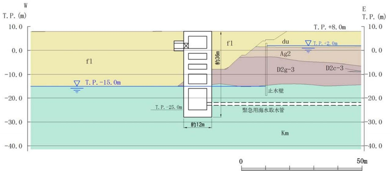
第 2.7-2 (1) 図 緊急用海水ポンプピット 断面図 (東西断面)
