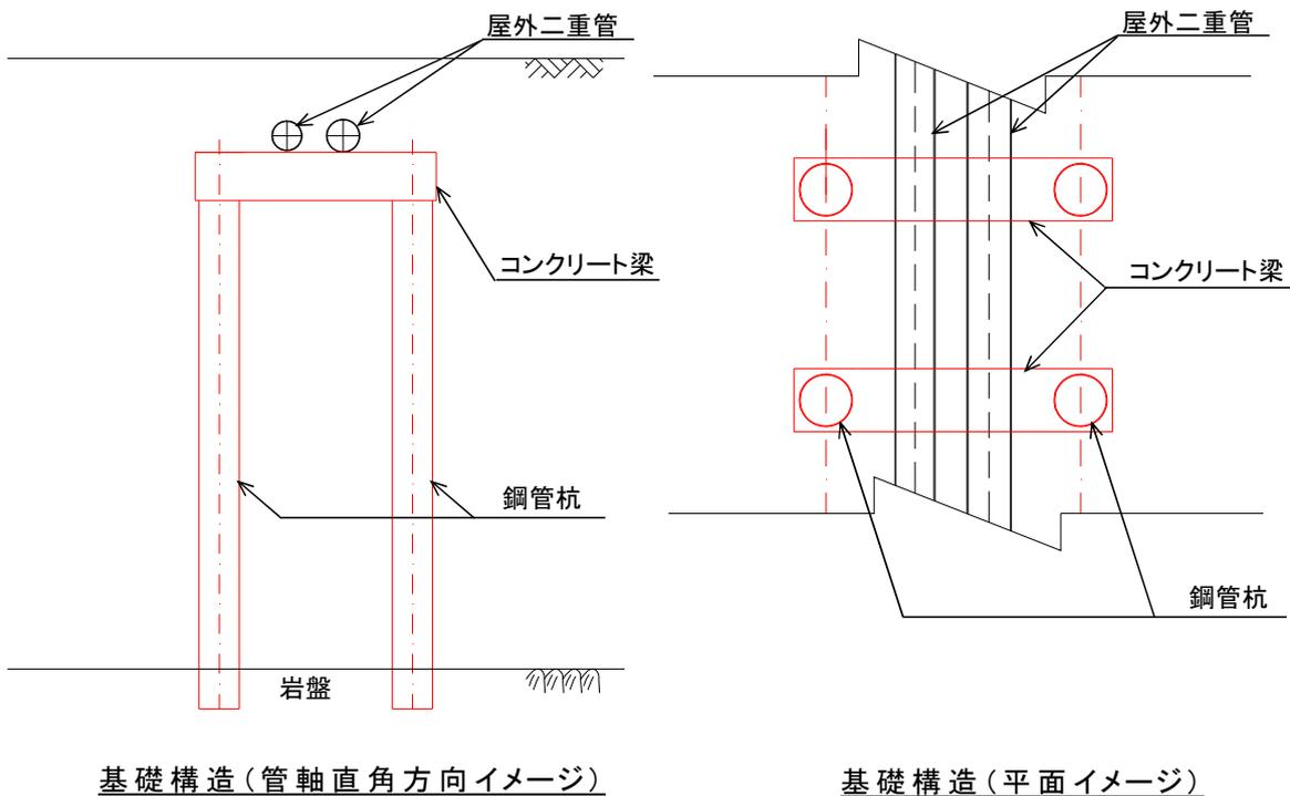
第5図 屋外二重管の基礎構造概要図
