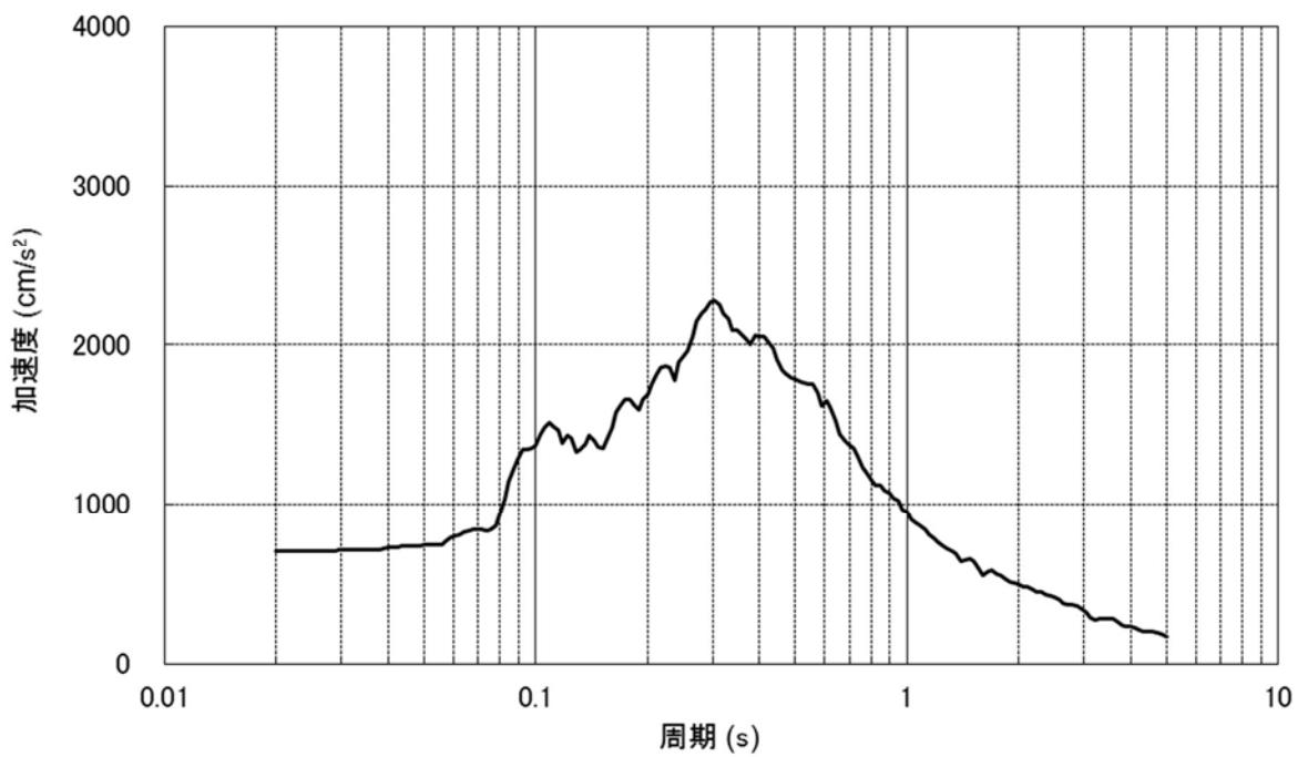
第5-1図 自由地盤地震動 ( $X_s$ ) の加速度応答スペクトル
