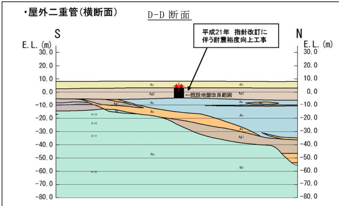
第 4 図 地質縦断面図及び横断面図
