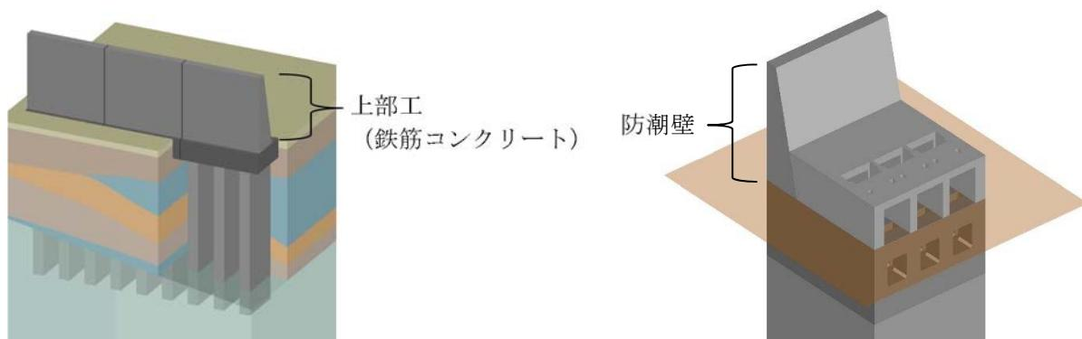
第3-4-6図 鉄筋コンクリート防潮壁の上部工
