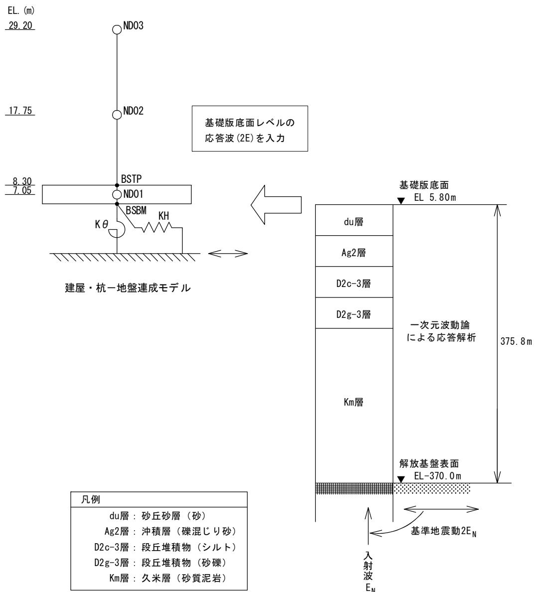
第2-1図 地震応答解析の概要図（既工認）
