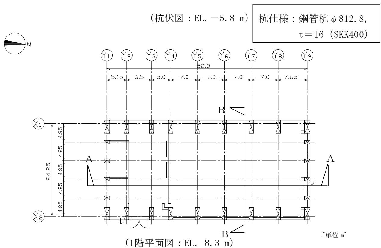
第2-2図 使用済燃料乾式貯蔵建屋の概要 (平面図)
