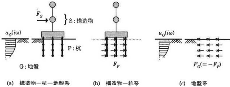
図 6.4.8 サブストラクチャー法による構造物一杭系と地盤系の分離
