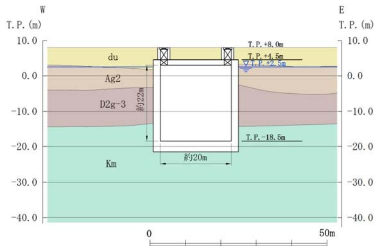
第 3-3-29 図 代替淡水貯槽 断面図（東西断面）
