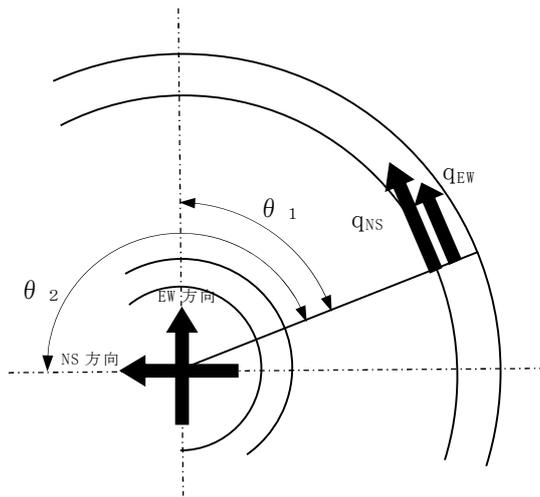
$$\begin{aligned} \text{NS 加振時水平力: } q_{\text{NS}} &= Q / \pi r \times \sin \theta_1 \\ \text{EW 加振時水平力: } q_{\text{EW}} &= Q / \pi r \times \sin \theta_2 \\ &= Q / \pi r \times \sin(\pi/2 + \theta_1) \\ &= Q / \pi r \times \cos \theta_1 \end{aligned}$$
