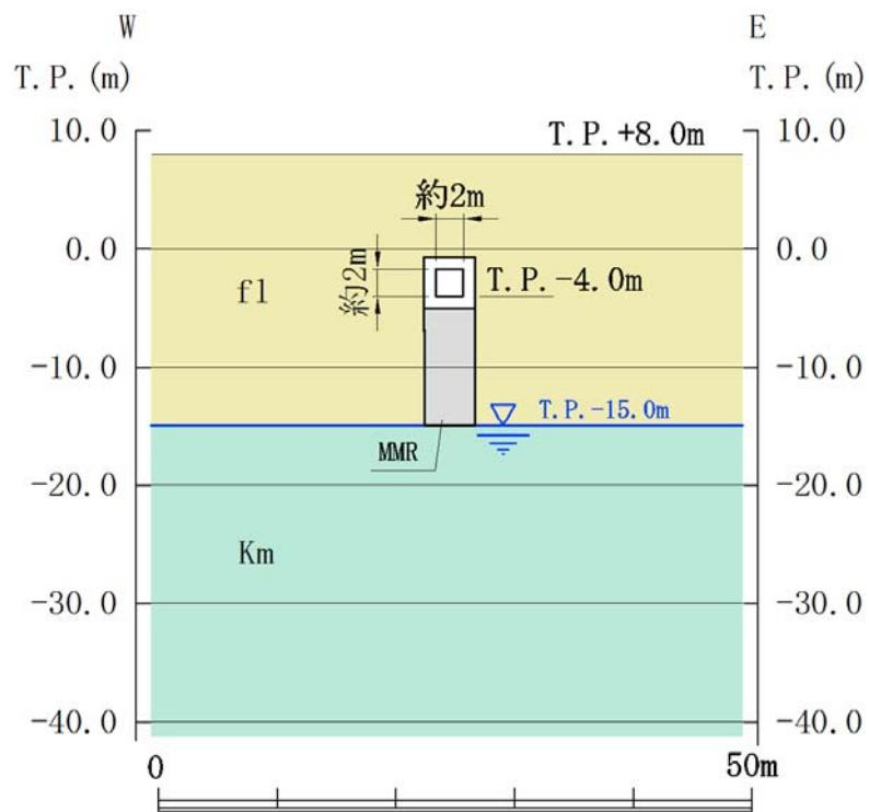
第 2.6-2 図 常設低圧代替注水系配管カルバート 断面図（東西断面）
