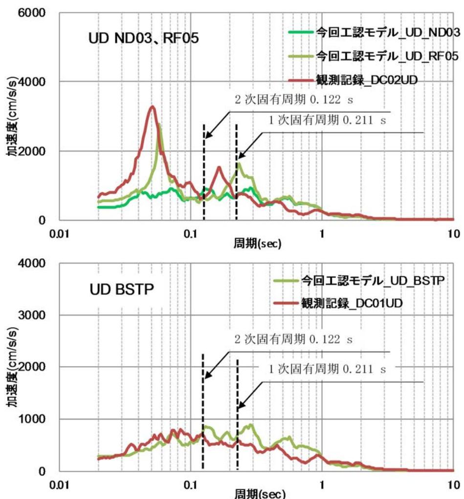
第2-4図 (3/3) 床応答スペクトルの比較 (上下方向,  $h = 5\%$ )
