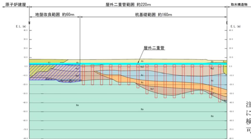
第 3-3-33 図 屋外二重管 縦断面図 (A-A 断面)
