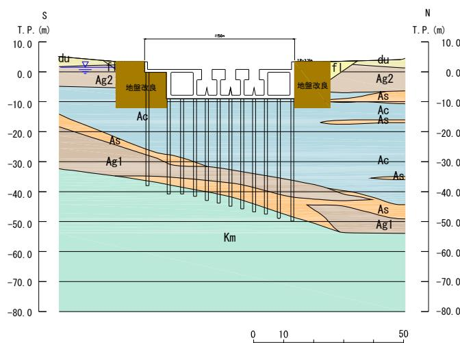
横断面図（B-B断面：取水ビット）
