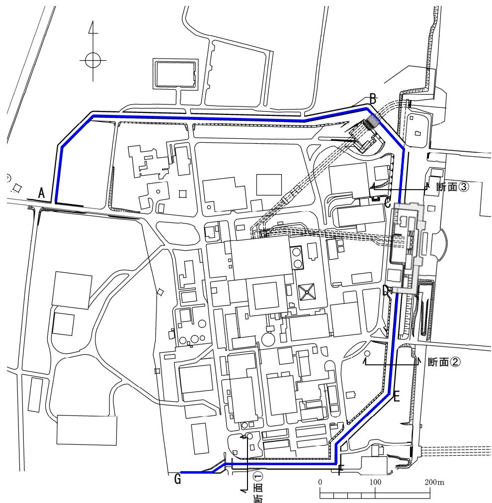
第1.5-2図 鋼管杭鉄筋コンクリート防潮壁 平面図
