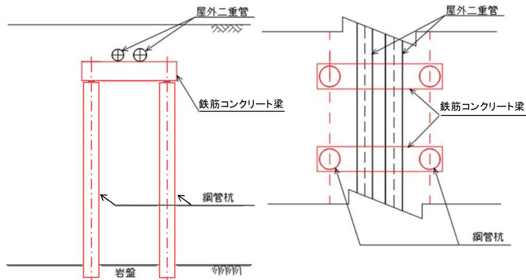
基礎構造図(管軸直交方向断面イメージ)
