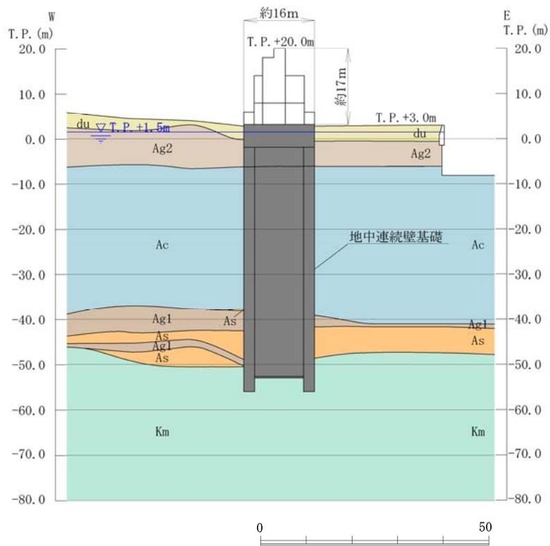
第 1.5-8 (2) 図 鋼製防護壁 断面図 (B-B 断面)
