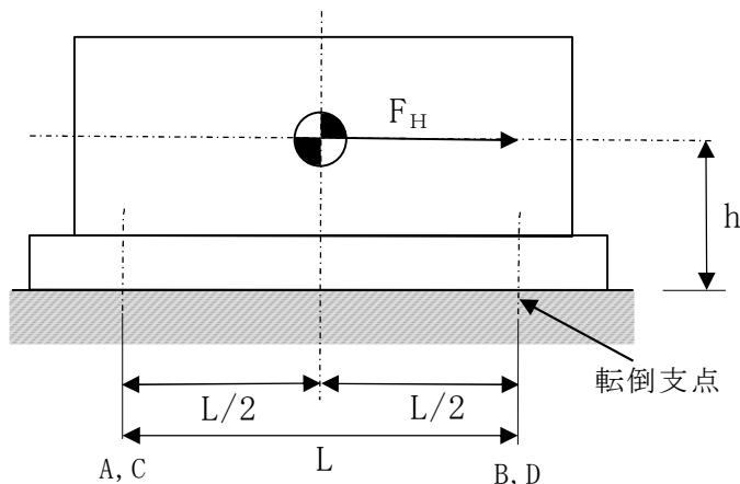
第 6-2 図 水平 1 方向の地震力による力
