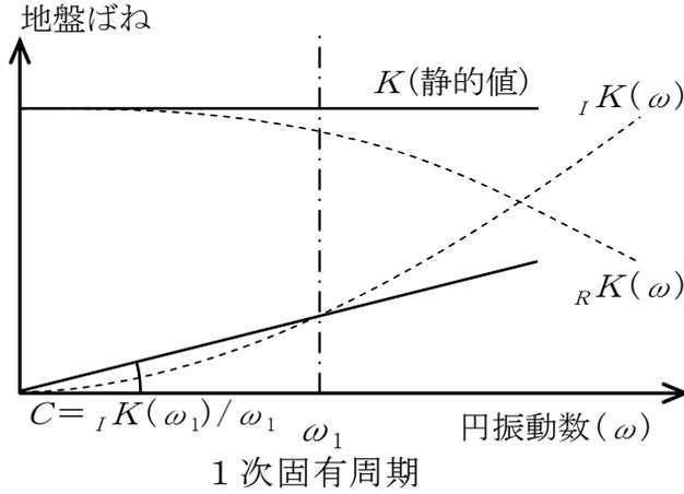
第3-4図 底面地盤ばねの近似法
