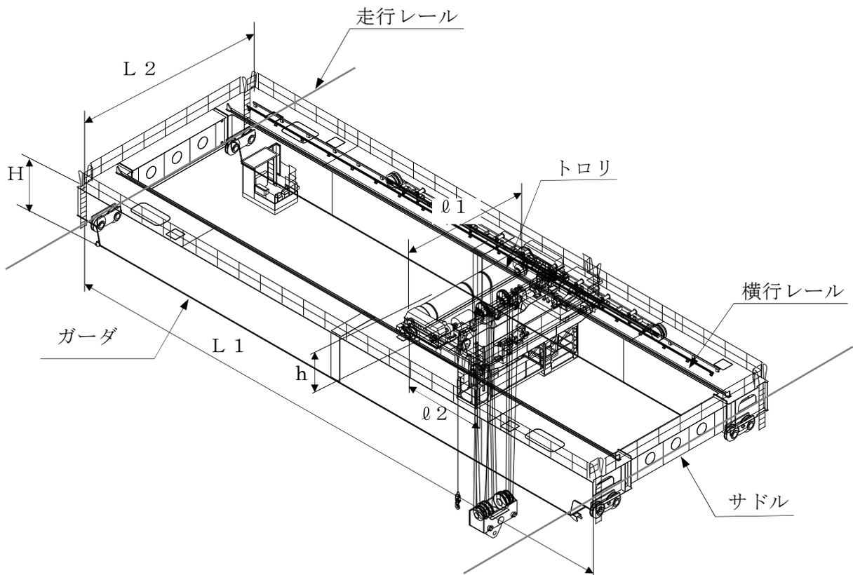
第2図 原子炉建屋クレーンの主要諸元及び構造概要図
