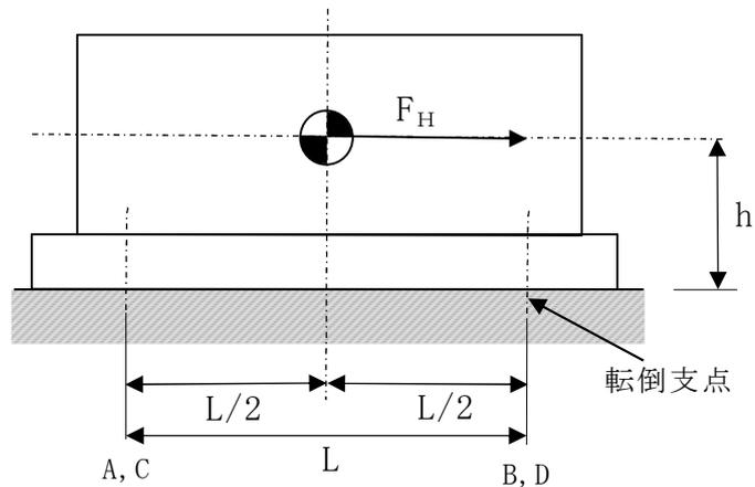
第 6-2 図 水平 1 方向の地震力による力
