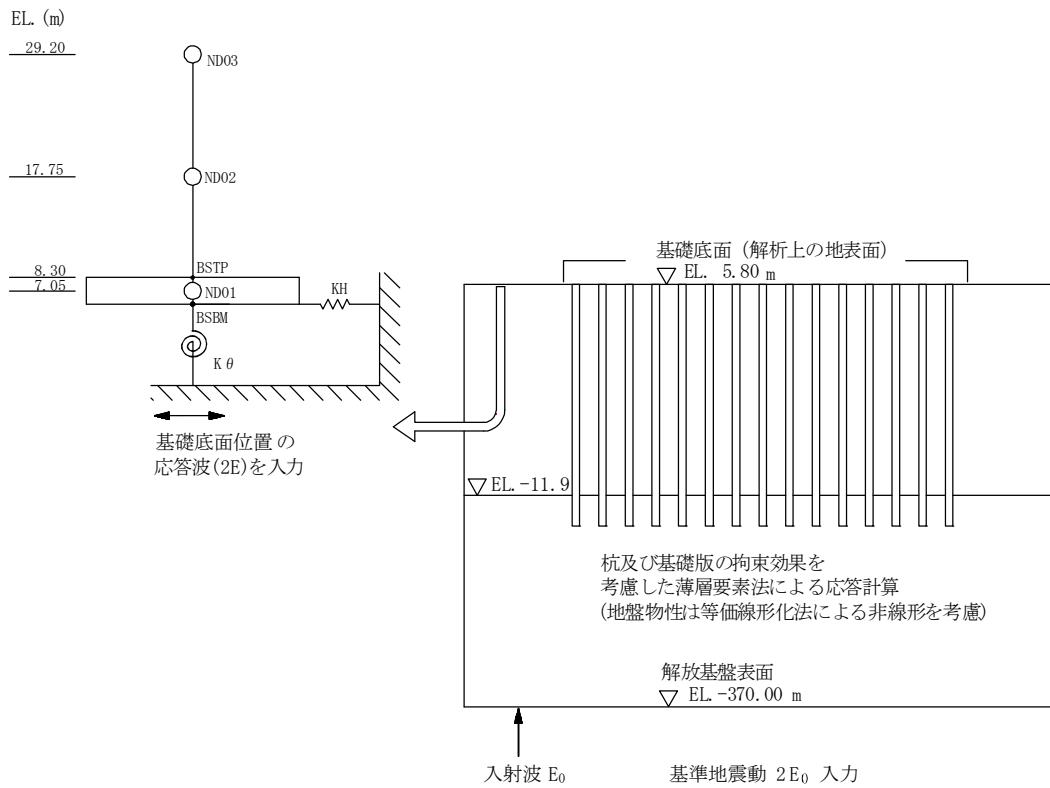
(水平方向 ※代表としてN S 方向断面を記載)
