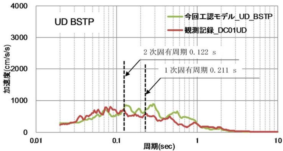
第2-4図 (3/3) 床応答スペクトルの比較 (上下方向, h = 5%)
