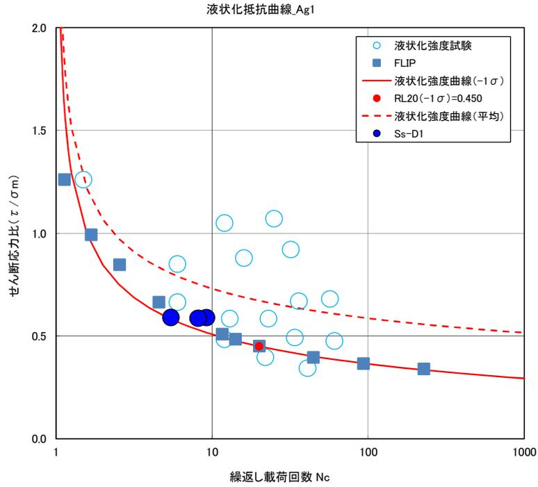
第 4.4.6 図 累積損傷度理論に基づく評価結果
