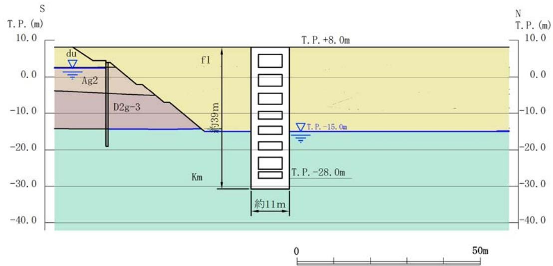
第 2.3-4 (2) 図 常設代替高圧電源装置用カルバート（立坑部）断面図
