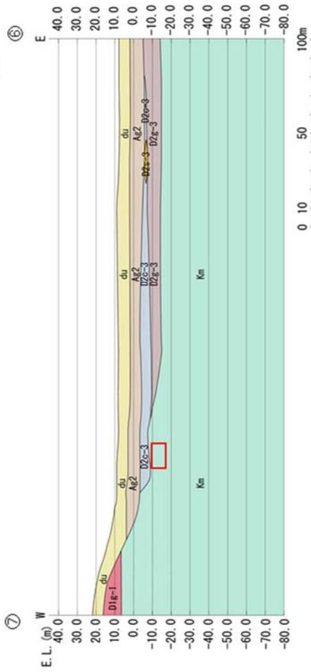
第 4.1.1.7 図 D2g-3 層の液状化強度試験試料採取位置
