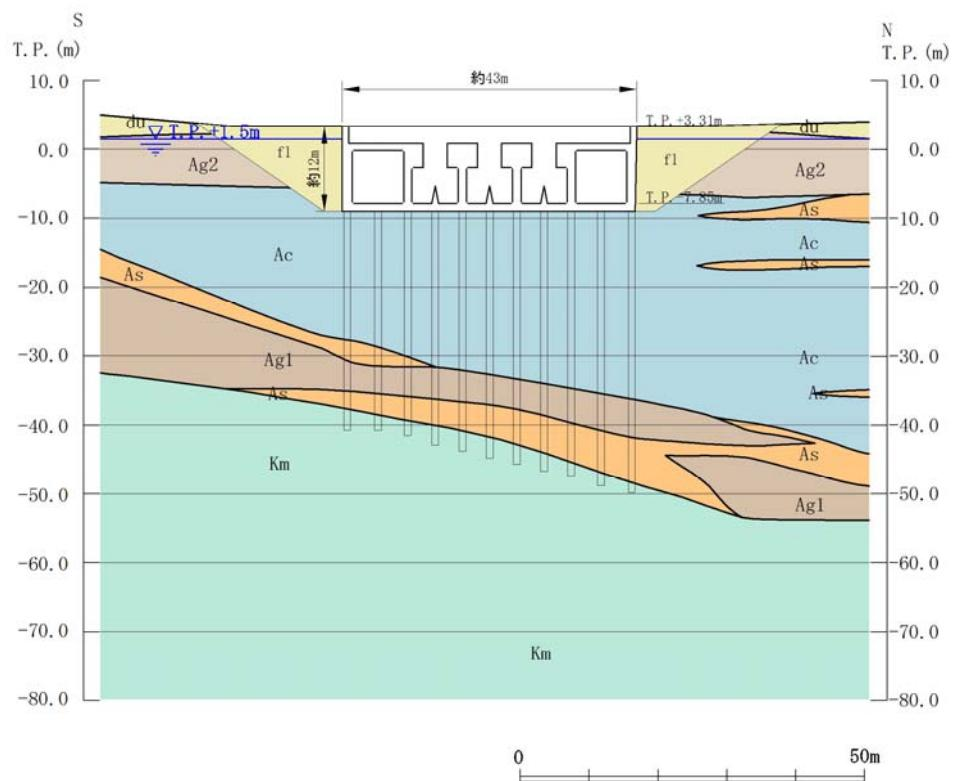
第 1.2-3 (2) 図 取水構造物 横断面図 (C-C 断面 : 取水ビット)
