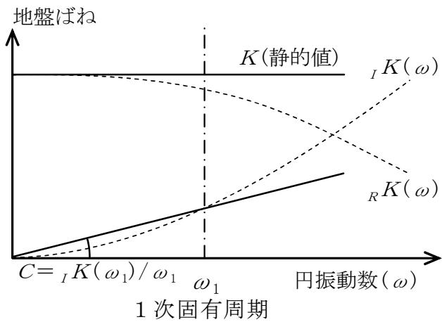
第3-4図 底面地盤ばねの近似法
