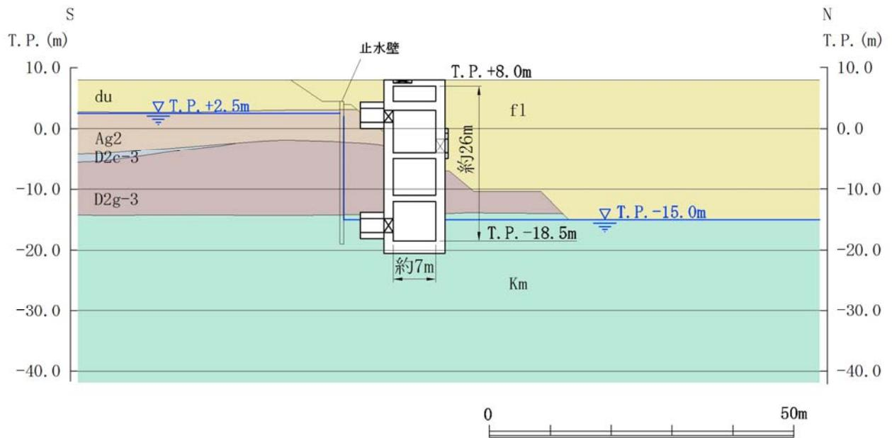
第 2.5-2 (2) 図 常設低压代替注水系ポンプ室 断面図 (南北断面)
