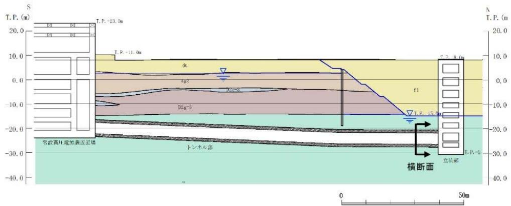
第3-3-6図 常設代替高圧電源装置用カルバート（トンネル部）
