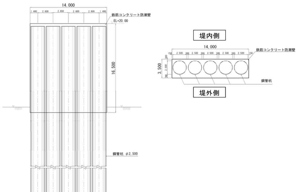
第 1.5-3 図 鋼管杭鉄筋コンクリート防潮壁 正面図及び断面図
