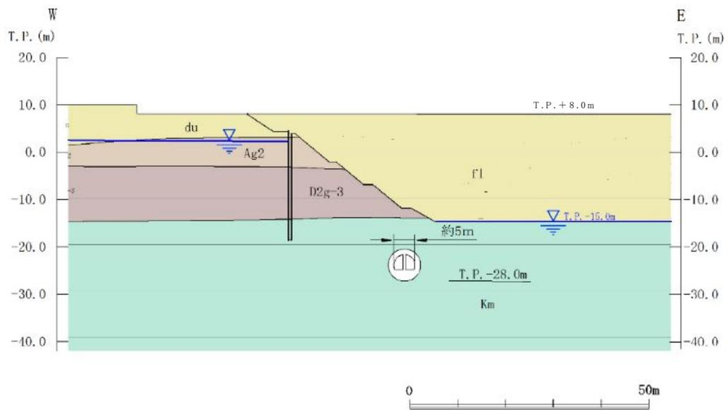
第 3-3-7 図 常設代替高圧電源装置用カルバート（トンネル部）
