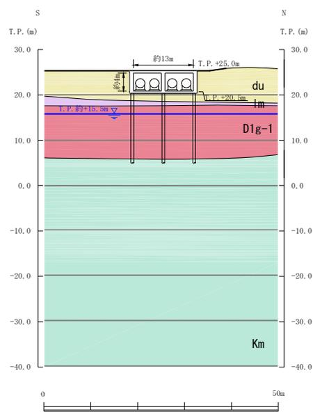
第 3-3-28 図 可搬型設備用軽油タンク基礎断面図【南側】
