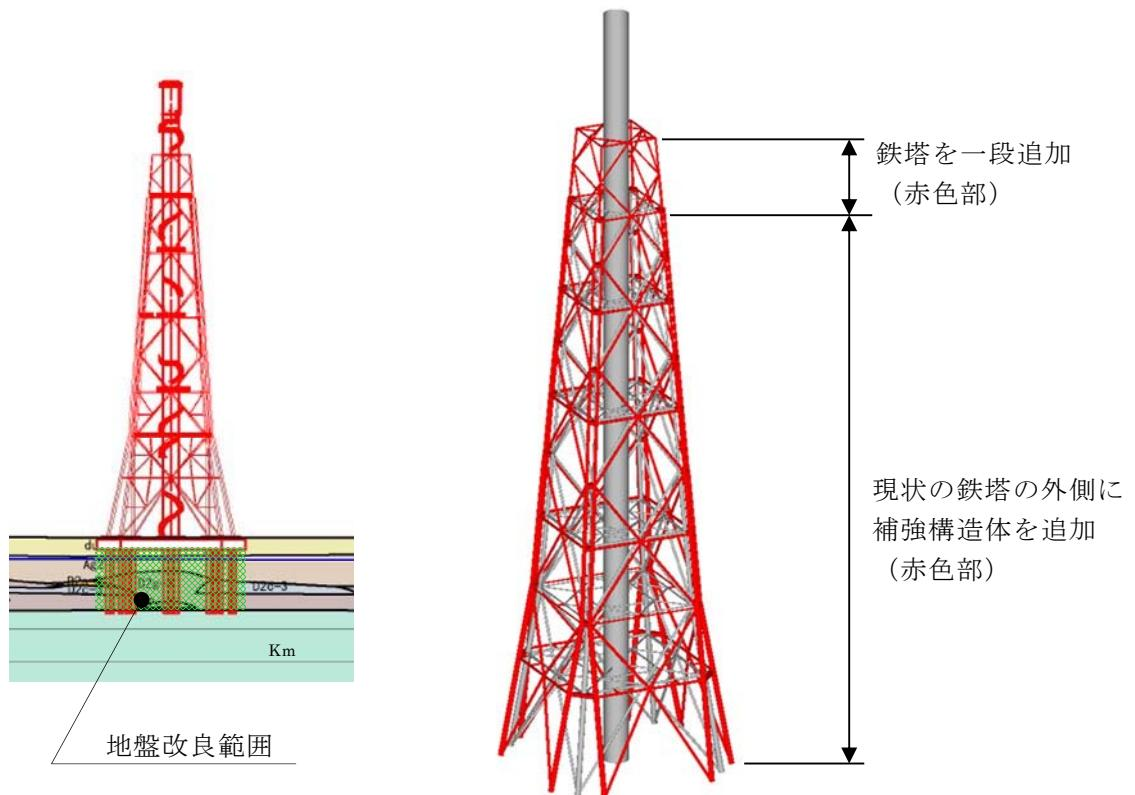
第1図 排気筒の耐震補強概要図
