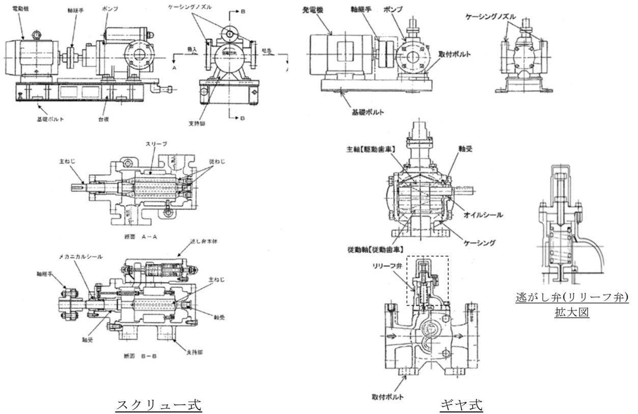
第3図 スクリュー式，ギヤ式ポンプ構造概要図
