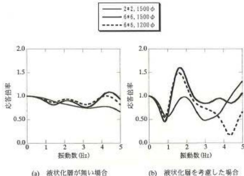
図 6.4.1 自由地表面の応答に対する杭基礎の基礎入力動の比
