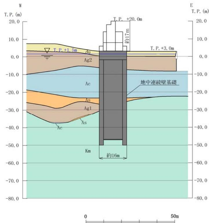
第1.5-8(2)図 鋼製防護壁 断面図 (C-C断面)
