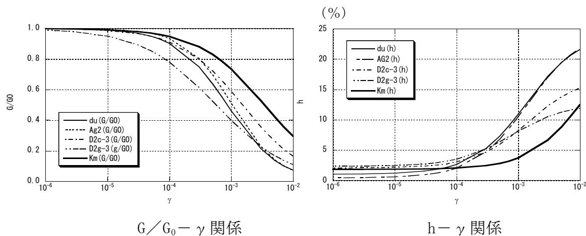
第3-8図 使用済燃料乾式貯蔵建屋 地盤の非線形特性
