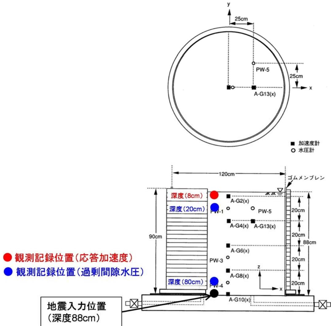
第 9.2.1 図 土槽振動実験装置の概要
