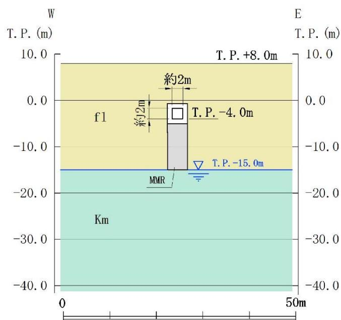
第3-3-13図 常設低圧代替注水系配管カルバート
