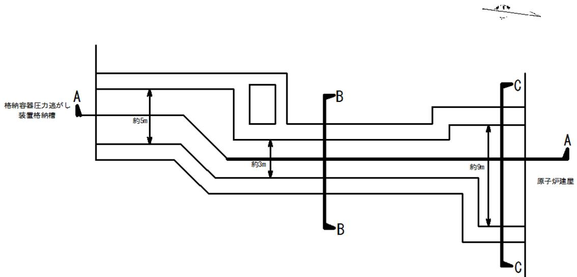
第 2.8-1 図 格納容器圧力逃がし装置用配管カルバート 平面図
