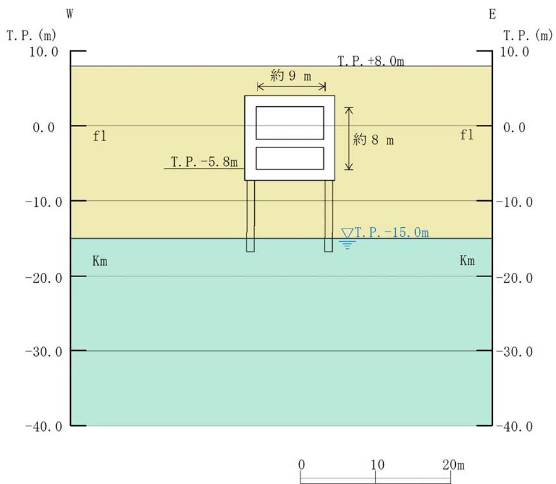
第 2.8-3 (2) 図 格納容器圧力逃がし装置用配管カルバート 断面図
