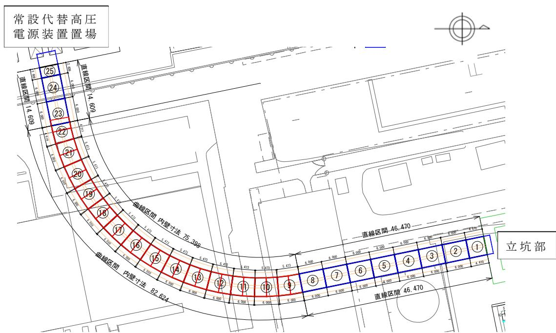
第3-3-8図 常設代替高圧電源装置用カルバート（トンネル部）
