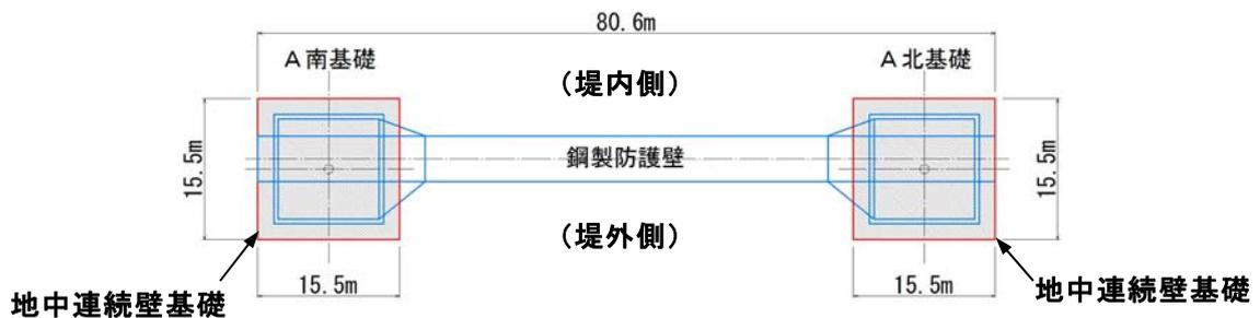
第 1-22 図 鋼製防護壁 平面図
