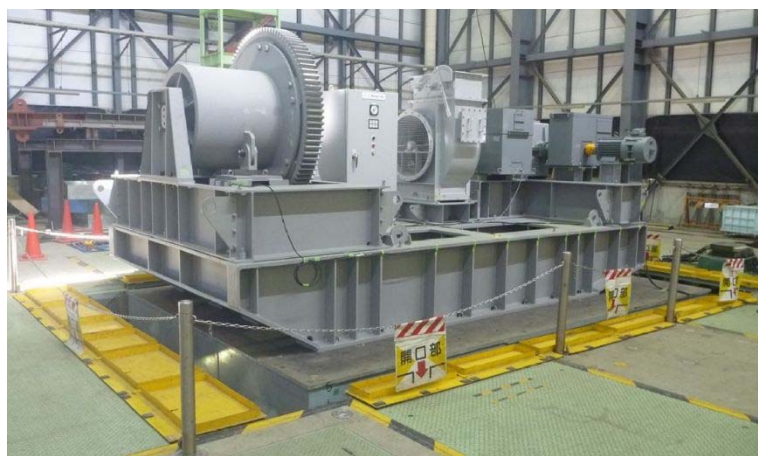
第8図 開閉装置の試験装置（全景）
