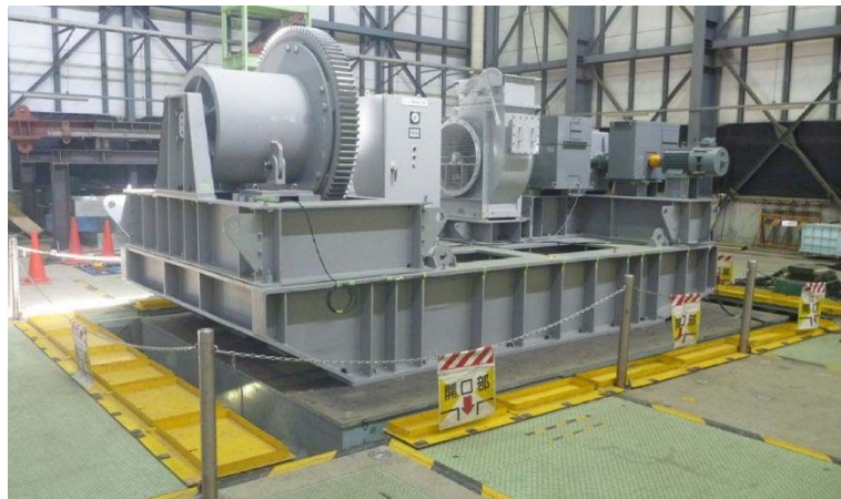
第10図 開閉装置の試験装置（全景）
