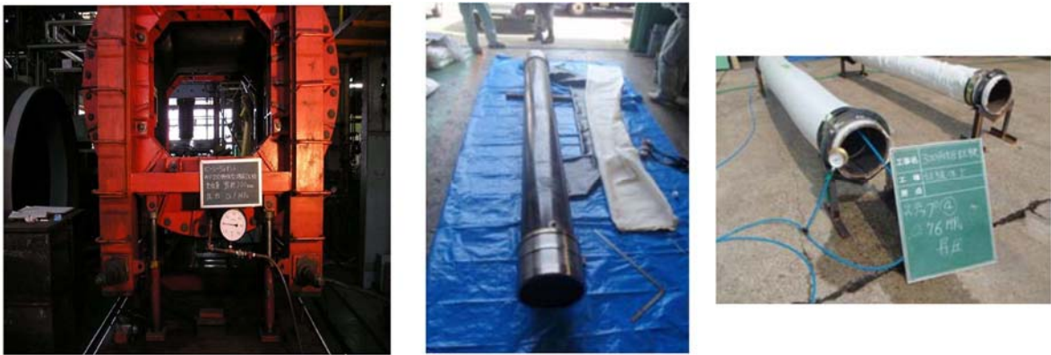
第1-26図 止水ゴム等の耐圧試験例
