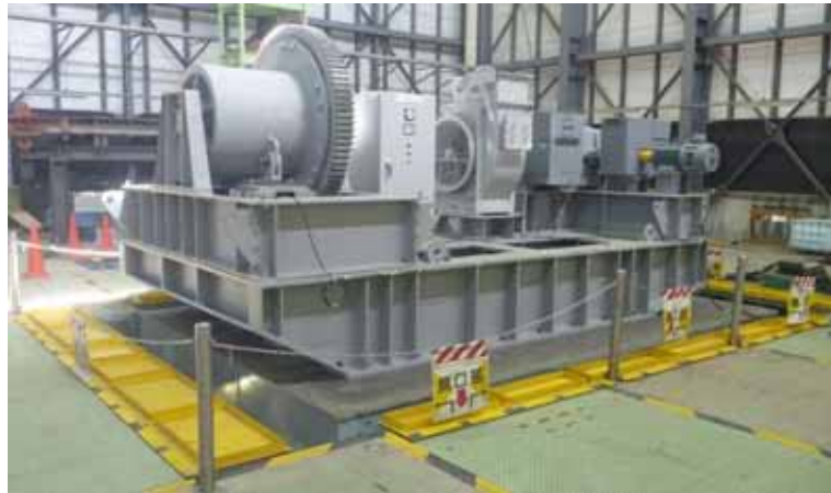
第10図 開閉装置の試験装置（全景）
