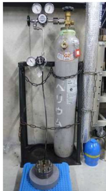
第 13 図 H e 気密確認試験状況
