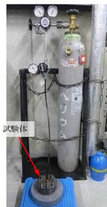
第5図 H e 気密確認試験状況
