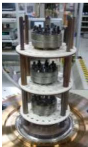
第4図 蒸気曝露 試験片設置状況
