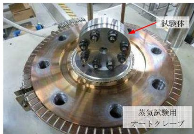
第4図 蒸気曝露試験体設置状況
