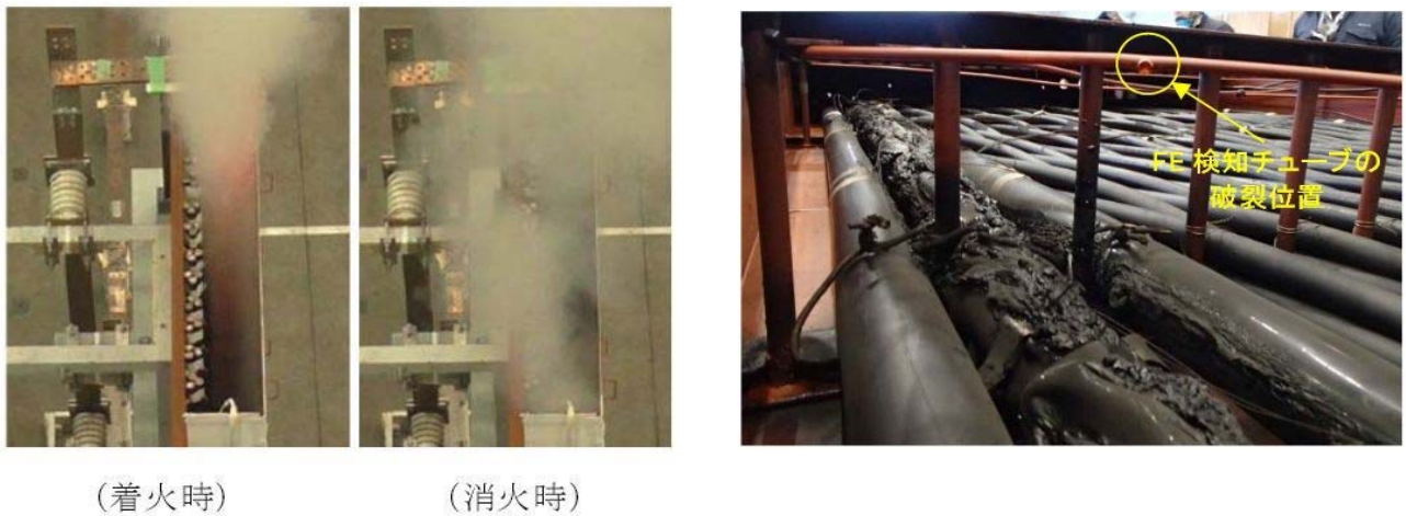
第 11 図 試験 V2 発火・消火・試験後の状態
