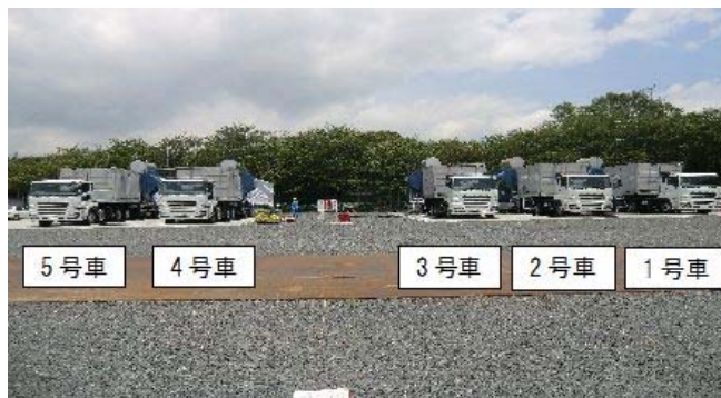
常設代替高圧電源装置（イメージ）
