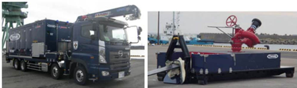
図4 可搬型代替注水大型ポンプ（放水用）、放水砲
