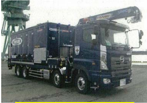
可搬型代替注水大型ポンプ
