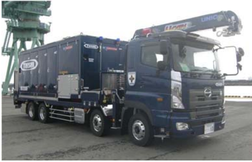
可搬型代替注水大型ポンプ（放水用）
