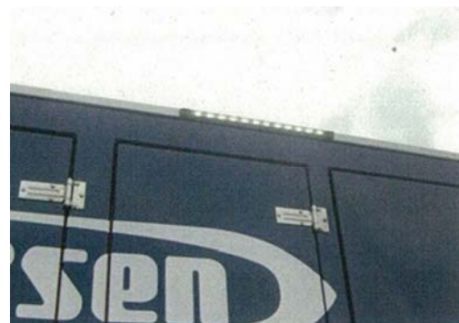
車両の作業用照明
