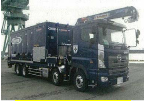
可搬型代替注水大型ポンプ
