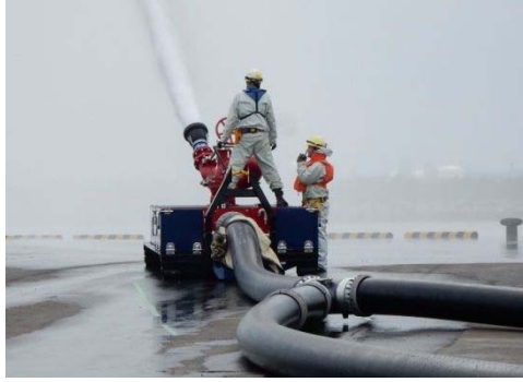
放水砲による放水（直状放射）
