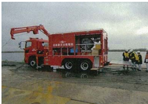
可搬型代替注水中型ポンプ
