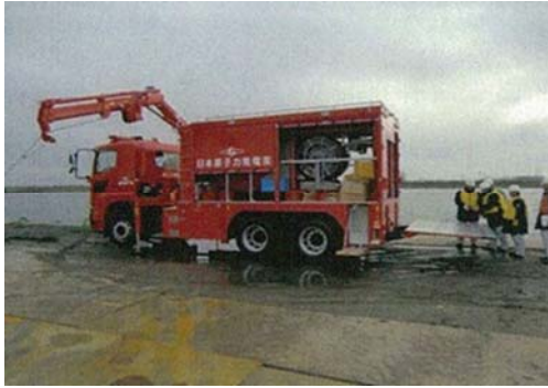
可搬型代替注水中型ポンプ
