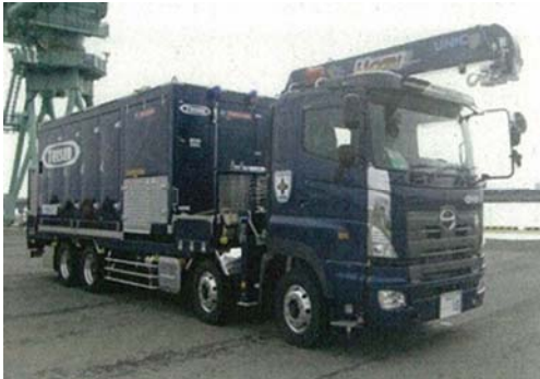
可搬型代替注水大型ポンプ
