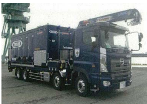
可搬型代替注水大型ポンプ
