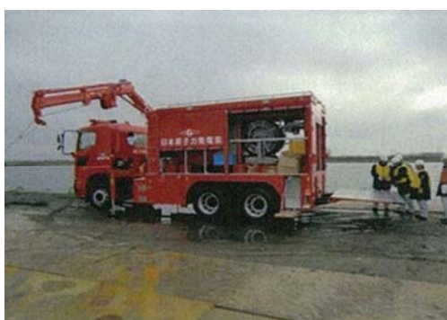
可搬型代替注水中型ポンプ
