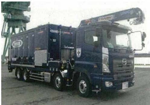
可搬型代替注水大型ポンプ
