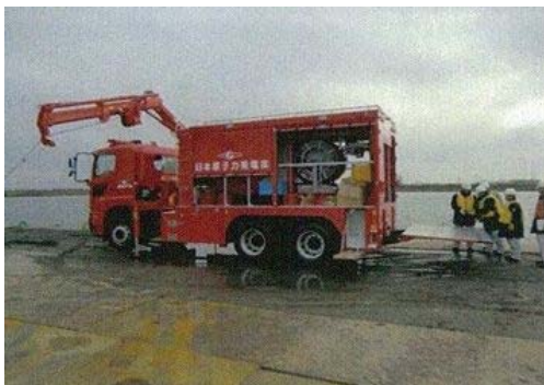
可搬型代替注水中型ポンプ
