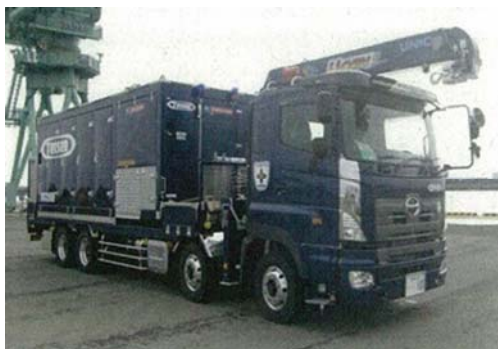
可搬型代替注水大型ポンプ
