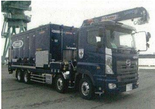
可搬型代替注水大型ポンプ
