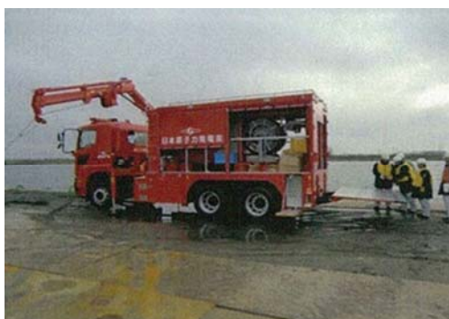
可搬型代替注水中型ポンプ
