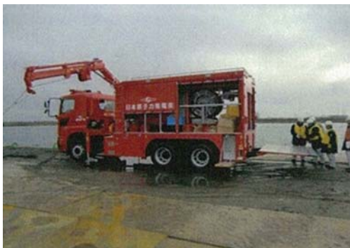
可搬型代替注水中型ポンプ
