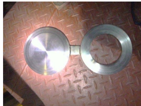
連絡配管閉止フランジ
