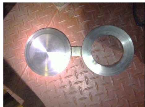
連絡配管閉止フランジ
