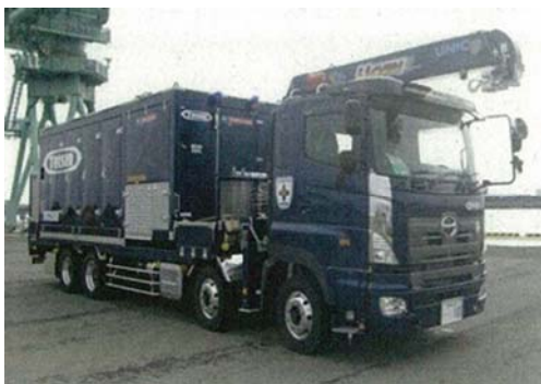
可搬型代替注水大型ポンプ
