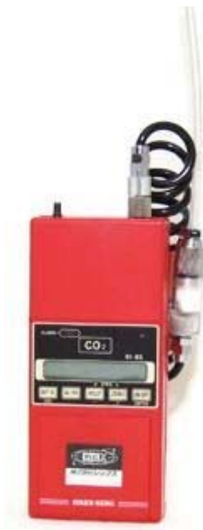
第 61-5-11 図 二酸化炭素濃度計の概略図
