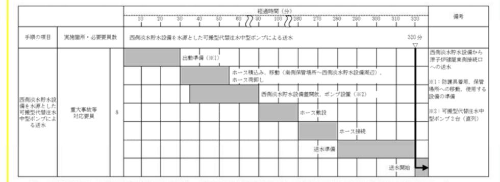
【ホース敷設にホース運搬車を使用する場合、原子炉建屋東側接続口への送水開始まで195分以内と想定する。】
