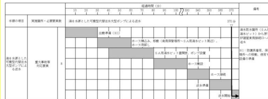
【ホース敷設にホース運搬車を使用する場合、原子炉建屋東側接続口への送水開始まで135分以内と想定する。】
